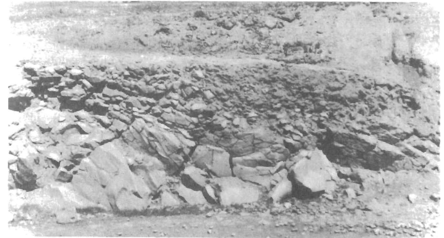
Р и с. 20. Трещиноватость в зоне выветривания базальтов, высота обнажения 8 м. Долина р. Орхона (МНР)
