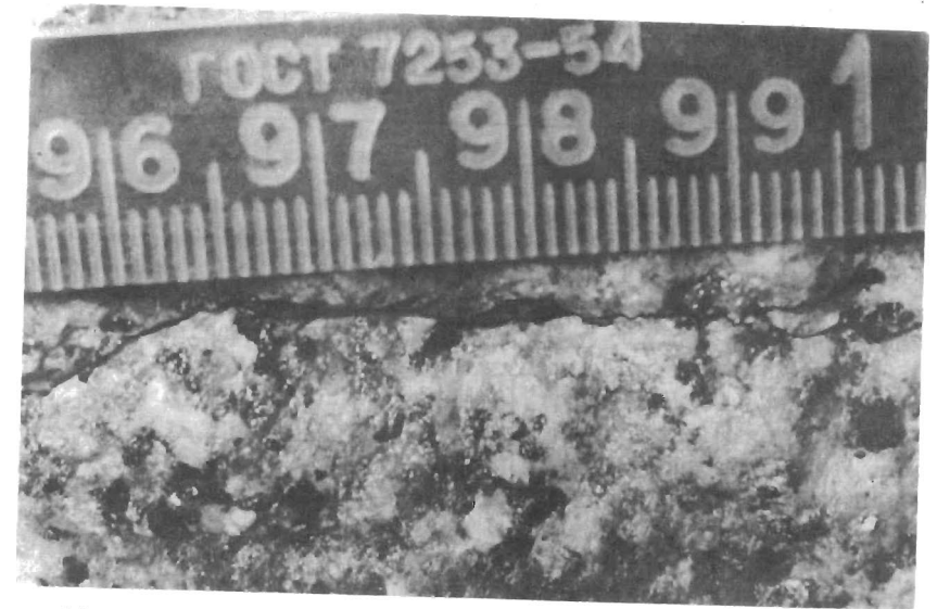
Р и с. 23. Открытая трещина отрыва в граните основания Колымской ГЭС. Деления на линейке через 1 мм
