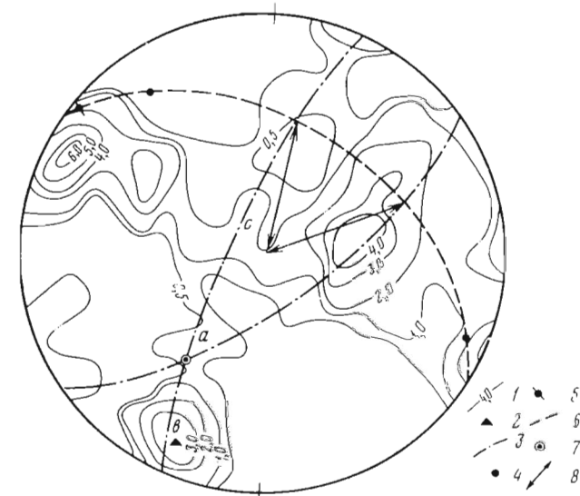
Р и с. 72. Определение положения плоскости разрыва и направления смещения для одного из участков шахтного поля Дарегор (600 пар измерений угла и азимута падения трещин)
