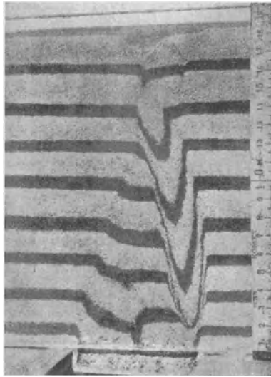
Abb. 2. Druckversuche in Sand nach Fiebinger.
