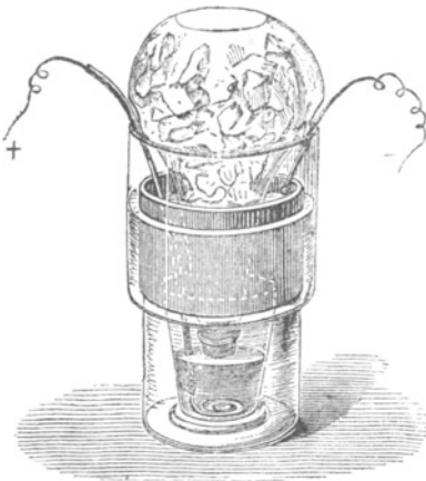
Das Meibinger'sche Element mit der Sturzflasche.
