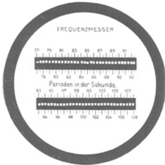
Abb. 313a. Zungenfrequenzmesser. W. R. POHL: Einführung in die Mechanik und Akustik, 1. Aufl.
