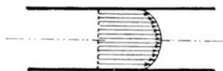
Abb. 51. Geschwindigkeitsverteilung der turbulenten Strömung im Rohr. Die Bewegung der Flüssigkeitsteilchen ist in allen Teilen des Querschnittes nahezu gleich. (Nach PRANDTL.)
