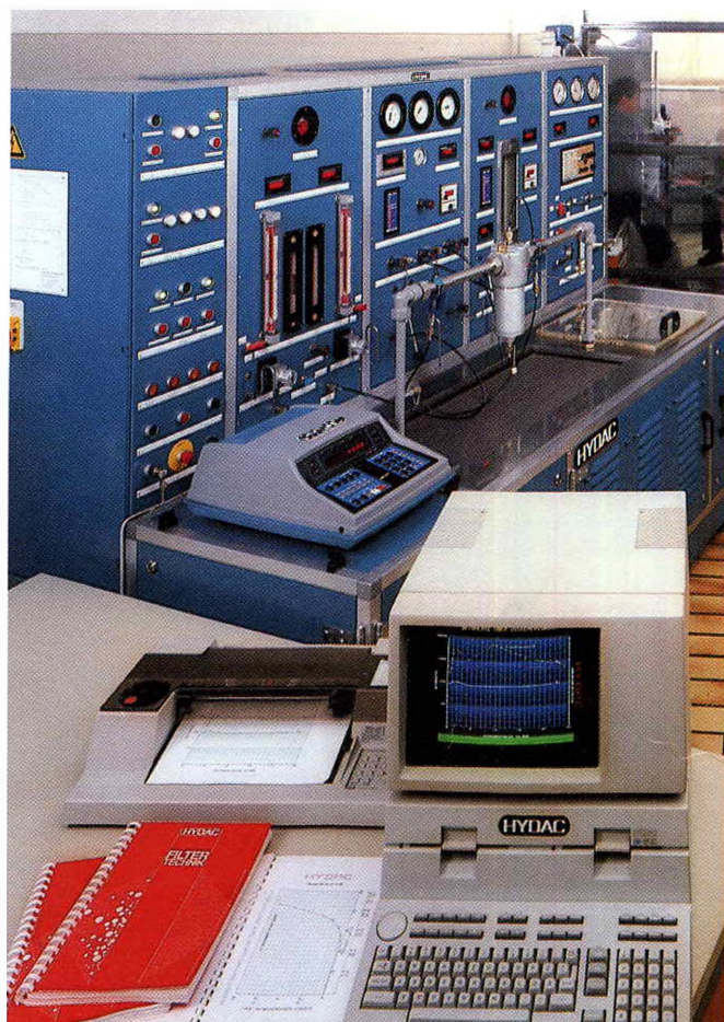
Рис. 7: Multipas - испытание согласно стандарту ISO 4572
