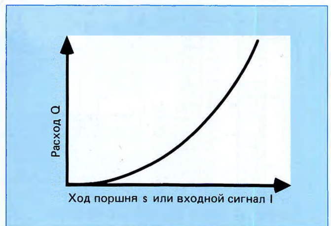
Рис. 9: Графическая характеристика Q-h или графическая характеристика Q-I
