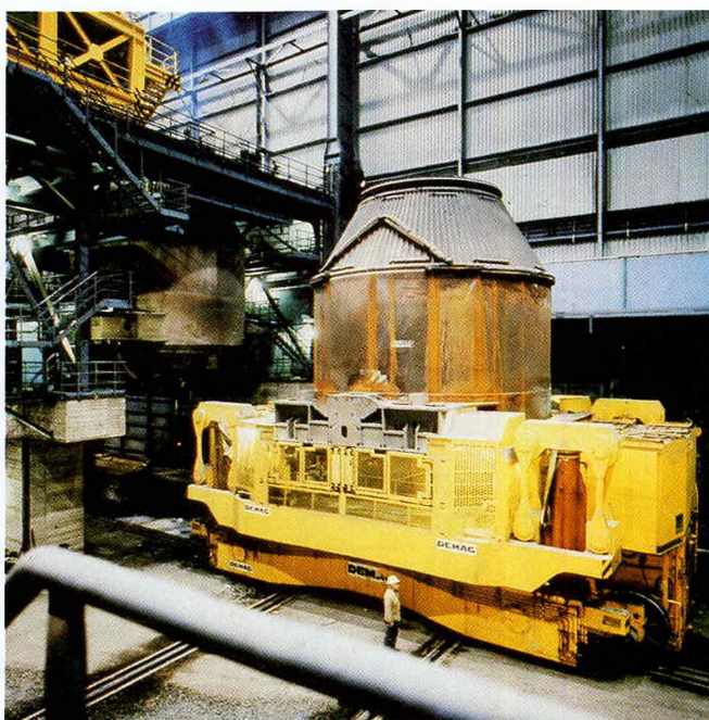
Вагонетка для смены цистерн устанавливается на позицию через пересечение рельсовых путей
