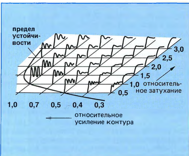
Рис. 4: Временная характеристика контура регулирования 3-го порядка
