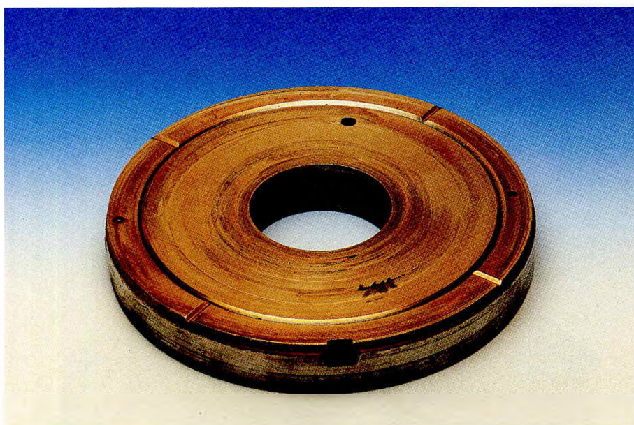
Рис. 245. Дефекты на диске крышки пластинчатого насоса в результате действия кавитации, обусловленной занижением давления на приёме насоса.
