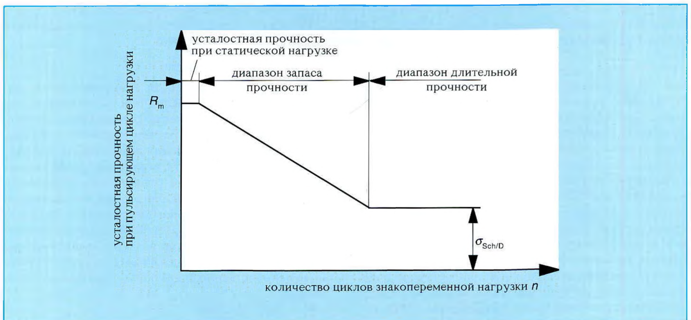
Диаграмма 55. График Вёлера, схематическое изображение
