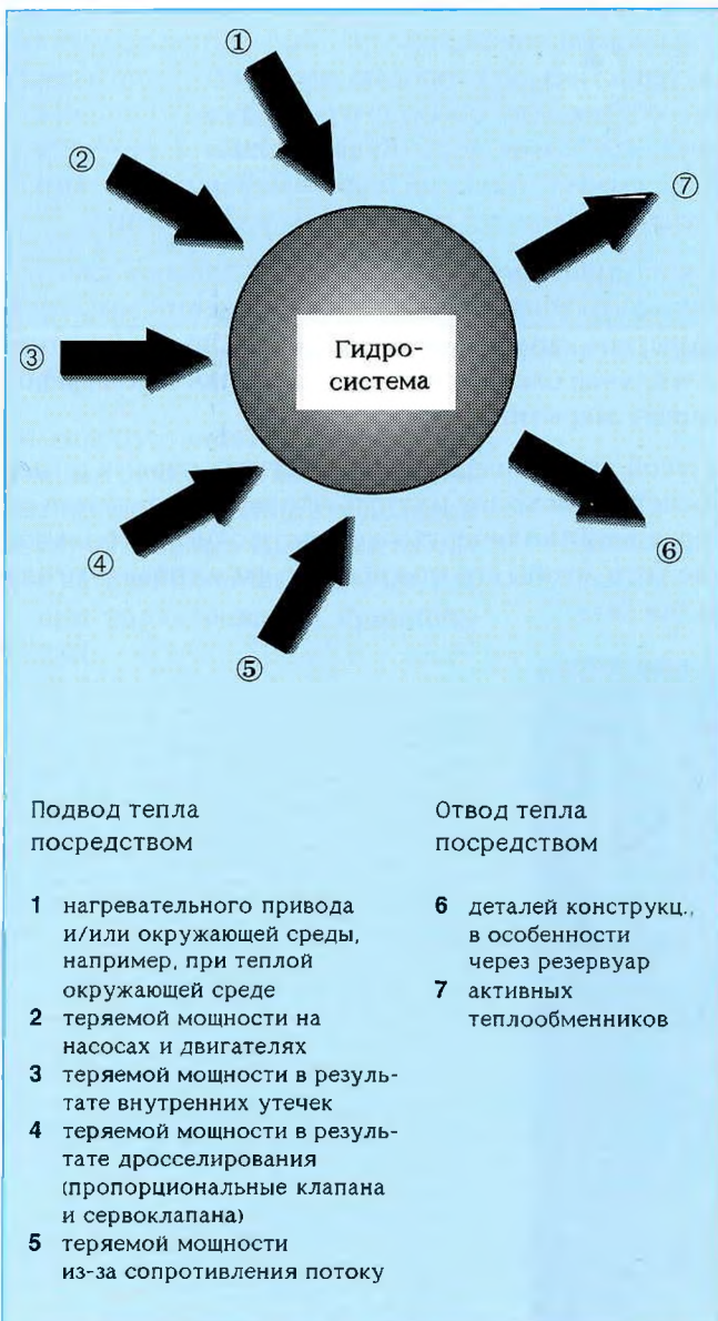
Рис. 31: Тепловой баланс для гидросистем
