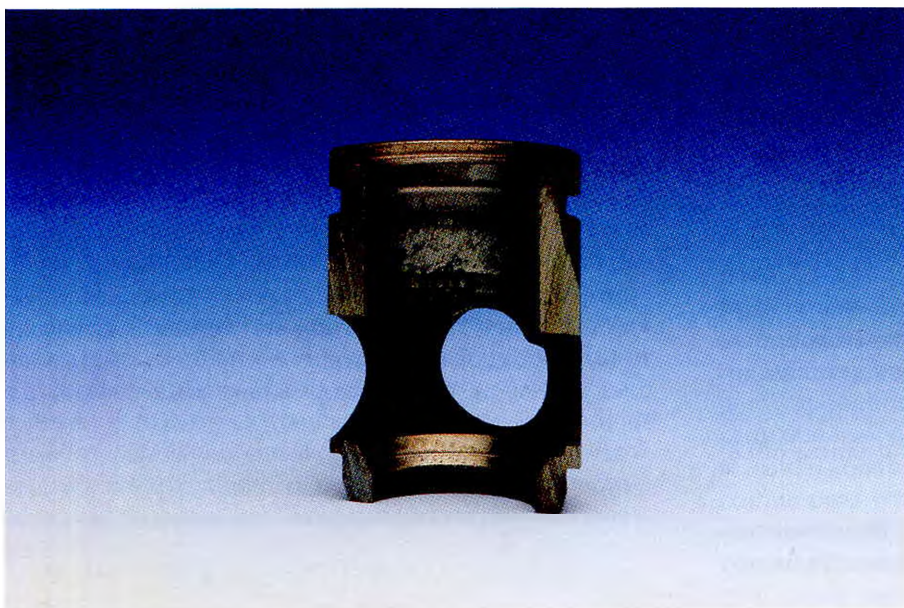
Рис. 238: Места коррозии на поверхности контакта поршня и гильзы ограничительного клапана с пилотным управлением Причина: Действие колебаний высокой частоты и малой амплитуды.
