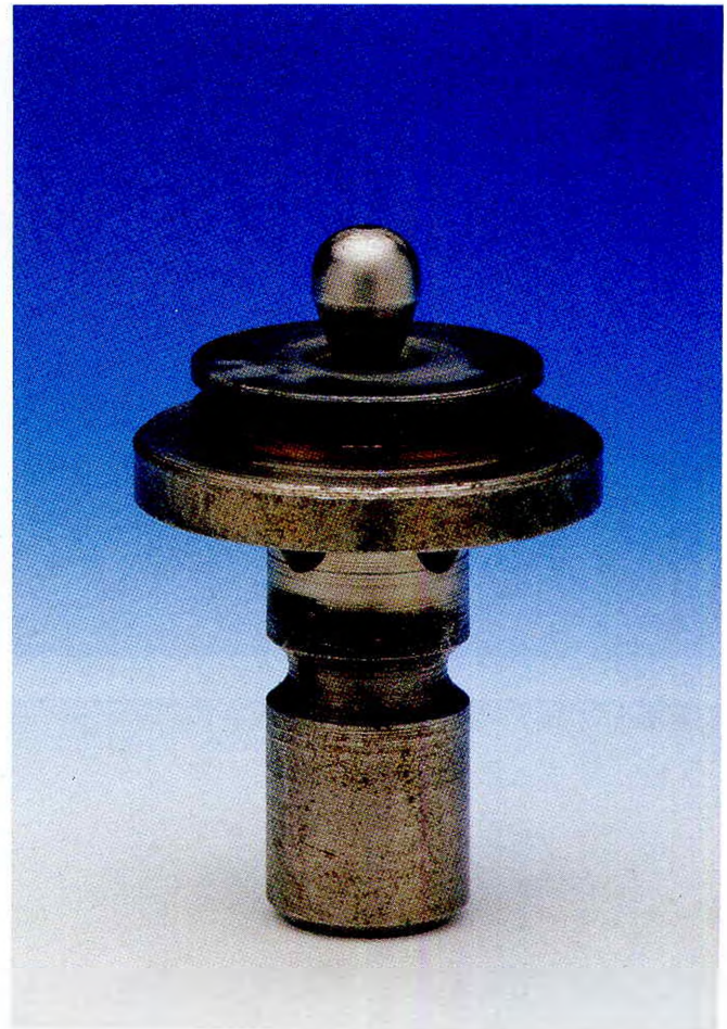
Рис. 241: Нормальный износ затвора ограничительного клапана прямого управления, работавшего в условиях высокой частоты срабатывания в течение продолжительного времени.
