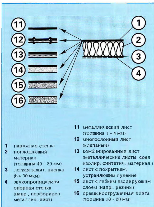
Рис. 153. Устройство однослойной стенки кожуха
