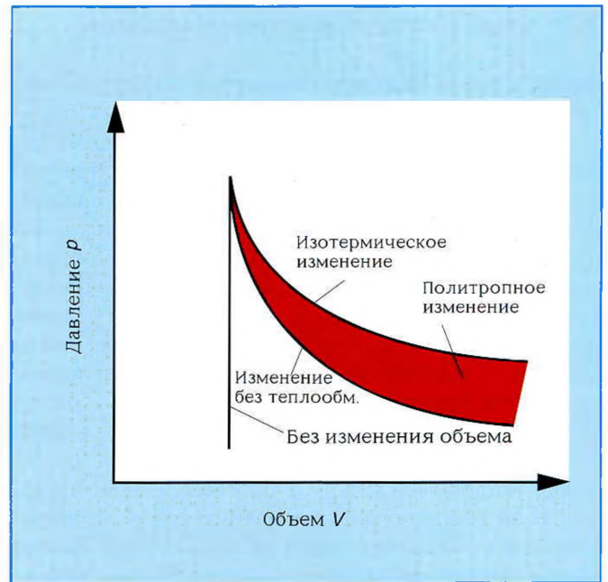
Диаграмма 20: Изменение состояния на диаграмме зависимости давления p от объема V
