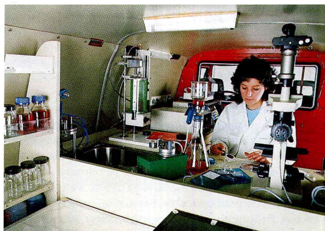
Рис. 93: Передвижная лаборатория для измерения на месте
