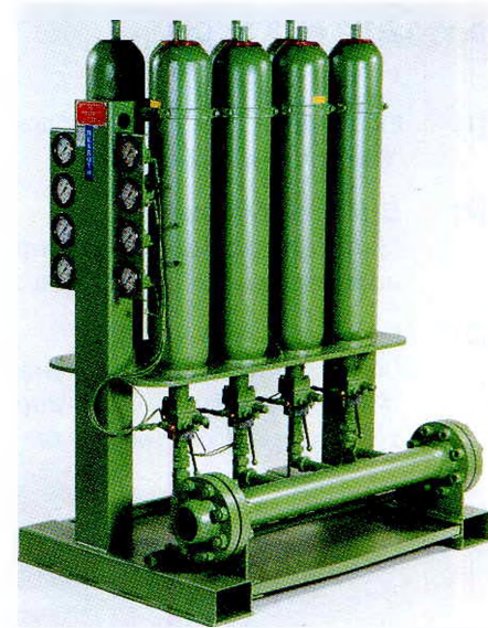
Рис. 130 (справа): Двухрядный аккумуляторный блок, усиленное исполнение
