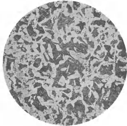
Eisen mit 0,5% Kohlenstoff. V = 135 .
