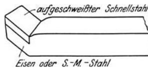
Fig. 139. Aufschiweißen von Schnellstahl auf Eisen oder S.-M.-Stahl.
