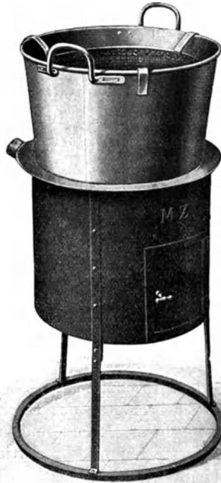
Fig. 120. Behälter zum Härten von Schnellstählen in heißem Falz.
