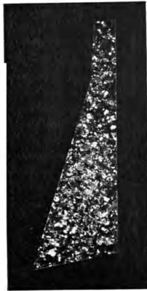
Fig. 144. Bruchfläche der Spitze eines überhitzten Drehmessers
