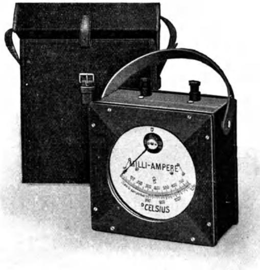
Fig. 108. Tragbarer Strommesser zum optischen Pyrometer.
