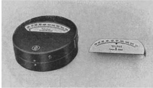
Fig. 109. Doseninstrument in Ledertasche zum optischen Pyrometer.
