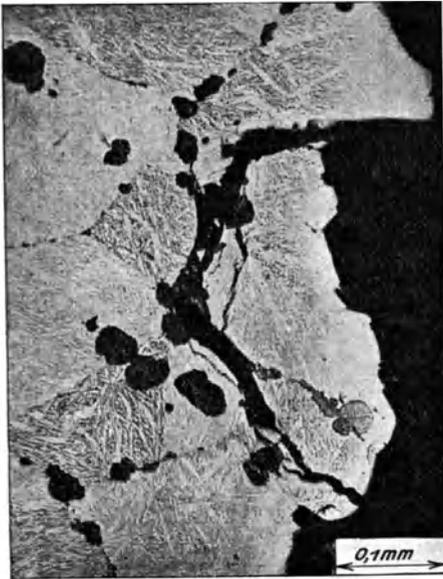
Fig. 143. Gefüge an Rand und Mitte des in Fig. 150 abgebildeten verbrannten Stückes der Härteschlange. (Aus Bach-Baumann, Gefügebilder.) Vergrößerung = 150.
