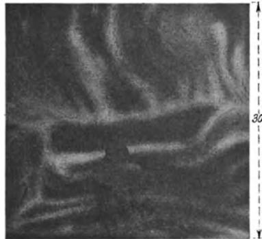
Fig. 49. Schweißstahl (Gärbstahl).
