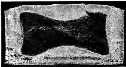
Fig. 7. Bruchquerschnitt eines schwarzbrüchigen Werkzeugstahles.  $\frac{2}{3}$  nat. Gr. (Aus Goerens, Metallographie.)
