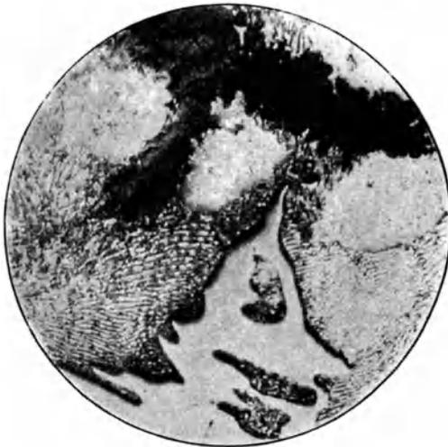
Fig. 2. Der glatte weiße erhabene Teil ist Eisenkarbid (sog. Cementit), der glatte vertiefte weiße Teil ist kohlenstoffreies Eisen (Ferrit), der schwarze ist Temperkohle. Vergrößerung = 500.
