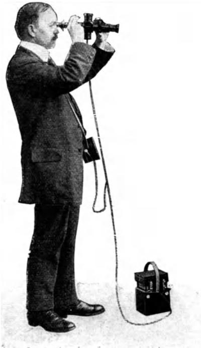
Fig. 110. Anwendungsweise des optischen Pyrometers.
