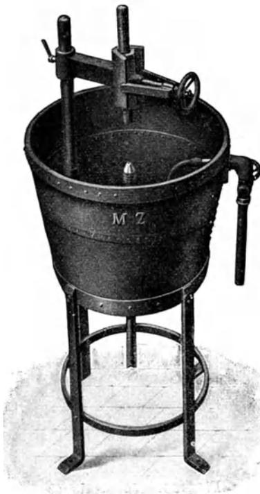
Fig. 117. Wasserstrahlvorrichtung zum Härten von Döppern.
