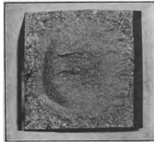
Fig. 158. Grobkorniger Bruch an Kanten und Ecken eines eingesetzten Stahles; es wurde zu hohe Glühtemperatur angewendet. (Aus Brearley-Schäfer.)
