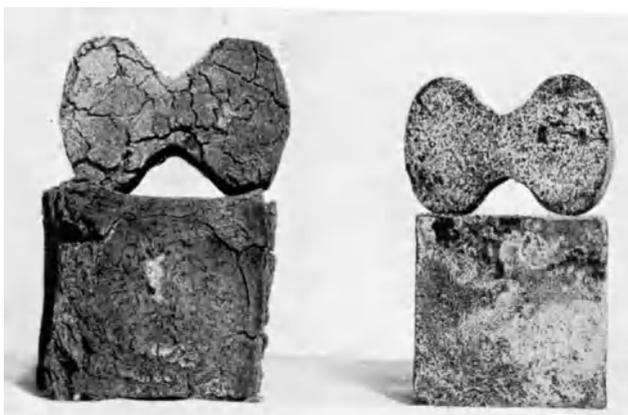
Abb. 48. Portlandzementnormenkörper mit (rechts) und ohne (links) Flugstaubzusatz nach einjähriger Lagerung in 15%iger Natriumsulfatlösung.
