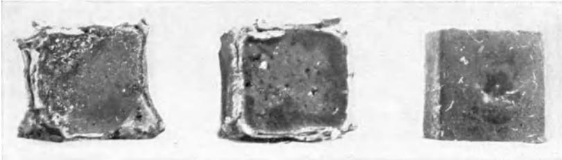
Abb. 44. Zementwürfel aus gewöhnlichem Portlandzement (links), hochwertigem Portlandzement (Mitte) und Tonerdezement (rechts) nach 60tägiger Lagerung in 15%iger Ammonsulfatlösung.
