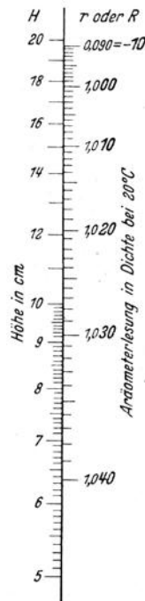
Abb. 170. Beispiel der Umrechnung eines Aräometers für die Aräometeranalyse nach CASAGRANDE (s. Abb. 171).
