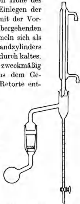
Abb. 7. Wasserbestimmungsapparat nach PRJANTSCHIKOFF in der Ausführung von Schott & Genossen, Jena.
