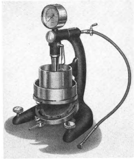
Abb. 62. Fasergruppierungsapparat H. S. für Holzschliff. Ansicht. Das Bild zeigt eine neuere Bauart, die von der der Abb. 63 etwas abweicht, ohne daß dadurch doch in der Arbeitsweise des Gerätes sich etwas ändert.
