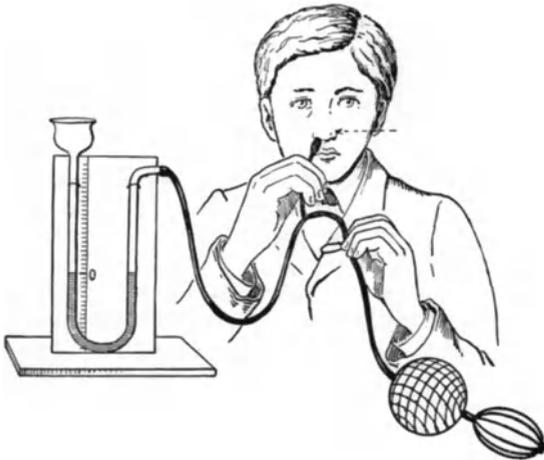
Abb. 24. Apparat zur Messung der Stärke des Gaumensegelverschlusses.
