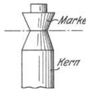
Abb. 95. Prüfung der Konizität des Kerns.
