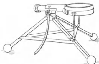
Abb. 5. Schüttelsieb mit Preßluftantrieb.
