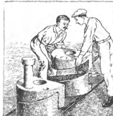
Abb. 1017. Ausschließlich aus Kernen bestehende Form für Manganstahl-Förderwerksflügel.
