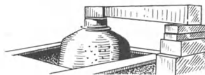
Abb. 998. Gießfertige, eingestampfte Glockenform.
