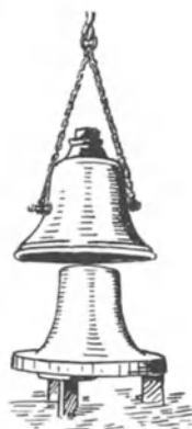
Abb. 997. Zusammensetzen einer Glockenform.
