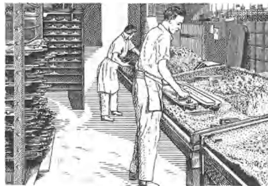
Abb. 589. Kernmacherei für Heizkörper.
