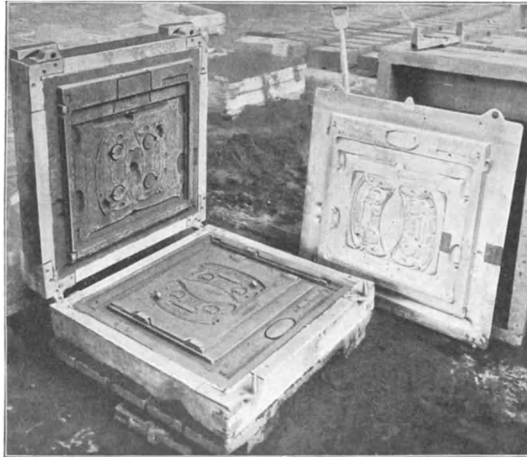
Abb. 1059. Aufgeklappter Formkasten mit ausgehobener Formplatte.
