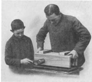
Abb. 1459. Abheben des Kernkastens von Hand.
