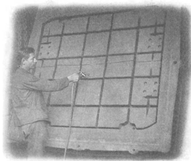
Abb. 1558. Abblasen einer Form mittels Preßluft-Abbläfers.
