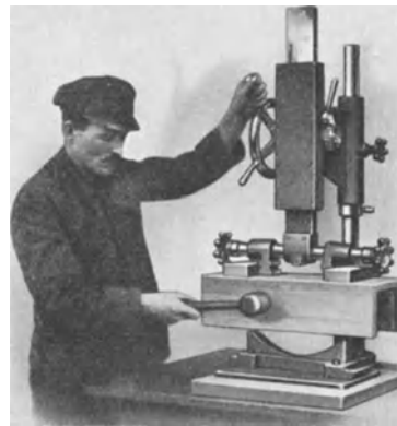
Abb. 1460. Abheben des Kernkastens mit Maschine.
