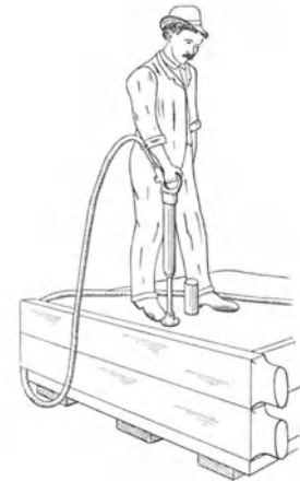
Abb. 11. Preßluftstampfer mit Handgriff.
