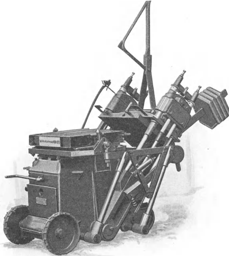
Abb. 1226. Voßmaschine mit Wendevorrichtung.
