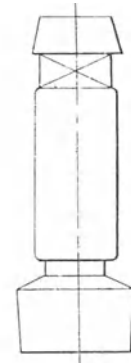
Abb. 288. Kern für Schraube.
