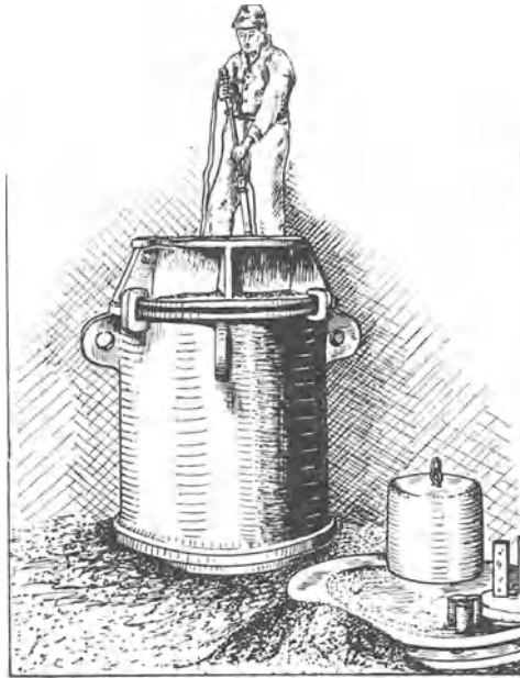
Abb. 499. Aufstampfen des Oberteils.
