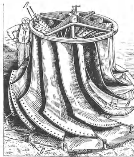
Abb. 786. Verbindung des Schraubenbündels bei sehr großen Laufädern.
