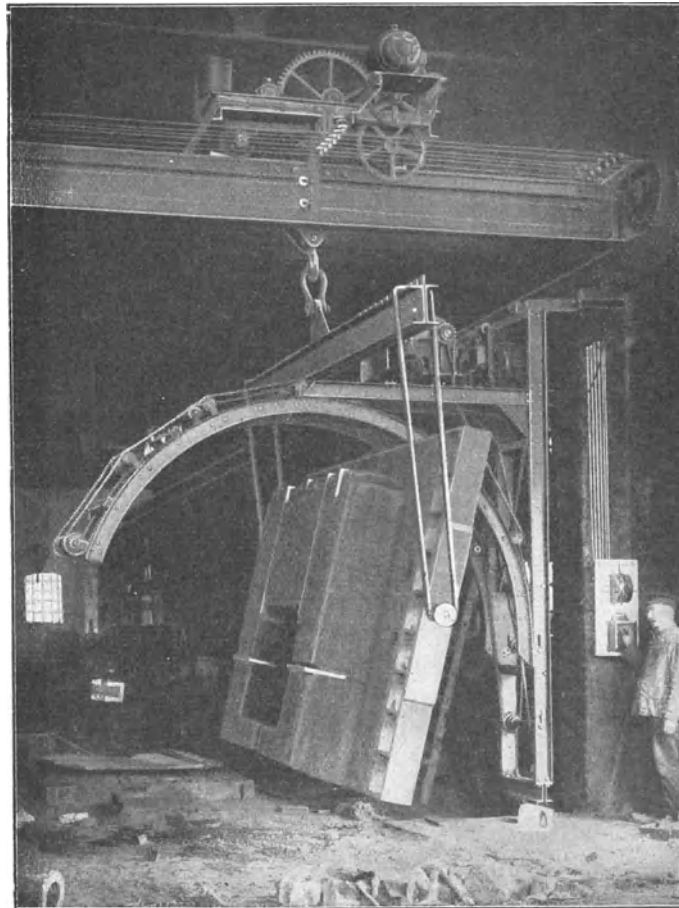
Abb. 724. Ortsfeste Wendevorrichtung mit Laufkran.
