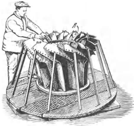
Abb. 779. Einrichtung zum Zusammenstellen der Blechschaufeln.
