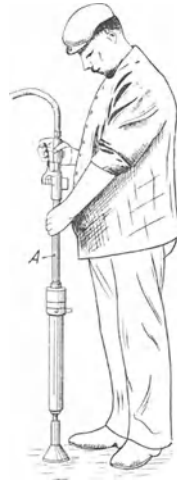
Abb. 10. Preßluftstampfer mit Verlängerungsanschluß.
