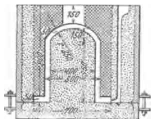
Abb. 1602. Form eines Behälters umgekehrt.
