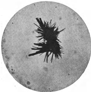
Abb. 9. Reaktionsprodukt von 2,4,5-Trinitro-1-naphthol (Naphtholpikrinsäure) mit Ammoniak.
