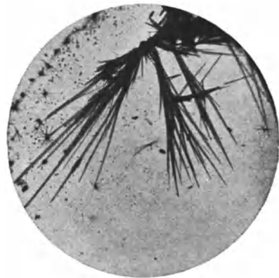
Abb. 8. Reaktionsprodukt von 4,8-Dinitro-1-naphthol mit Ammoniak.
