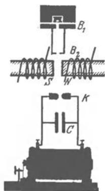
Abb. 336. Magnetische Ablenkung von  $\beta$ -Strahlen.
