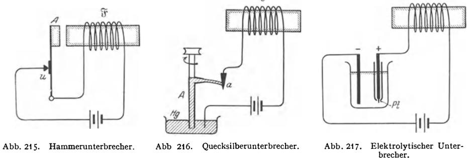
Abb. 215. Hammerunterbrecher.
