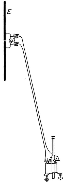
Abb. 378 b. Kleiner Dipol als Empfänger. *D* Detektor.
