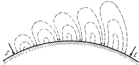
Abb. 390. Zur Wellentelegraphie über gut leitende Teile der Erdkugel mit langen Wellen
