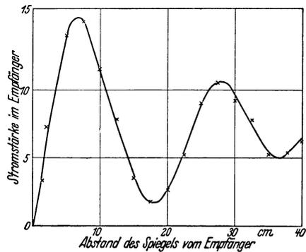
Abb. 386. Messung der Wellenlänge des in Abb. 378 a abgebildeten Dipols.
