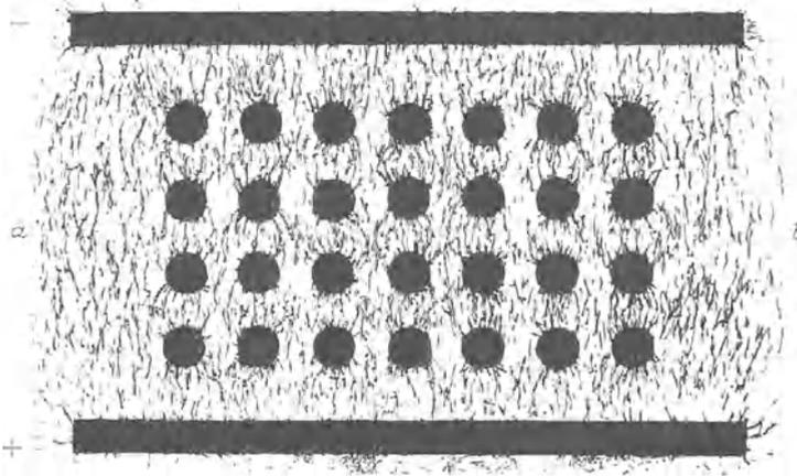
Abb. 92. Modellversuch zur Erläuterung der Dielektrizitätskonstanten.
