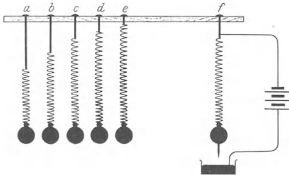
Abb. 357 a—f. Erzwungene mechanische Schwingungen. *f* Erreger, *a* bis *e* Resonatoren.
