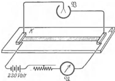
Abb. 283. Aufnahme der Stromspannungskurve in einem elektrolytischen Leiter.
