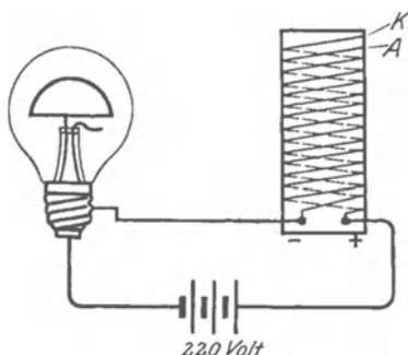
Abb. 302. Änderung des spezifischen Widerstandes technischer Selenpräparate durch Bestrahlung. Die Glühlampe dient als Stromindikator.
