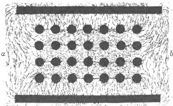
Abb. 91. Modellversuch zur Erläuterung der Influenz in einem Leiter.
