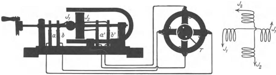
Abb. 205. Vorführungsmodell eines Zweiphasendrehfeldgenerators und eines Drehfeldmotors mit einer Kupferscheibe als Läufer (vgl. Abb. 211 c).
