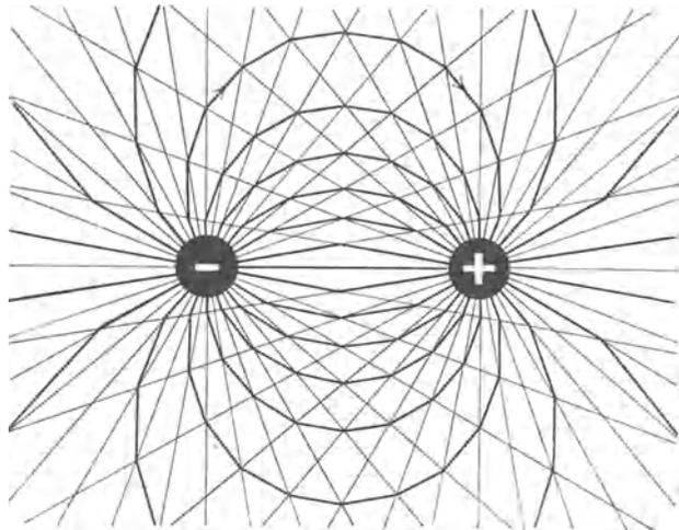
Abb. 112. Entstehung des elektrischen Feldlinienbildes zwischen einer + und einer - geladenen Kugel.
