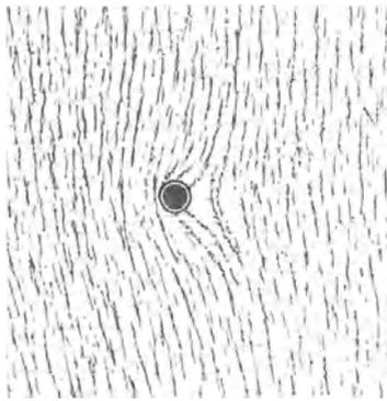
Abb. 174. Ein zur Papierebene senkrechter, stromdurchflossener gerader Leiter im homogenen Magnetfeld. Feldlinien mit Eisenfeillicht dargestellt.
