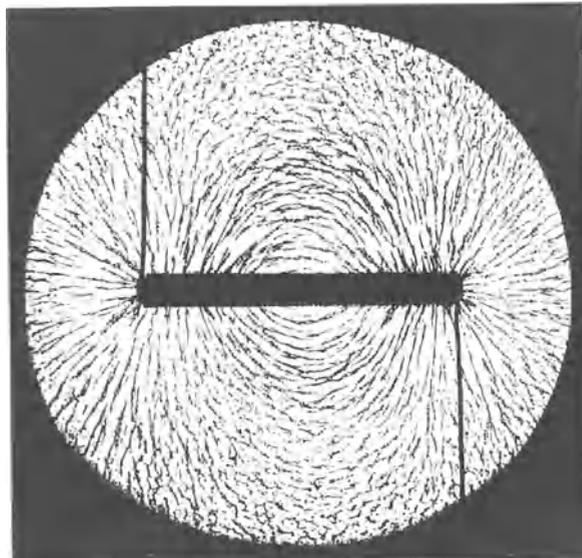
Abb. 160. Gerade Spule mit Eisenkern.
