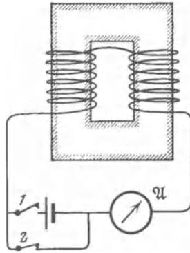
Abb. 208 b. Langsames Abklingen eines Stromes nach Entfernung der Stromquelle.
