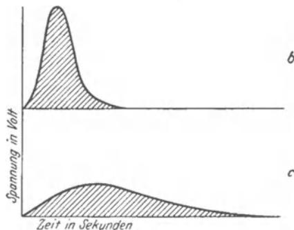
Abb. 136 b, c. Zwei gleich große „Spannungsstöße“ oder „Zeitsummen von Spannungen“, gemessen in Voltsekunden.
