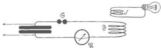
Abb. 229. Induktion mit hochfrequentem Wechselstrom. Die mit Pfeilen angedeuteten Leitungen dienen zur Aufladung des Kondensators.  $\mathfrak{G}$  = Funkenstrecke.
