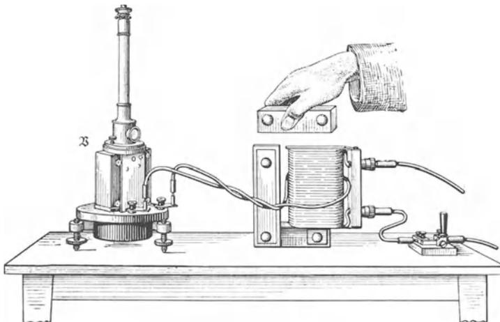
Abb. 162. Veränderung des Kraftflusses einer Spule mit Eisenkern durch Veränderung des „Eisenschlusses“.
