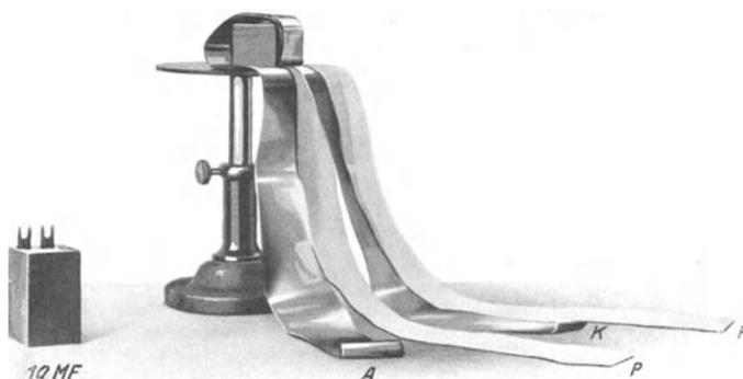
Abb. 50. Links ein zusammengesetzter, rechts ein teilweise auseinander gewickelter technischer Papierkondensator von 10 Mikrofarad Kapazität. Die beiden Stanniolstreifen haben je rund  $4 \text{ m}^2$  Fläche. Ihr Abstand oder die Dicke der Papierstreifen  $P$  beträgt rund  $0,02 \text{ mm}$ .
