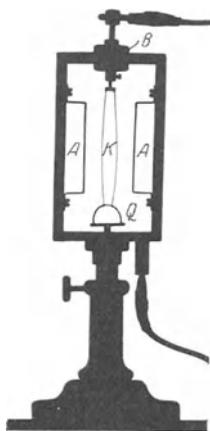
Abb. 24 a. Attrappe eines „Zweifadenelektrometers“ od. „Zweifadenvoltmeters“. Meßbereich etwa 30 bis 400 Volt.
