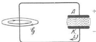
Abb. 134. Leitungsstrom beim Entladen eines Kondensators (vgl. Abb. 49). Als „Richtung“ des Leitungsstromes  $i$  bezeichnen wir stets die Wanderungsrichtung der negativen Elektrizitätsatome.
