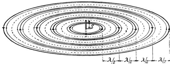
Abb. 388. Magnetische Feldlinien eines Dipols.
