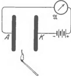
Abb. 243. Ein brennendes Streichholz als Ionisator. Galvanometer wie in Abb. 49 u. 101.
