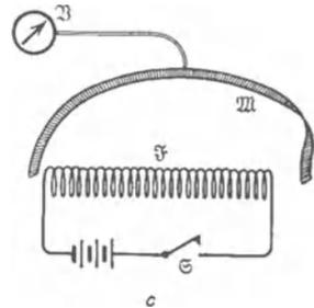
Abb. 143 a—c. Verteilung der magnetischen Spannung im Felde einer gestreckten Feldspule  $\mathfrak{F}$ .  $\mathfrak{F}$  hat 900 Windungen, eine Länge von 50 und einen Durchmesser von 10 cm. Sie wird von 1 Ampere Strom durchflossen, die magnetische Feldstärke  $\mathfrak{H}$  im Spulennern berechnet sich zu 18 Amperewindungen pro Zentimeter.
