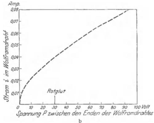
Abb. 295 a, b. Zunahme des Widerstandes eines metallischen Leiters (Wolframspiraldraht einer Glühlampe) mit der Temperatur. In der Schaltskizze muß der Widerstand des Voltmeters  $\mathfrak{V}$  groß gegen den der Glühlampe sein, damit nur ein verschwindend kleiner Teil des von  $\mathfrak{A}$  angezeigten Stromes auf das Voltmeter entfällt.
