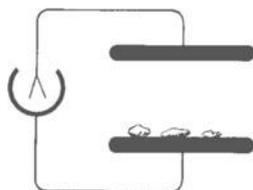
Abb. 331. Nachweis der radioaktiven Strahlung von Pechblendestücken.
