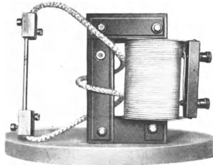
Abb. 213. Stromwandler zur Erzeugung hoher Stromstärken.
