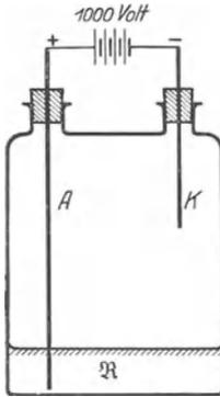
Abb. 347. Gewinnung eines Niederschlages von Radium A auf dem Drahte K. R wäßrige Lösung eines Radiumsalzes. Als Stromquelle Influenzmaschine.
