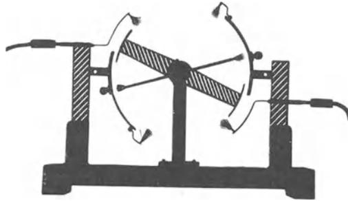
Abb. 82. Übersichtliche Influenzmaschine nach dem Multiplikatorverfahren.
