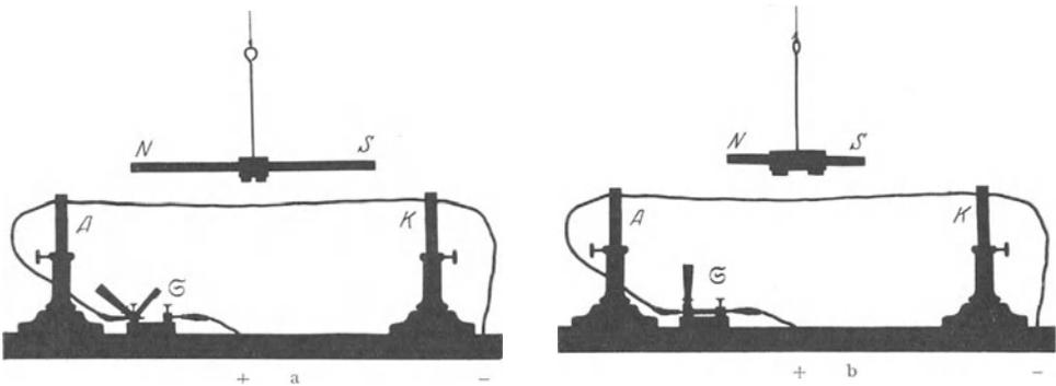
Abb. 5 a, b. Starr befestigter Leiter  $KA$  und beweglich aufgehängter Stabmagnet  $NS$ .  $\text{G}$  = Schalter.
