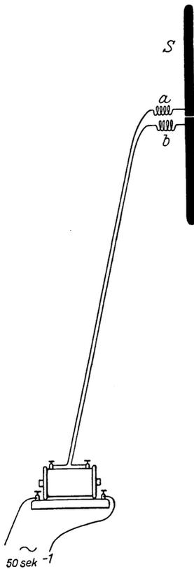
Abb. 378 a. Kleiner Dipol als Sender. *a* und *b* Drosselspulen.
