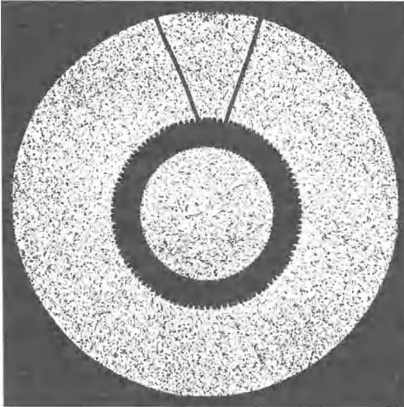
Abb. 157. Spule mit Eisenkern, beide ringförmig geschlossen.
