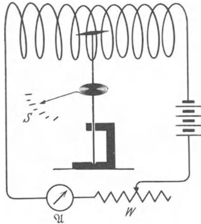
Abb. 124. Magnetoskop bzw. Magnetometer. Spule wie in Abb. 138.
