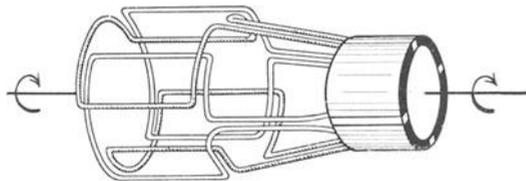
Abb. 181. Trommelläufer mit 2 Spulenpaaren.
