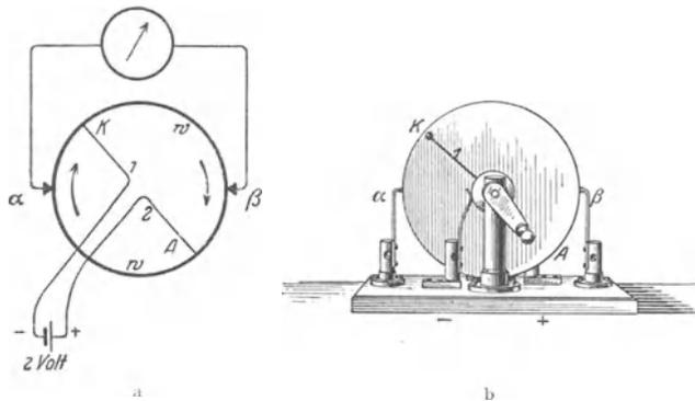
Abb. 150. Herstellung eines Wechselstroms sehr kleiner Frequenz. a Schema, b technische Ausführung. In letzterer ist einer der beiden Schleifringe sicht-bar, die das Verdrehen der Gleichstromleitungen 1 und 2 verhindern.
