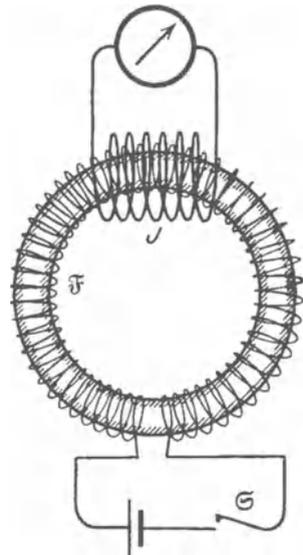
Abb. 140. Zur Messung der Permeabilität.
