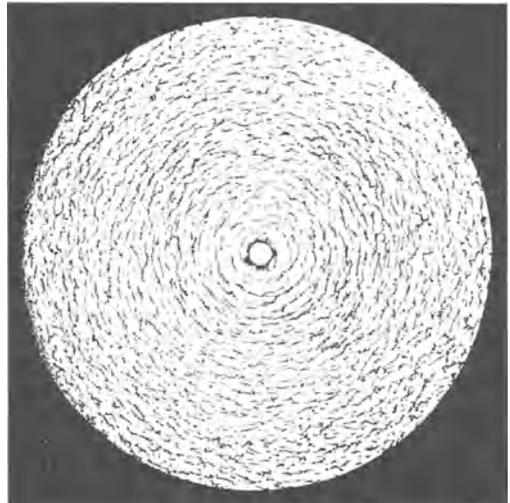
Abb. 4. Kreisförmige magnetische Feldlinien eines stromdurchflossenen Drahtes.
