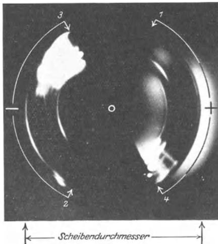
Abb. 85. Verteilung der Ladungen auf einer im Betrieb befindlichen Holtzschen Influenzmaschine.
