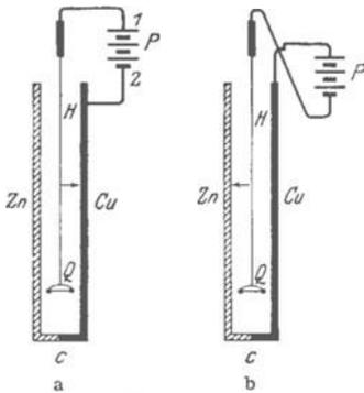
Abb. 312 a, b. Entstehung eines elektrischen Feldes bei der Berührung zweier Metalle.
