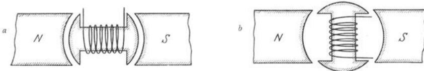
Abb. 179. Eisenkerne von Feld und Läufer spule eines Generators; bei a ist der Kraftfluß groß, bei b klein.
