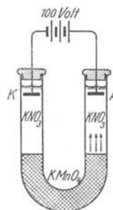
Abb. 286. Messung der Wanderungsgeschwindigkeit farbiger Ionen im elektrischen Felde.
