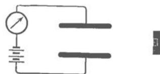
Abb. 334. Nachweis von  $\beta$ -Strahlen. Galvanometer wie in Abb. 49<sup>1)</sup>.
