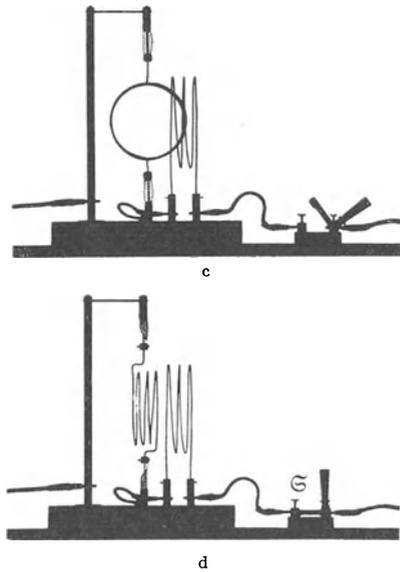
Abb. 9 c, d. Rechts eine feste, links eine drehbare Spule. Zuleitungen zur „Drehspule“ aus gewebtem Metallband.
