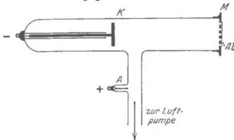
Abb. 269. Kathodenstrahlrohr mit Aluminiumfenster nach Lenard.
