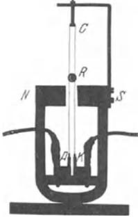
Abb. 17a. Attrappe eines Schleifenstrommessers oder Oszillographen. *ACK* gespannte Drahtschleife mit Spiegel *R*. (Die Drahtschleife darf keinesfalls in Resonanz mit dem zu registrierenden Wechselstrom stehen!)
