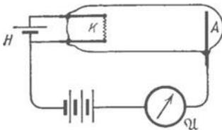
Abb. 251. Elektronenstrom aus einer Glühkathode.
