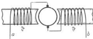
Abb. 185. Schaltschema einer Hauptschlußdynamo.
