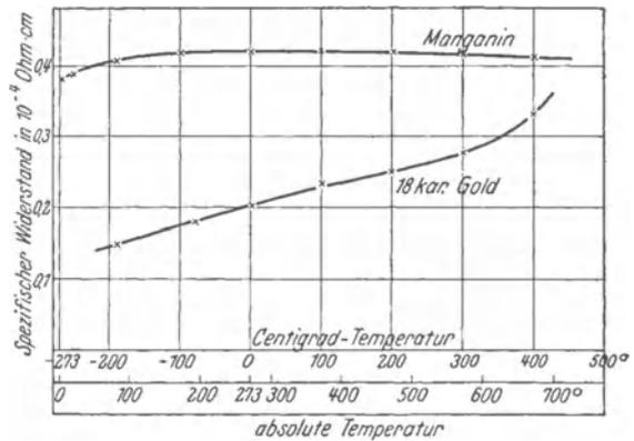
Abb. 297. Temperaturabhängigkeit des spezifischen Widerstandes von Legierungen.
