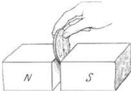
Abb. 197. Wirbelströme verlangsamen den Fall einer Silbermünze.
