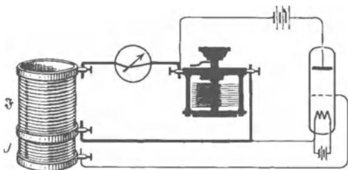
Abb. 355. Erzeugung ungedämpfter elektrischer Schwingungen einer Frequenz von  $10^6 \text{ sek}^{-1}$
