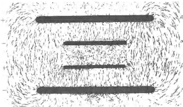
Abb. 72. Die beiden Elektrizitätsträger  $\alpha$  und  $\beta$  sind im Felde getrennt worden.
