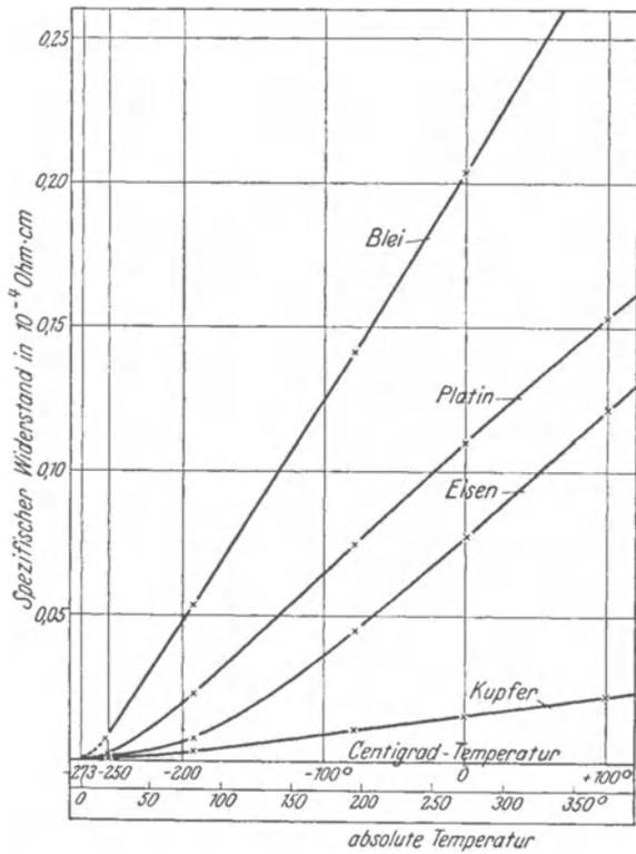
Abb. 296. Temperaturabhängigkeit des spezifischen Widerstandes reiner Metalle.
