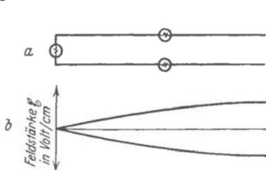
Abb. 369 a, b. „Nicht aufgeklappter“ Dipol und Verteilung der elektrischen Feldstärke zwischen seinen Schenkeln.
