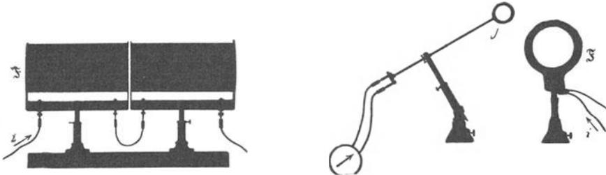
Abb. 138 a. Feldspule  $\mathfrak{F}$  für die Induktionsversuche der Abb. 137, aus zwei Teilen zusammengesetzt, Seitenansicht.  $n/l = 20 \text{ cm}^{-1}$ .
