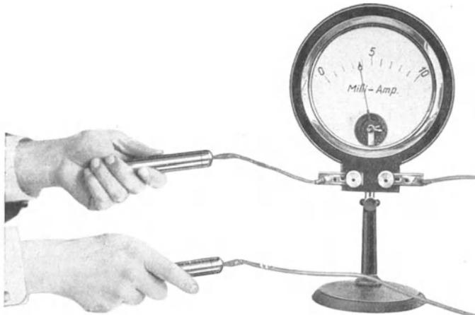
Abb. 31. Einschaltung einer Versuchsperson in einen Stromkreis. Strommesser nach dem Schema der Abb. 8. Die Handgriffe enthalten unsichtbare Schutzwiderstände, die auch bei Schaltungsfehlern eine Gefährdung der Versuchsperson verhindern.
