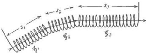
Abb. 141. Schema des magnetischen Spannungsmessers von Rogowski.
