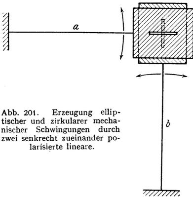
Abb. 201. Erzeugung elliptischer und zirkularer mechanischer Schwingungen durch zwei senkrecht zueinander polarisierte lineare.
