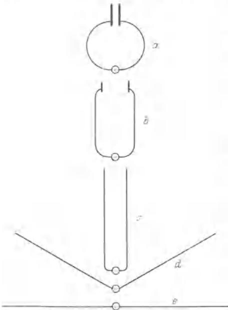
Abb. 362. Übergang vom geschlossenen Schwingungskreis zum elektrischen Dipol.
