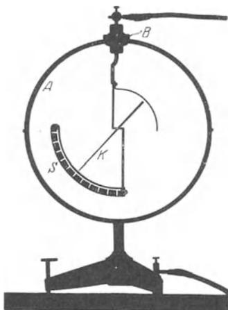
Abb. 23. Statischer Spannungsmesser mit einem Aluminiumzeiger in Spitzenlagerung. Brauchbar von einigen Hundert bis etwa 10000 Volt.
