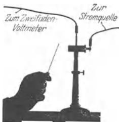
Abb. 342b. Einem Spitzenzähler wird ein mit Radium  $A$  überzogener Draht genähert.
