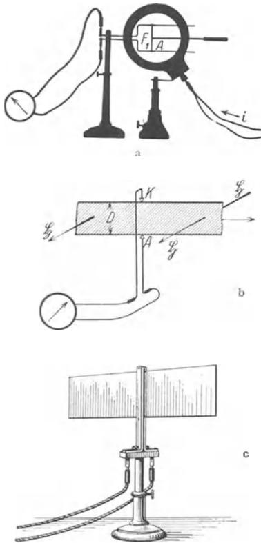
Abb. 168 a—c. Zur Induktion in Leitern, deren Einzelteile gegeneinander bewegt werden. Die Feldspule  $\vec{\Phi}$  in Abb. 168 a hat 10 Windungen pro cm Spulenlänge, also  $n/l = 10 \text{ cm}^{-1}$ ; Abbildung 168 c zeigt das Schema der Abb. 168 b in praktischer Ausführung.
