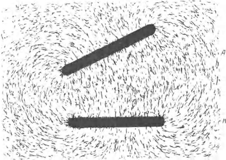
Abb. 38. Elektrische Feldlinien zwischen schräg zueinander stehenden Platten.
