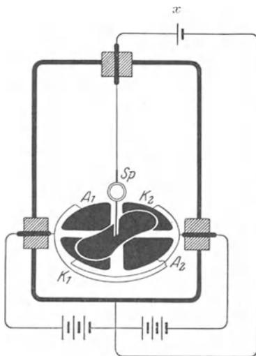
Abb. 115. Quadrantenvoltmeter.  $x$  unbekannte, zu messende Spannung.
