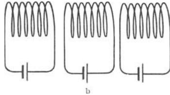
b) Es werden 4 gleich dicke, aber nur je 5 cm lange Spulen aneinandergereiht. Jede bekommt, evtl. in mehreren Lagen, 1000 Windungen. Jede Spule wird von einer besonderen Stromquelle aus mit 50 Milliampere gespeist (Abb. 125 b).
