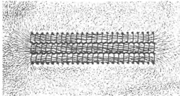
Abb. 121 a. Magnetfeld eines Spulenbündels. Die Einzelspulen waren bei diesem Modellversuch völlig getrennt. Die zickzackförmige Verbindung wird durch die Anhäufung von Eisenfeilicht zwischen benachbarten Drähten vorgetäuscht.
