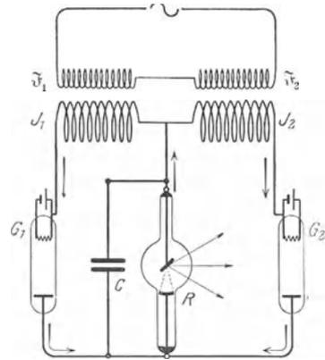
Abb. 256. Gleichrichterschaltung mit Glühkathodenventilröhren.
