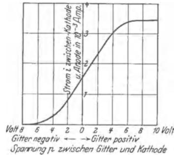
Abb. 255. Charakteristik eines Dreielektrodenrohres.
