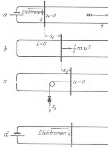
Abb. 175 a—d. Zur Arbeitsleistung eines geraden stromdurchflossenen Leiters 2 (Läufer) in einem zur Papierebene senkrechten homogenen Magnetfeld.
