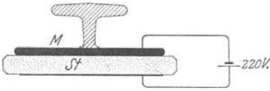
Abb. 110. Anziehung zweier Kondensatorplatten, die aus einem guten Leiter  $M$  und einem schlechten  $St$  bestehen.
