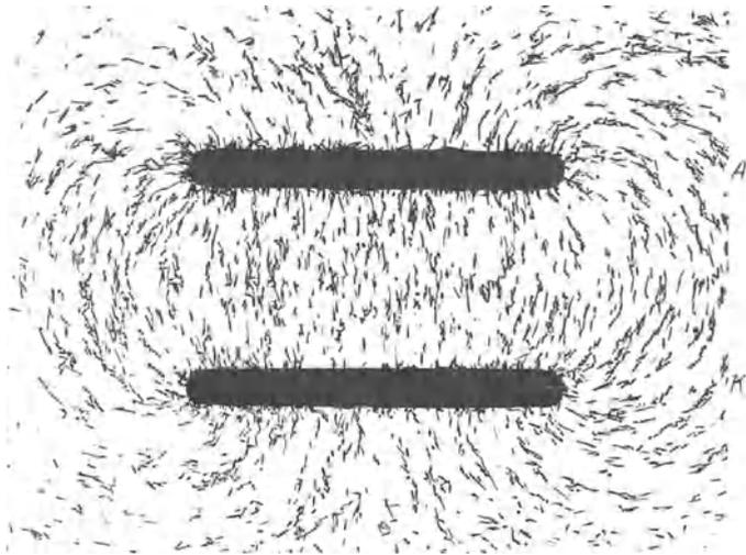
Abb. 37. Elektrische Feldlinien eines Plattenkondensators, mit Gipskristallen sichtbar gemacht. Diese sowie alle folgenden Bilder elektrischer Feldlinien ohne Retusche.
