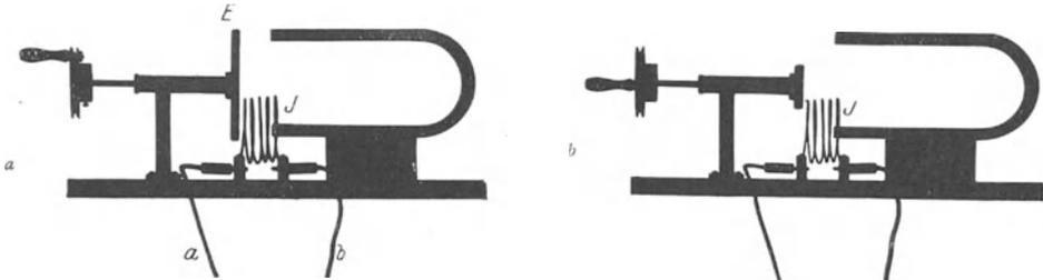
Abb. 189 a, b. Wechselstromgenerator mit spulenfreiem Läufer. Kraftfluß bei *a* groß, bei *b* klein.
