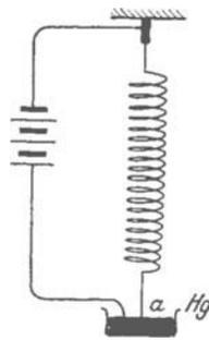
Abb. 169. Zusammenziehung einer stromdurchflossenen Spirale. (In diesem Fall steigt die magnetische Feldenergie während der Arbeitsleistung auf Kosten der Stromquelle, vgl. § 35.)
