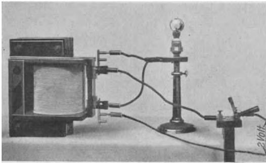
Abb. 167 a, b. Nachweis des Spannungsstoßes durch den Vorgang der Selbstinduktion, a mit dem Voltmeter  $\mathfrak{V}$ , b mit einer Glühlampe.
