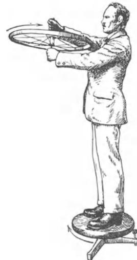
Abb. 129. Kippung eines Kreisels auf einem Drehschemel. (Erhaltung des Drehimpulses.)
