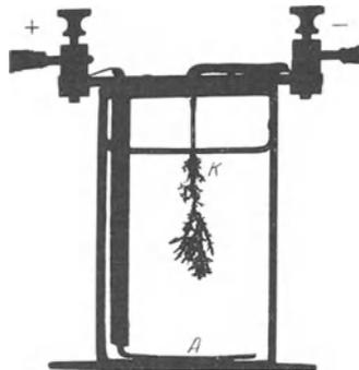
Abb. 14. Abscheidung von Bleikristallen beim Durchgang des Stromes durch wässrige Bleiazetatlösung.
