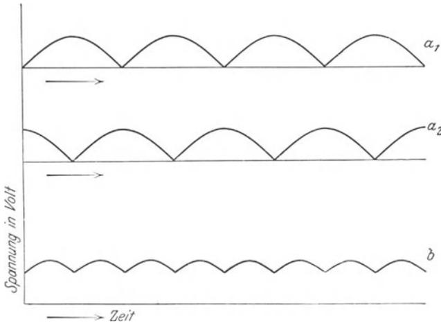
Abb. 182. Spannungskurve eines Trommelläufers mit 2 Spulenpaaren und ihre Entstehung.
