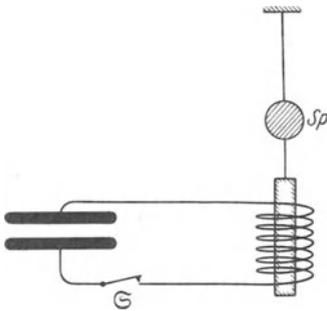
Abb. 130. Schema des Versuches zum Nachweis der Molekularströme im Eisen.
