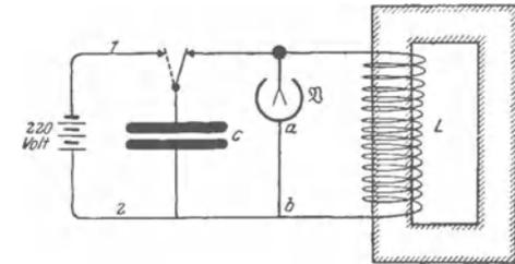
Abb. 225 Beobachtung der Wechselspannung bei langsamen elektrischen Schwingungen.
