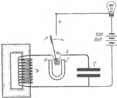
Abb. 353. Selbststeuerung eines elektrischen Schwingungskreises sehr kleiner Frequenz mit einem mechanischen Schaltwerk.
