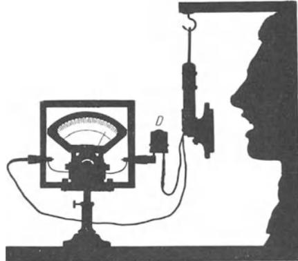
Abb. 192. Telephon als Wechselstromgenerator.
