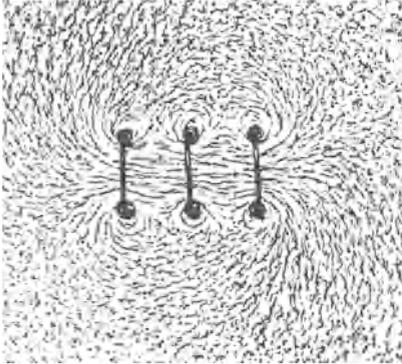
Abb. 118. Magnetische Feldlinien dreier paralleler, von gleichen Strömen durchflossener Kreisringe.
