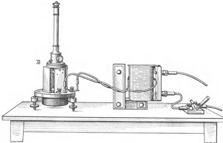
Abb. 161. Messung des Kraftflusses einer Spule mit Eisenkern. Das Drehspulgalvanometer wieder nach dem Schema der Abb. 8. Das Fenster für den Spiegel an der Drehspule befindet sich rechts unten am Fuß der Säule.
