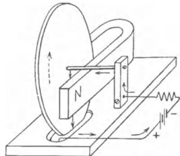
Abb. 294 b. Reibung der Elektronen in einem metallischen Leiter („Barlowsches Rad“).
