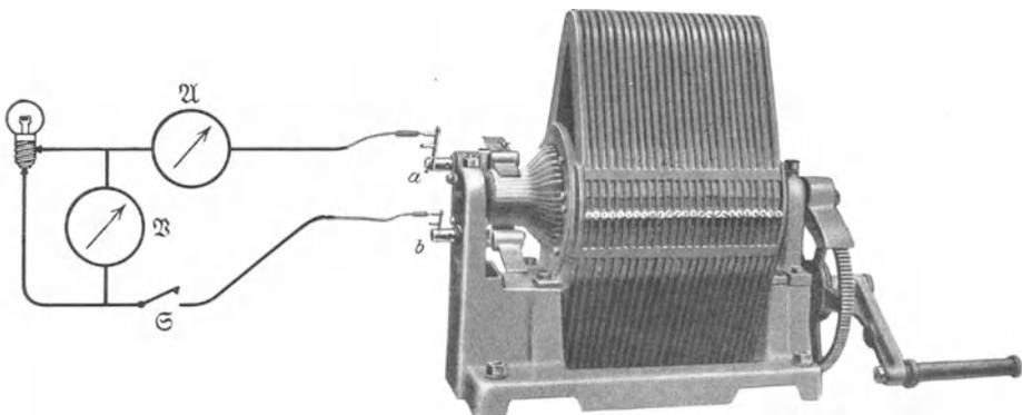
Abb. 194. Gleichstromgenerator mit permanenten Feldmagneten und Trommelläufer.
