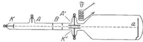
Abb. 266. Kathodenstrahloszillograph. („Braunsches Rohr“.)
