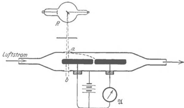
Abb. 248. Messung der Ionengeschwindigkeit.
