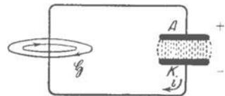
Abb. 153. Leitungsstrom beim Entladen eines Kondensators.
