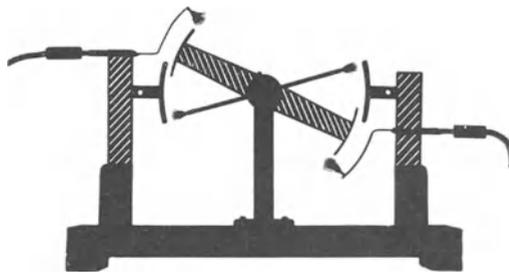
Abb. 79. Übersichtliche Influenzmaschine. Die im Schattenriß durchscheinenden Isolatoren nachträglich schraffiert.
