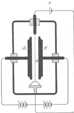
Abb. 114. Einfaden- oder Saitenvoltmeter.  $x$  unbekannte, zu messende Spannung.
