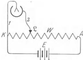
Abb. 29. Schema der Spannungsteilerschaltung.
