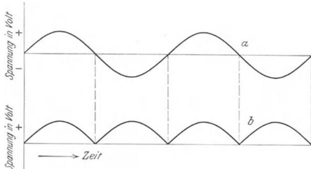
Abb. 178. a Sinusförmige Wechselspannung eines Wechselstromgenerators. b Spannungskurve eines Gleichstromgenerators mit einem einfachen Spulenläufer.
