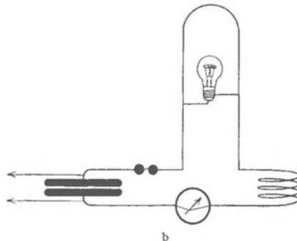
Abb. 231 a, b. Scheinwiderstand bei hochfrequentem Wechselstrom.
