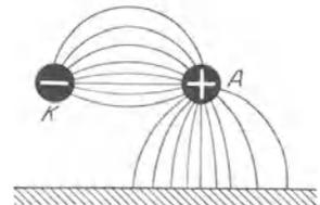
Abb. 40b. Skizze der elektrischen Feldlinien zwischen den Leitungen der städtischen Zentrale und der Zimmerwand.
