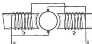
Abb. 188. Schaltschema einer Nebenschlußdynamo.
