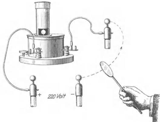
Abb. 60. Messung der Ladung eines „Elektrizitätsträgers“.
