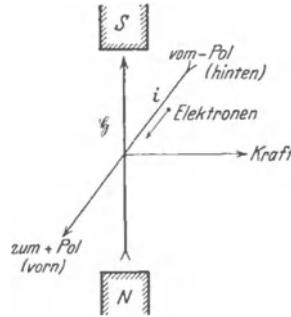
Abb. 173. Kraft auf einen stromdurchflossenen geraden Leiter im Magnetfeld.
