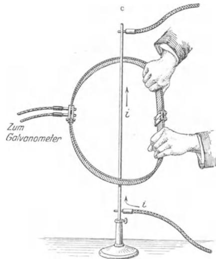
Abb. 142c. Einfache Umfassung eines Stromes mit einem magnetischen Spannungsmesser.
