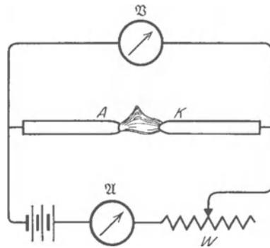
Abb. 280. Schaltung zur Aufnahme der Stromspannungskurve eines Lichtbogens. Das Voltmeter  $\Sigma$  muß einen so hohen Widerstand haben, daß der Strom in ihm, neben dem Strom im Lichtbogen, vernachlässigt werden kann.
