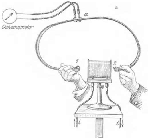
Abb. 142a. Handhabung des magnetischen Spannungsmessers.
