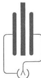
Abb. 90. Leiter im Felde eines Plattenkondensators.
