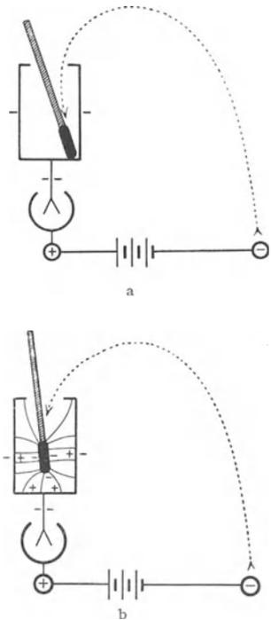
Abb. 75 a, b. Gleichheit der positiven und negativen Ladungen an den beiden Grenzen eines elektrischen Feldes.
