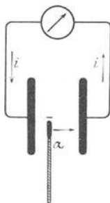
Abb. 309. Schema eines Konvektionsstromes. Galvanometer wie in Abb. 49 und 60.
