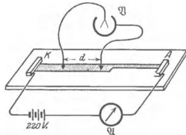
Abb. 285. Abhängigkeit des Widerstandes von Länge und Querschnitt des elektrolytischen Leiters.
