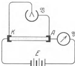
Abb. 27. Zur Vorführung des Ohmschen Gesetzes.
