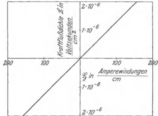
Abb. 164. Zusammenhang von magnetischer Feldstärke  $\mathfrak{H}$  und Kraftflußdichte  $\mathfrak{B}$  für eine paramagnetische oder diamagnetische Substanz
