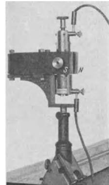
Abb. 17b. Saitengalvanometer für Projektion. Links oberhalb von *S* das abbildende Mikroskopobjektiv.
