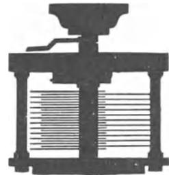
Abb. 61. Schattenriß eines Drehkondensators.
