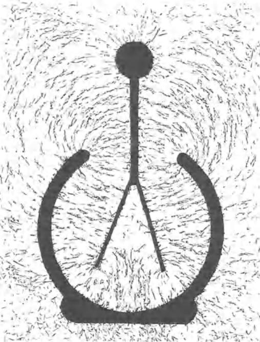
Abb. 43. Elektrische Feldlinien im statischen Voltmeter, oder das Elektrometer als Kondensator.
