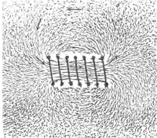
Abb. 119. Magnetische Feldlinien einer gedrunenen, stromdurchflossenen Spule. Die Pfeile bedeuten Kompaßnadeln, die Spitzen deren Nordpole. Man denke sich am Spulenende oben links den + Pol, am Spulenende unten rechts den - Pol der Stromquelle angeschlossen.
