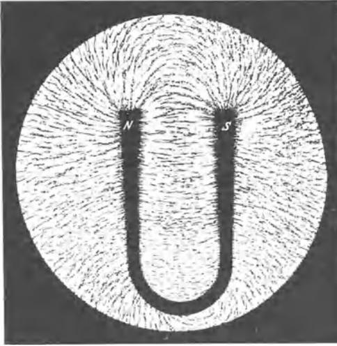
Abb. 1. Magnetische Feldlinien, dargestellt mit Eisenfeilicht.
