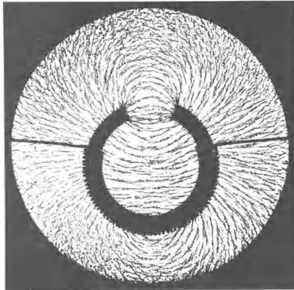
Abb. 159. Spule mit Eisenkern, beide offen.
