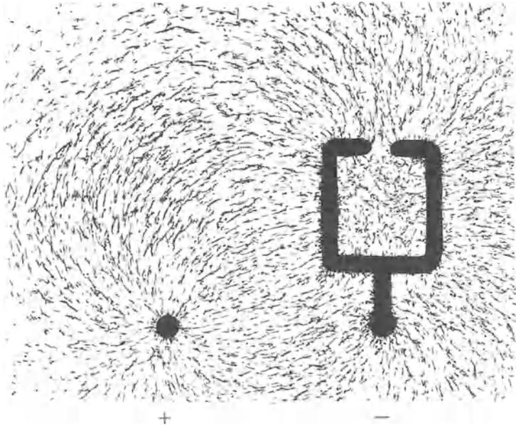
Abb. 68. Feldlinienbild zwischen einer Kugel und einem Kasten mit enger Öffnung.
