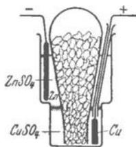
Abb. 320. Technische Variante des Daniell-Elementes.
