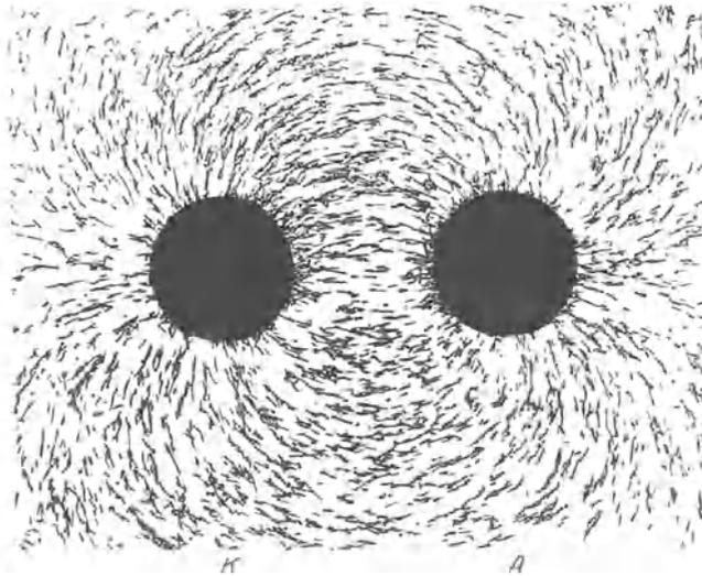
Abb. 40a. Elektrische Feldlinien zwischen zwei Kugeln bzw. Paralleldrähten.
