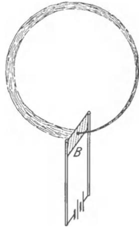
Abb. 265. Bündel von Kathodenstrahlen, die von einer Wehneltischen Oxydkathode ausgehen und durch ein homogenes Magnetfeld zu einer Kreisbahn gekrümmt werden. Die magnetischen Feldlinien laufen auf den Beschauer zu. Das evakuierte Glasgefäß und die Anode sind nicht mitgezeichnet.
