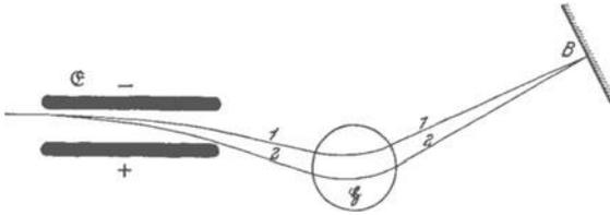
Abb. 271. Der Strahlengang im Massenspektrographen.
