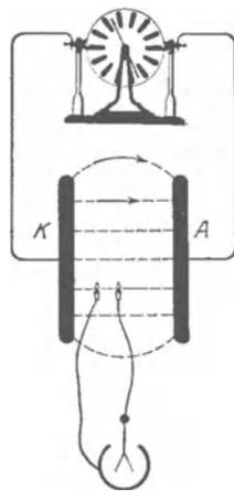
Abb. 99. Messung der elektrischen Feldstärke mit Hilfe von zwei Flammensonden.
