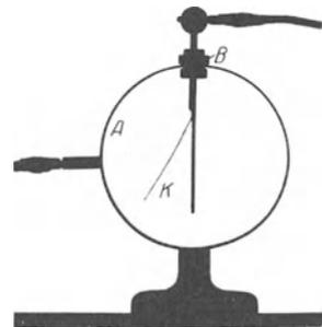
Abb. 22. Statischer Spannungsmesser mit einem Goldblattzeiger.
