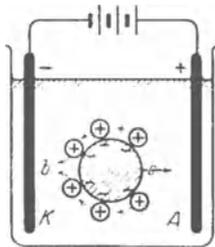
Abb. 304. Schema der Elektrophorese.
