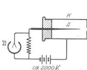
Abb. 342a. GEIGERSCHER Spitzenzähler für  $\alpha$ - und  $\beta$ -Strahlen.
