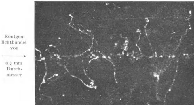
Abb. 340. Bahn von Röntgenlicht abgespaltener Elektronen.
