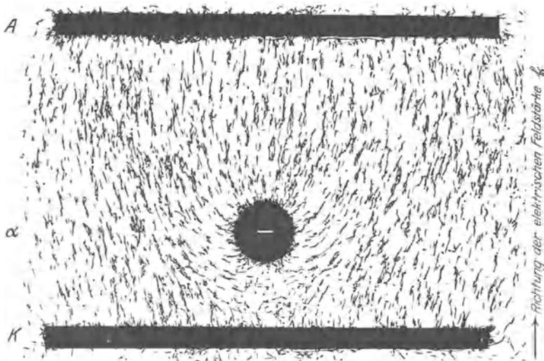
Abb. 107. Ein kleiner geladener Körper im elektrischen Felde eines Plattenkondensators.
