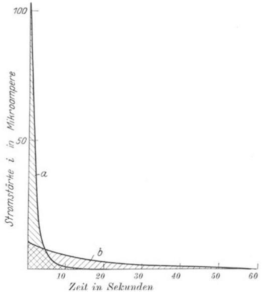
Abb. 59. Gleiche Amperesekundenzahlen bei verschieden raschem Feldzerfall.
