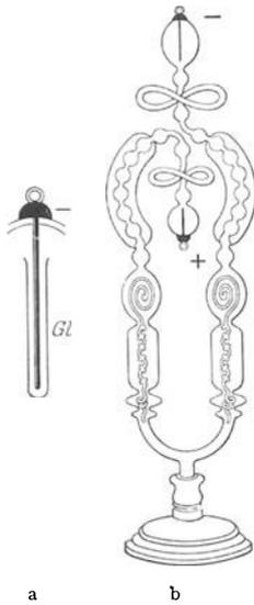
Abb. 260 a, b. Altertümliche Leuchtröhre („Geißleröhren“). Links der Schlauch des Glimmlichtes auf der Kathode.
