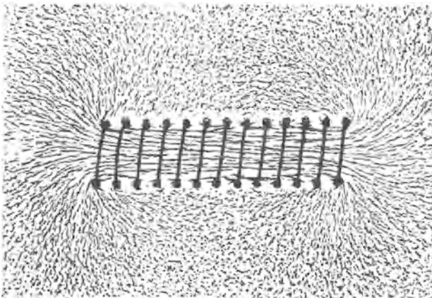
Abb. 120. Magnetische Feldlinien einer gestreckten stromdurchflossenen Spule. Im Innern der Spule ein homogenes Magnetfeld.
