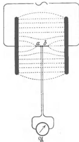
Abb. 232. Verschiebungsstrom im hochfrequenten elektrischen Wechselfeld.  $\sim$  = Wechselstromquelle (Schwingungskreis)
