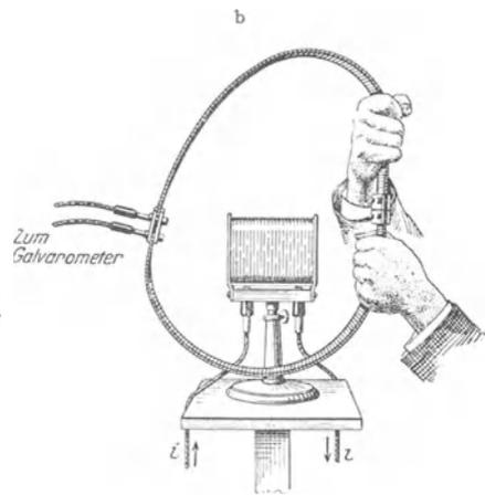
Abb. 142b. Geschlossener, keinen Strom umfassender Weg eines magnetischen Spannungsmessers.
