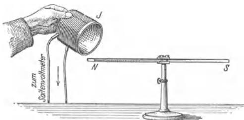
Abb. 135. Induktionsversuch.
