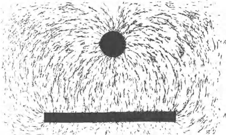
Abb. 39. Elektrische Feldlinien zwischen Platte und Kugel bzw. Draht.
