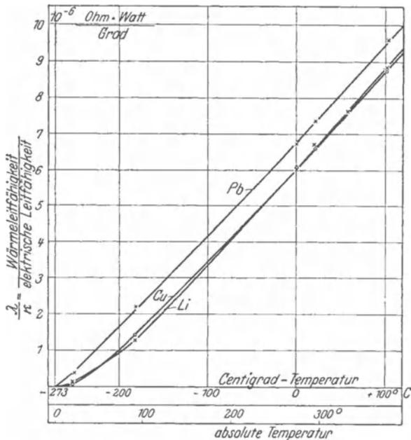
Abb. 299. Das Verhältnis der Wärmeleitfähigkeit zur elektrischen Leitfähigkeit bei verschiedenen Temperaturen.
