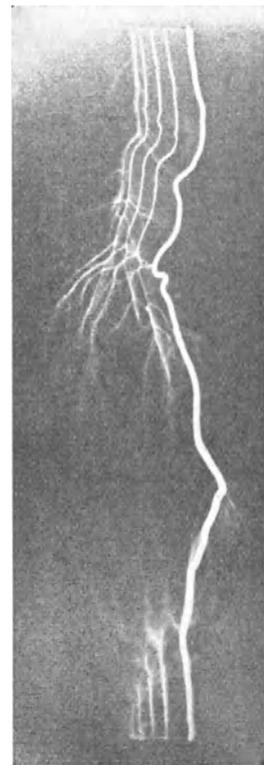
Abb. 275. Ausbildung eines elektrischen Funkens. Oben die Anode. (Aufnahme auf bewegter photographischer Platte von B. Walter.)
