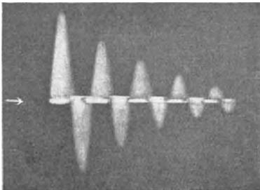
Abb. 264. Aufnahme einer gedämpften elektrischen Schwingung (nach retouchiertem Lichtbild).
