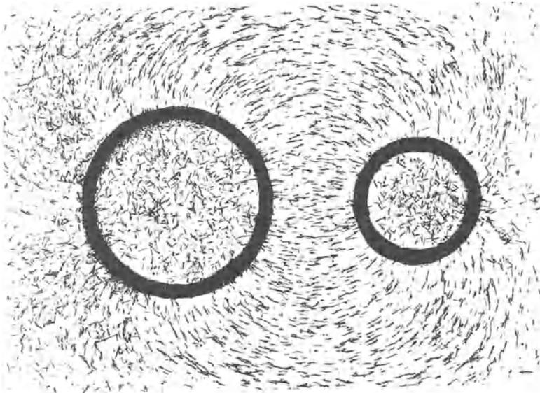
Abb. 66. Elektrische Feldlinien zwischen zwei Hohlkugeln. Das Innere der Hohlkugeln ist feldfrei.
