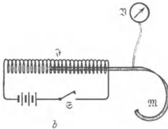
Der Spannungsmesser taucht nur in die rechte Hälfte der Feldspule  $\mathfrak{F}$  hinein. Man beobachtet einen Spannungsstoß von  $0,85 \cdot 10^{-3} = \frac{1}{2} \cdot 1,7 \cdot 10^{-3}$  Voltsekunden oder  $M = 425$  Amperewindungen. Also ist die Feldstärke  $\mathfrak{H}$  im Spulennern konstant.
