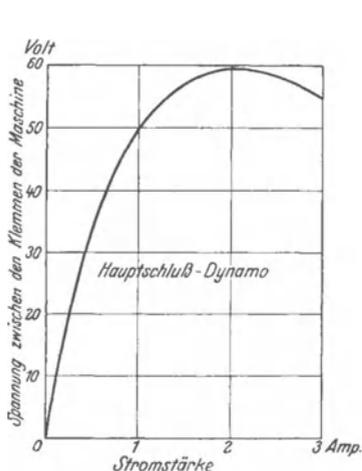
Abb. 186. Kennlinie einer Hauptschlußdynamo.
