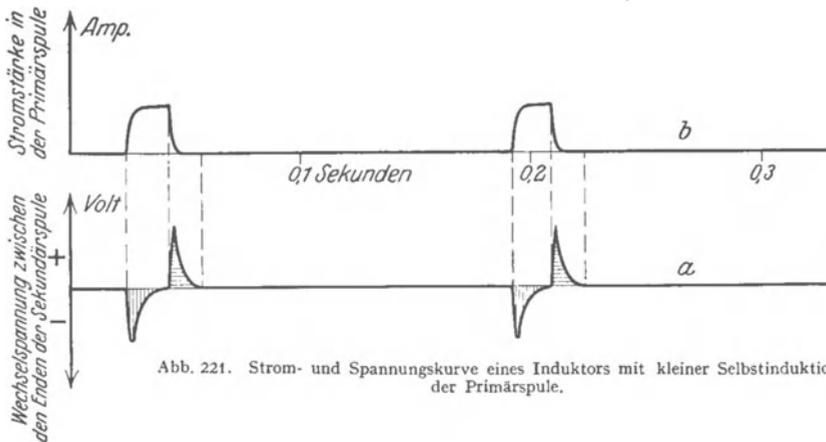
Abb. 221. Strom- und Spannungskurve eines Induktors mit kleiner Selbstinduktion der Primärspule.
