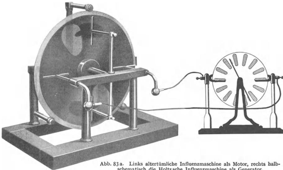
Abb. 83a. Links altertümliche Influenzmaschine als Motor, rechts halbschematisch die Holtzsche Influenzmaschine als Generator.
