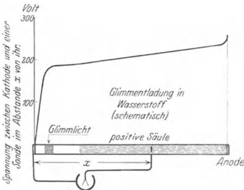
Abb. 258. Spannungsverteilung im Glimmstrom.
