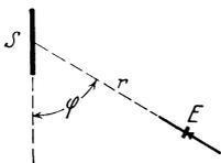
Abb. 379. Ausmessung des Dipolfeldes, radiale Komponenten des elektrischen Feldes in der Nähe des Senderdipols *S*.
