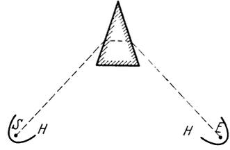
Abb. 393. Spektrometer zur Messung des Brechungsindex elektrischer Wellen.
