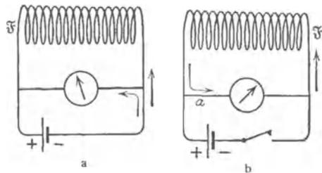
Abb. 206 a, b. Trägheit des elektrischen Stromes in einer Spule.
