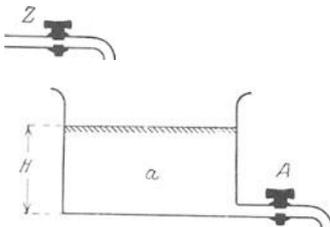
Abb. 64. Wassermodell zur Erläuterung einer elektrischen Zeitmessung.
