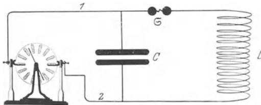
Abb. 226. Eine Funkenstrecke  $\odot$  als Schalter in einem elektrischen Schwingungskreis.
