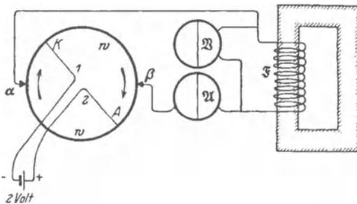
Abb. 211 a. Phasenverschiebung zwischen Strom und Spannung bei Wechselströmen sehr kleiner Frequenz. — Links Wechselstromquelle nach dem Schema der Abb. 150. — X Saitengalvanometer (Abb. 17 b) als Amperemeter (Nebenschluß von einigen  $10^{-3}$  Ohm); B Einfeldvoltmeter (Abb. 114) (oder Saitengalvanometer als Voltmeter mit einigen  $10^3$  Ohm Verschaltwiderstand).
