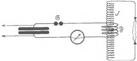
Abb. 230. Induktion mit hochfrequentem Wechselstrom in einer Spule.  $J$  mit vielen Windungen. („Teslatransformator“.)
