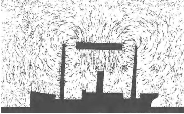
Abb. 42 Elektrische Feldlinien zwischen Antenne und Schiffskörper.
