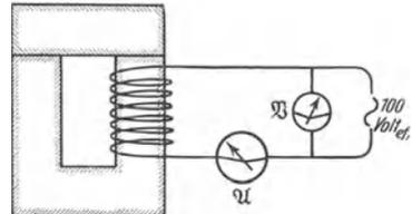
Abb. 209. Scheinwiderstand bei Wechselstrom. Gleiche Spule wie z. B. in Abb. 167 b und 213.
