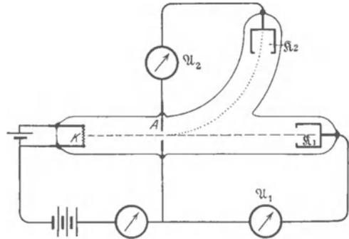
Abb. 252. Geradlinige Flugbahn der unsichtbaren Kathodenstrahlen und ihre Kreisbahn in einem Magnetfeld. Das Magnetfeld  $G$  steht rechts von  $A$  senkrecht zur Papierebene, auf den Beschauer hin gerichtet.
