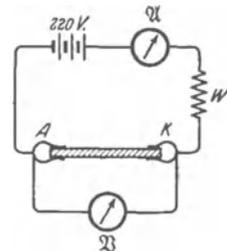
Abb. 292. Temperaturabhängigkeit der Ionenleitung in Glas.
