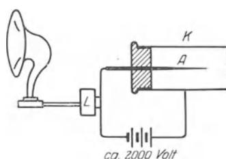
Abb. 343. Spitzenzähler mit Verstärker  $L$  und Lautsprecher (auch Relais mit Glocke usw. anwendbar).
