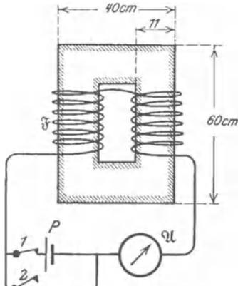
Abb. 208 a. Langsames Anlaufen eines Stromes.
