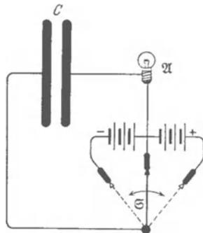
Abb. 152. Schalter zum raschen Wechsel von Ladung und Entladung eines Kondensators.
