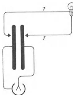
Abb. 51. Beim Feldzerfall durch einen Leitungsdraht  $I$  leuchtet eine eingeschaltete Glühlampe auf.
