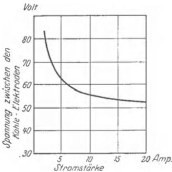
Abb. 279. Stromspannungskurve eines Lichtbogens.
