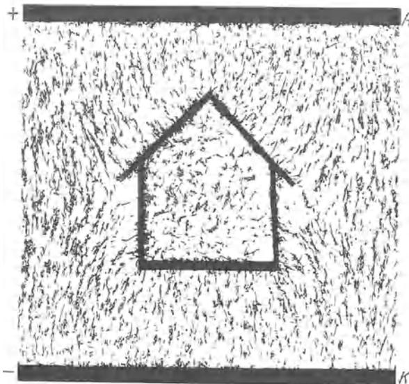
Abb. 74. Unterbrechung der elektrischen Feldlinien durch einen leitenden Hohlraum.
