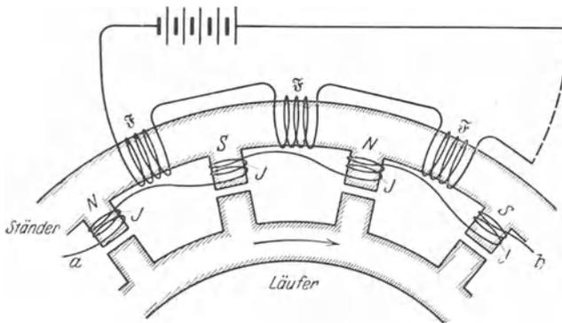
Abb. 190. Wechselstromgenerator mit Zahnradläufer.
