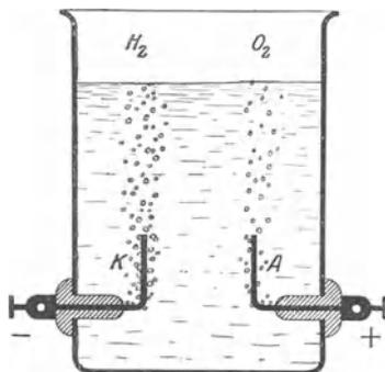
Abb. 13. Abscheidung von Wasserstoff ( $H_2$ ) und Sauerstoff ( $O_2$ ) beim Durchgang des Stromes durch verdünnte Schwefelsäure.
