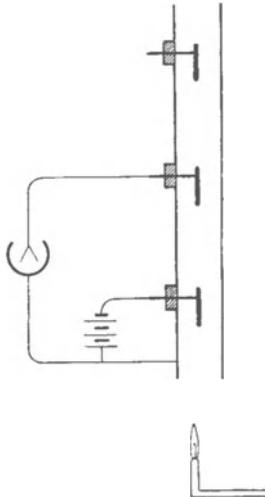
Abb. 246. Beseitigung von Ionen durch ein elektrisches Feld.
