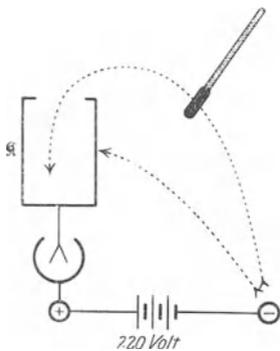
Abb. 70. Erzeugung hoher Spannungen zwischen dem Kasten  $\mathfrak{K}$  und dem Voltmetergehäuse. (Man hüte sich vor ungewollten Kombinationen dieses Versuches mit dem in Abb. 44 dargestellten!)
