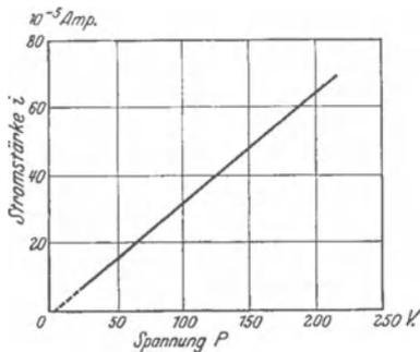
Abb. 284. Das Ohmsche Gesetz bei der elektrolytischen Leitung.
