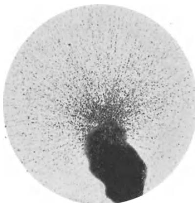
Abb. 341. Schußbahnen von  $\alpha$ -Strahlen in einer photographischen Platte. Vergrößerung etwa 500fach.
