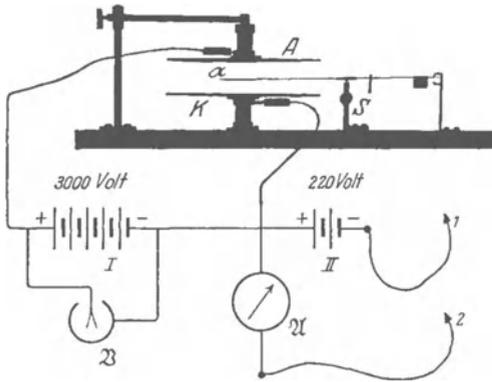
Abb. 106. Grundversuch über die Abhängigkeit der Kräfte von Ladung und Feldstärke. Der Waagebalken aus Quarz trägt rechts zwei Reitergewichte aus Al-Blech und spielt zwischen zwei Anschlägen. S ist eine Masse, die den Schwerpunkt des Waagebalkens unter die Schneide verlegt. — Die Kondensatorplatten A und K werden durch Bernsteinsäulen getragen. Man kann wegen ihrer vorzüglichen Isolation die gezeichnete Batterie I durch ganz primitiv Mittel (geriebene Siegelackstange!) ersetzen!
