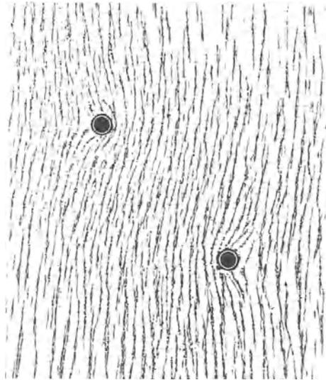
Abb. 176 b. Eine zur Papierebene senkrechte stromdurchflossene Spule im homogenen Magnetfelde.
