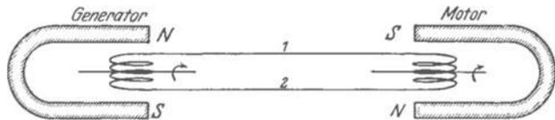
Abb. 198. Wechselstromsynchronmotor in Verbindung mit einem Wechselstromgenerator mit Außenpolen.
