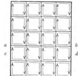
Abb. 122. Schema eines Bündels rechteckiger Einzelspulen. *ab* Zeichenebene der Abb. 121 b, *cd* der Abbildung 121 a.
