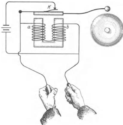
Abb. 167c. Nachweis der Selbstinduktion mit einer Hausklingel.
