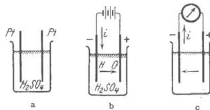
Abb. 321 a—c. Zum Nachweis der Polarisationsspannung.
