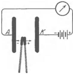
Abb. 238. Modellversuch eines Leitungsstromes mit ganz groben, mit der Hand bewegten Elektrizitätsträgern. Galvanometer wie in Abb. 49 und 101.
