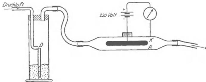
Abb. 242. Elektrizitätsleitung mit staubförmigen Elektrizitätsträgern. Galvanometer wie Abb. 49 und 101.
