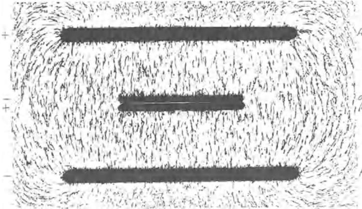
Abb. 71. Bild elektrischer Feldlinien (Gipskristalle) zur Erläuterung der Influenz. Zwei plattenförmige Elektrizitätsträger  $\alpha$  und  $\beta$  berühren sich im Felde.
