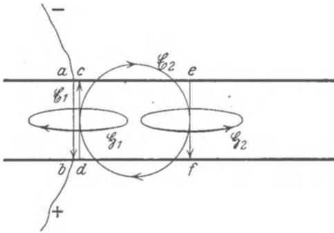
Abb. 376. Induktionswirkung des Verschiebungsstromes bei der Fortpflanzung elektrischer Drahtwellen.
