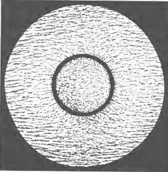
Abb. 133. Panzerschutz zum teilweisen Abschirmen eines Magnetfeldes.
