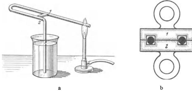
Abb. 315 a, b. Zum Nachweis großer Stromstärken als Folge thermoelektrischer Spannungen.
