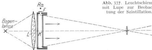
Abb. 338. Kammer zur Herstellung von Nebelstrahlen vor der Projektionslampe, stark schematisiert.
