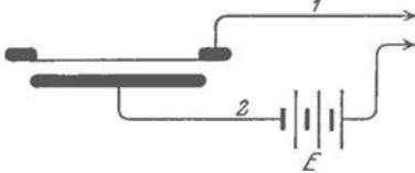
Abb. 109. Schema des Kondensatortelefones.
