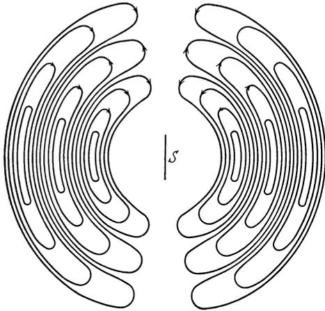
Abb. 384. Momentbild der Verteilung des elektrischen Feldes um einen Dipol. Hertz'sches Strahlungsfeld eines Dipols.
