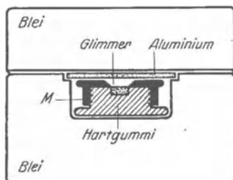
Abb. 332. Radiumbromidpräparat in Hartgummikapsel und dickwandigem Bleikasten. Messingdeckel.
