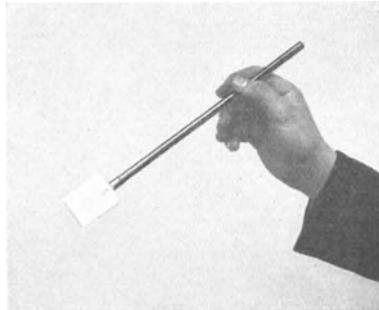
Abb. 46. „Löffel am Bernsteinstiel“, kleiner „Konduktor“ oder „Elektrizitätsträger“.
