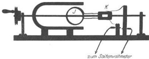
Abb. 180. Gleichstromgenerator mit einfachem Spulenläufer und permanentem Feldmagneten.
