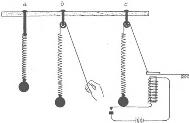
Abb. 352 a—c. Zur Selbststeuerung eines mechanischen Pendels.
