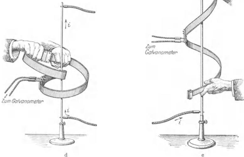
Abb. 142 d, e. Zweifache Umfassung eines Stromes mit einem magnetischen Spannungsmesser, d auf geschlossenem, e auf offenem Wege.
