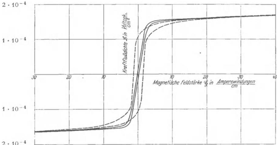
Abb. 165. Hysteresisschleifen ausgezogene Kurve für 12 mal geglühtes Elektrolyteisen, gestrichelte für ungeglühten Dynamostahl.
