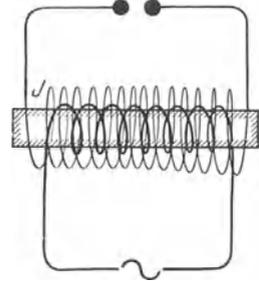
Abb. 212 b. Stromwandler für Wechselstrom mit offenem Eisenkern.
