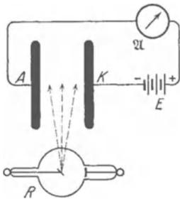
Abb. 247. Ionisierung von Zimmerluft durch Röntgenlicht. Galvanometer wie in Abb. 49 und 101.
