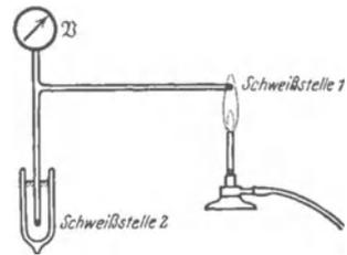
Abb. 314. Thermoelektrische Spannung. Die Schweißstelle 2 befindet sich in Eiswasser.
