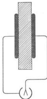
Abb. 89. Dielektrikum im Felde eines Plattenkondensators.
