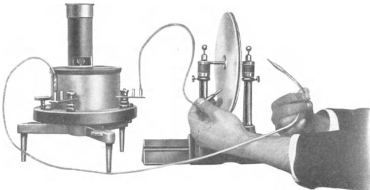
Abb. 49. Technische Ausführung des Versuches von Abb. 48. Links ein hochempfindlicher Drehspulstrommesser (Spiegelgalvanometer) auf einem Eisenfuß. Durch das rechteckige Fenster am Fuß des Turmes sieht man den Spiegel, der den Lichtzeiger auf die Skala wirft. Die Schwingungsdauer  $T$  dieses Galvanometers beträgt ca. 34 Sekunden. — Rechts der Plattenkondensator mit ca. 1,5 mm Plattenabstand. — Zahlenbeispiel siehe später in § 15.
