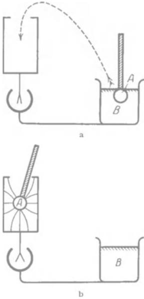
Abb. 94 a, b. Nachweis des elektrischen Feldes in der Grenzschicht von Paraffin *A* und Wasser *B*.
