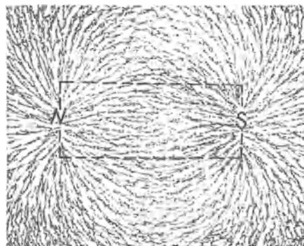
Abb. 121 b. Magnetische Feldlinien zwischen den Spulen eines Spulenbündels.
