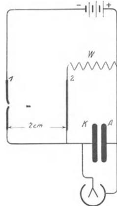
Abb. 65. Messung der Geschwindigkeit einer Pistolenkugel.
