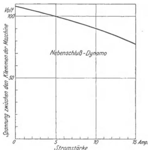
Abb. 187. Kennlinie einer Nebenschlußdynamo.
