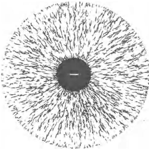
Abb. 104. Von einer Kugel ausgehende radialsymmetrische elektrische Feldlinien.
