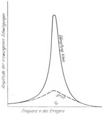
Abb. 358. Resonanzkurve bei kleiner und bei großer Dämpfung.
