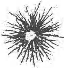
Abb. 87. Elektrischer Fleck (Lichtenbergische Figur).
