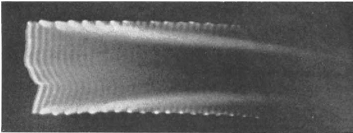
Abb. 227. Nachweis elektrischer Schwingungen mit Hilfe eines Funkens. („Feddersen-Funken“. Aufnahme von B. Walter.)
