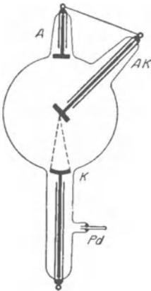
Abb. 268. Röntgenrohr mit Gasfüllung und hohlspiegelförmiger Kathode.
