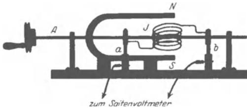
Abb. 177. Wechselstromgenerator mit Außenpolen.
