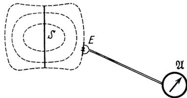
Abb. 377. Der Verschiebungsstrom eines Dipols, Momentbild der Verteilung des elektrischen Feldes.
