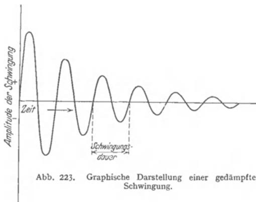
Abb. 223. Graphische Darstellung einer gedämpften Schwingung.
