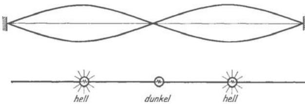
Abb. 367. Ein Dipol in erster Oberschwingung.
