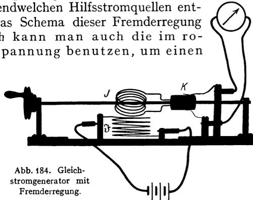
Abb. 184. Gleichstromgenerator mit Fremderregung.
