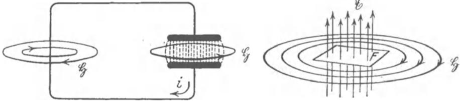
Abb. 154. Schema für das Magnetfeld von Leitungsstrom und
