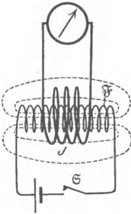
Abb. 139. Verkleinerung der induzierten Voltsekunden durch rückläufige Feldlinien einer gedregenen Feldspule  $\mathfrak{F}$ .
