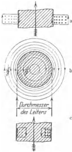
Abb. 233 a—c. Magnetische Feldlinien in der Umgebung und im Innern eines schraffierten Drahtes und ihre Induktionswirkung.
