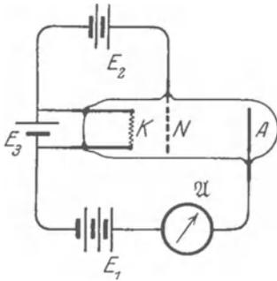
Abb. 254. Dreielektrodenrohr.
