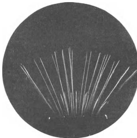
Abb. 339.  $\alpha$ -Strahlen von Thorium C und Thorium C' in Luft.
