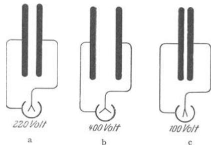
Abb. 44 a—c. Änderung der Spannung durch Längenänderung der Feldlinien
