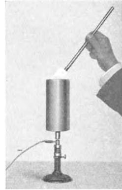
Abb. 67 a, b. Sitz der Elektrizitätsatome auf der Oberfläche eines fast allseitig geschlossenen Kastens  $\mathfrak{K}$ .
