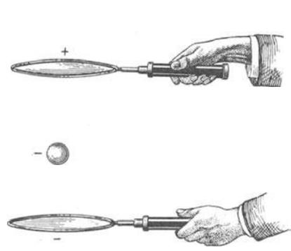
Abb. 116b. Eine geladene Seifenblase im elektrischen Felde schwebend.
