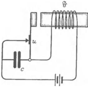
Abb. 220. Löschorrichtung für den Lichtbogen des Hammerunterbrechers.
