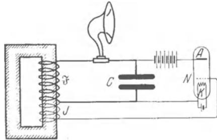
Abb. 354. Selbststeuerung eines elektrischen Schwingungskreises hörbarer Frequenz mit dem trägheitslosen Elektronenschalter.
