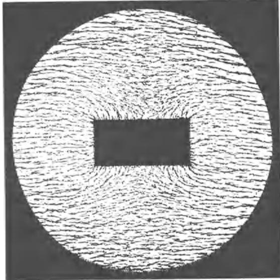
Abb. 131. Rechteckiges Eisenstück in einem zuvor homogenen Magnetfeld. Scheinbare Influenz.
