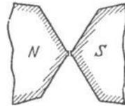
Abb. 163. Polschuhe eines Elektromagneten zur Herstellung einer großen Kraftflußdichte.
