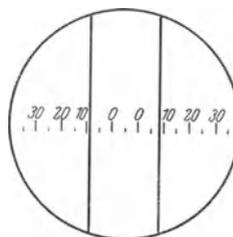
Abb. 24 b. Gesichtsfeld eines Zweifadenvoltmeters.
