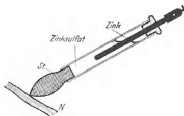
Abb. 323. Unpolarisierbare Elektrode.
