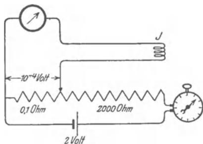
Abb. 136 a. Ein Drehspulgalvanometer mit eingeschalteter Induktionsspule  $J$  (vgl. Abb. 135, 137 ff.) wird zur Messung von Spannungsstößen in Voltsekunden geeicht.
