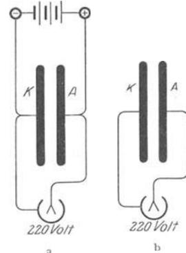
Abb. 35 a, b. *KA* Plattenkondensator, a in, b nach Verbindung mit der städtischen Zentrale.
