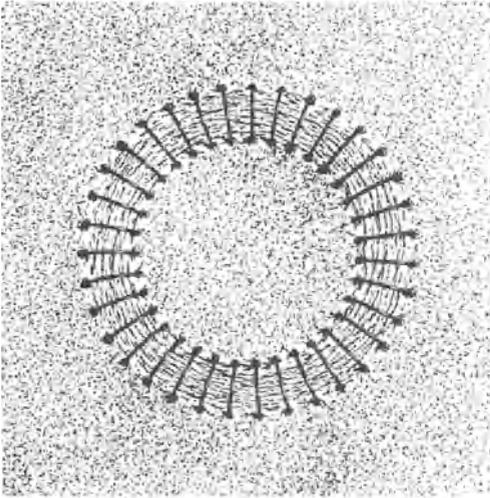
Abb. 123. Magnetische Feldlinien im Felde einer Ringspule.
