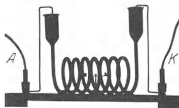
Abb. 12. Eine Kompaßnadel im Magnetfeld einer stromdurchflossenen Flüssigkeitsspirale.
