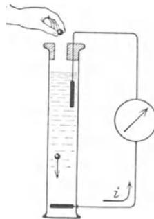
Abb. 310. Konvektionsstrom in einer Flüssigkeit, Strömungsstrom. Galvanometer wie in Abb. 49 und 60.
