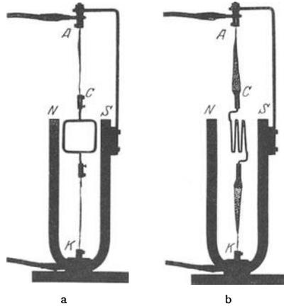
Abb. 8 a, b. Feststehender Hufeisenmagnet  $NS$  und drehbarer Leiter  $KA$  in Spulenform. Zuleitungen zur „Drehspule“ aus gewebtem Metallband. Zugleich Schema eines „Drehspulstrommessers“ oder „Drehspulgalvanometers“.
