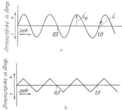
Abb. 149 a, b. Wechselströme, a mit sinusförmiger, b mit zackiger Kurve.
