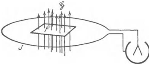
Abb. 145. Schema eines Induktionsversuchs mit einer Induktionsspule von nur einer Windung ( $n=1$ ).
