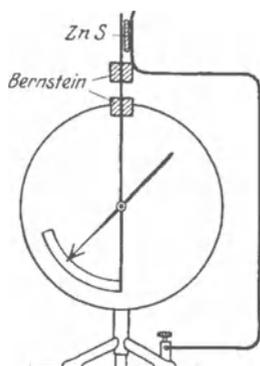
Abb. 301. Lichtelektrische Leitung hochisolierender Kristalle.
