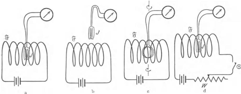
Abb. 137 a–d. Verschiedene Formen des Induktionsversuches. Die Induktionsspule  $J$  von kleinerem Querschnitt als die Feldspule  $\mathfrak{F}$  (vgl. Abb. 138 a und b).
