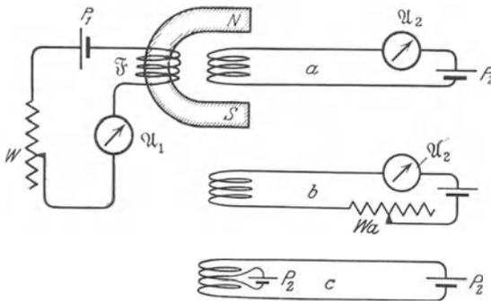
Abb. 200. Zum Induktionsvorgang im Läufer eines Motors.
