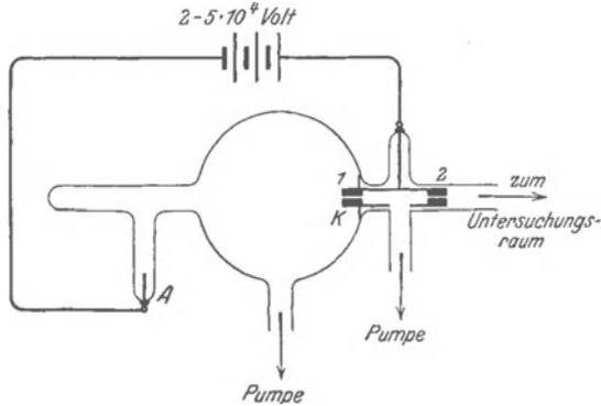
Abb. 270. Glimmladungsrohr zur Herstellung von Kanalstrahlen.
