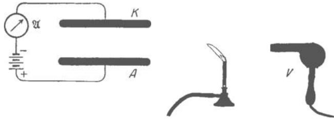
Abb. 244. Mitführung der von einer Bunsenflamme gebildeten Ionen durch den Luftstrom eines Ventilators. Galvanometer wie in Abb. 49 und 101.
