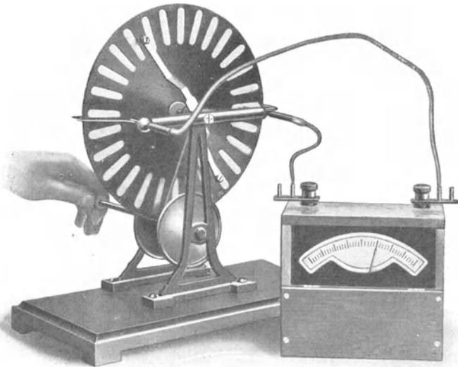
Abb. 32. Messung des von einer Holtzschen (!) Influenzmaschine gelieferten Stromes mit einem Drehspulampere-meter (Schema der Abb. 8).
