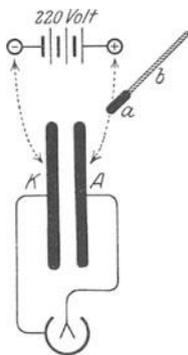
Abb. 45. Umfüllen elektrischer Substanzen von den Polen der städtischen Zentrale in die Platten eines Kondensators.
