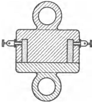
Abb. 172. Hubelektromagnet mit gutem Eisenschluß.
