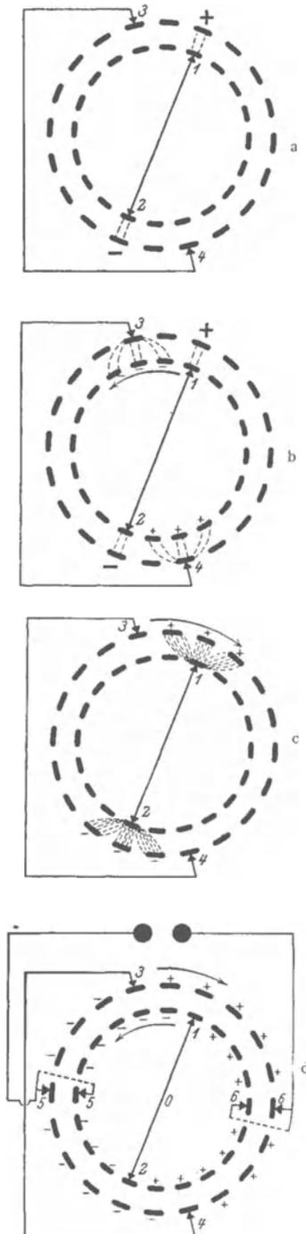
Abb. 84. Wirkungsweise der Holtz'schen Influenzmaschine.
