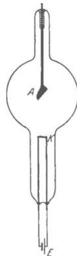
Abb. 253. Röntgenrohr mit Glühkathode im Hochvakuum.
