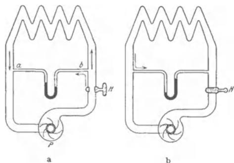
Abb. 207 a, b. Trägheit eines Wasserstromes in einer Rohrleitung.
