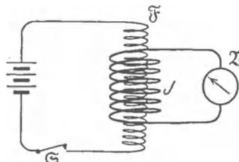
Abb. 166. Schema eines Induktionsversuches.
