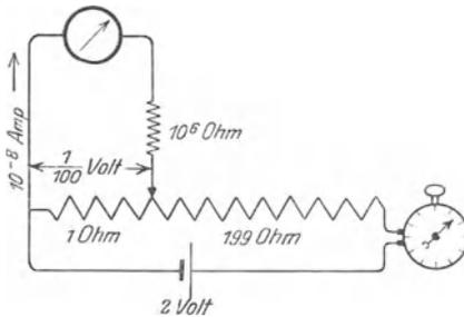
Abb. 56. Eichung der Stoßauschläge eines langsam schwingenden Strommessers in Amperesekunden.
