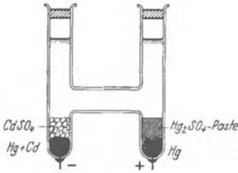
Abb. 324. Kadmiurnormalelement. Klemmspannung bei  $18^\circ = 1,0187$  Volt.
