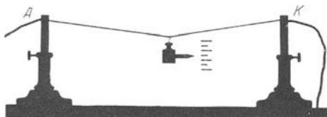
Abb. 11. Längenausdehnung eines vom Strom erwärmten Drahtes *KA*.
