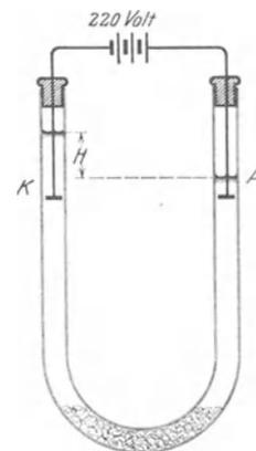
Abb. 307. Elektrophorese von Wasser durch einen porösen Stopfen.
