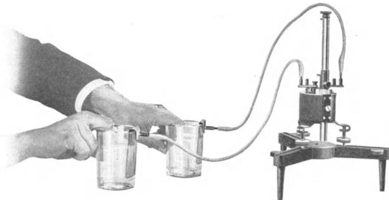
Abb. 33. Beobachtung schwacher Ströme beim Spannen der Fingermuskeln. Das Drehspulgalvanometer (Schema der Abb. 8) mit Spiegel und Lichtzeiger steht auf einem Eisenfuß. Das dargestellte Galvanometer ist durch eine besonders kurze Schwingungsdauer ausgezeichnet. Die Dauer *T* einer vollen (nicht halben!) Schwingung beträgt nur rund 4 Sekunden.
