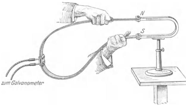
Abb. 144. Magnetischer Spannungsmesser im Felde eines permanenten Magneten.
