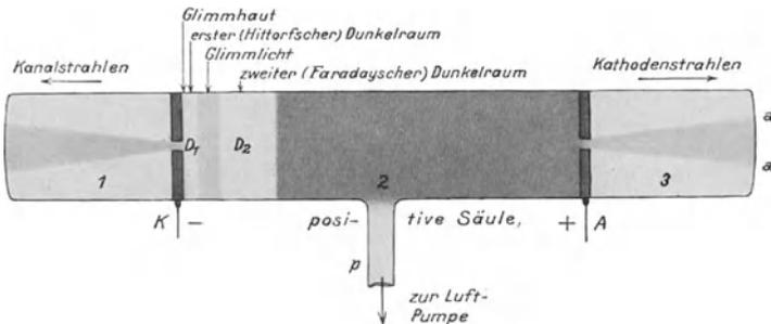
Abb. 257. Die charakteristischen Teile des Glimmstromes, halbschematisch.
