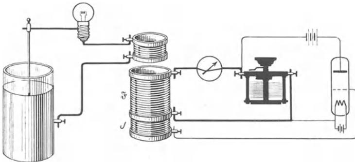
Abb. 359. Erzwungene elektrische Schwingungen, links Resonator, rechts Erreger.
