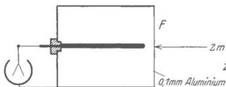
Abb. 333. Nachweis von  $\gamma$ -Strahlen
