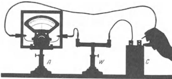
Abb. 58. Zeitlicher Verlauf des Feldzerfalles in einem technischen Papierkondensator C.
