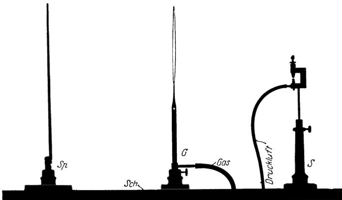
Abb. 385. Messung der Wellenlänge kurzer akustischer Wellen.
