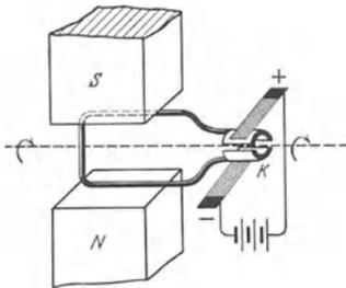
Abb. 199. Schema eines Gleichstrommotors.
