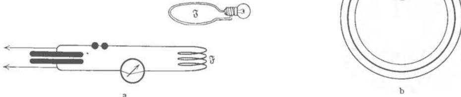
Abb. 234 a, b. Hautwirkung bei hochfrequentem Wechselstrom. Die mit Pfeilen angedeuteten Leitungen dienen zur Aufladung des Kondensators
