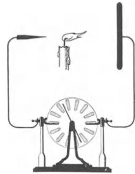
Abb. 274. Elektrischer Wind oder Ionenwind.
