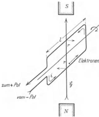
Abb. 176 a. Drehmoment auf eine stromdurchflossene Spule im homogenen Magnetfelde.
