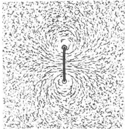
Abb. 117. Magnetische Feldlinien eines stromdurchflossenen Kreisringes, mit Eisenfeilicht sichtbar gemacht.
