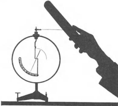
Abb. 86. Abstreichen der Elektrizitätsatome von der Oberfläche einer Siegellackstange
