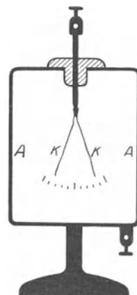
Abb. 25. Statischer Spannungsmesser oder statisches Voltmeter mit zwei Goldschaumzeigern *KK*.
