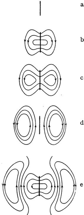
Abb. 387 a—e. Fünf Momentbilder des elektrischen Feldes in der Nähe eines Dipols.
