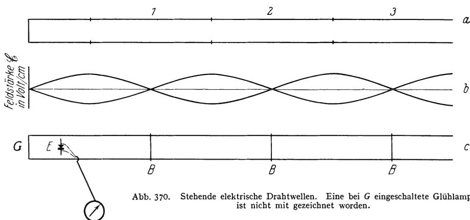
Abb. 370. Stehende elektrische Drahtwellen. Eine bei  $G$  eingeschaltete Glühlampe ist nicht mit gezeichnet worden.
