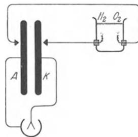
Abb. 52. Beim Feldzerfall durch einen Leitungsdraht zeigen sich in einem eingeschalteten flüssigen Leiter elektrolytische Wirkungen.
