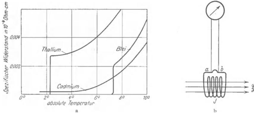
Abb. 298 a, b. Temperaturabhängigkeit des spezifischen Widerstandes in der Nähe des absoluten Nullpunktes. Supraleitung von Blei und Thallium.
