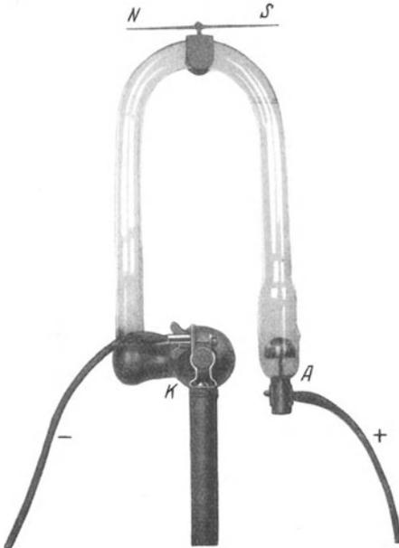
Abb. 15. Das Edelgas Neon als gasförmiger Leiter in einem U-förmigen Glasrohr.  $K$  und  $A$  metallische Zuleitungen.  $NS$  Kompaßnadel.
