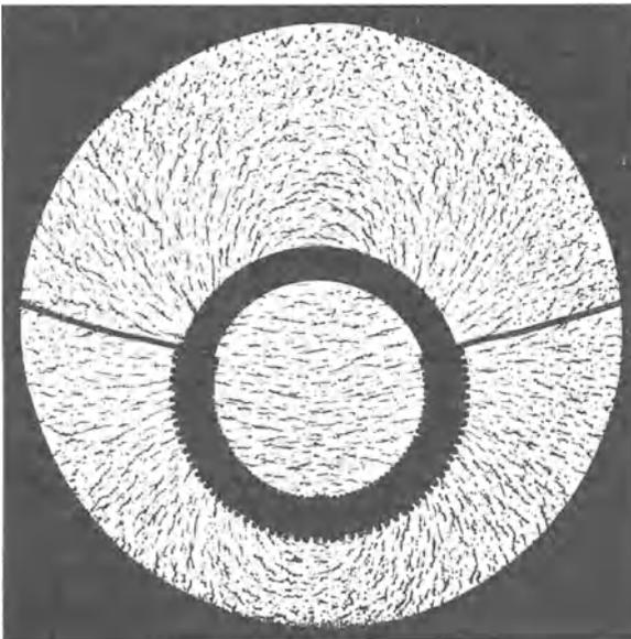
Abb. 158. Spule mit Eisenkern, der Kern noch geschlossen, die Spule offen
