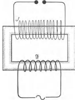
Abb. 212 a. Stromwandler für Wechselstrom mit geschlossenem Eisenkern.  $\sim$  = Wechselstromquelle
