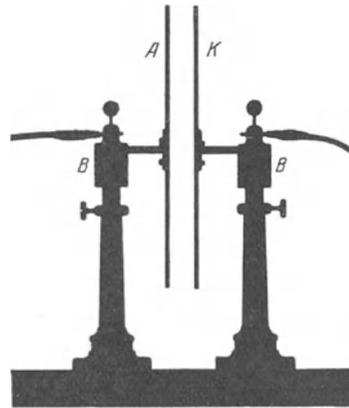
Abb. 34. Plattenkondensator mit Bernsteinisolatoren *B* im Lichtbild und im Schattenriß. Plattendurchmesser ca. 22 cm.
