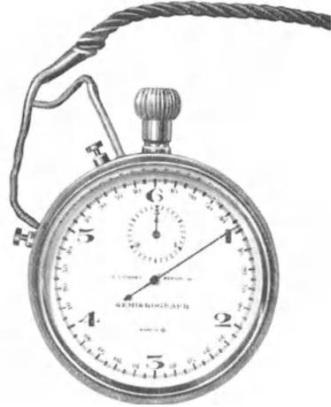
Abb. 57. Diese auf  $1/50$  Sekunde ablesbare Stoppuhr schließt einen Stromkreis während der Laufzeit ihres Zeigers. Sie ermöglicht die bequeme Herstellung bekannter Amperesekunden.
