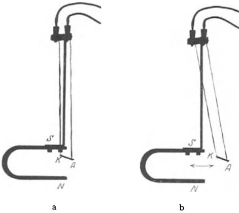
Abb. 7 a, b. Feststehender Hufeisenmagnet  $NS$  und beweglicher gerader Leiter  $KA$ , an gewebten Metallbändern trapezförmig aufgehängt. Zugleich Schema eines „Saitenstrommessers“ oder „Saitengalvanometers“.
