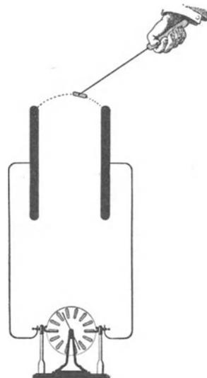
Abb. 113. Kräfte auf ungeladene Körper im elektrischen Feld.
