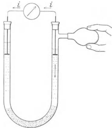
Abb. 311. Strömungsstrom beim Durchpressen einer Flüssigkeit durch einen porösen Stopfen.
