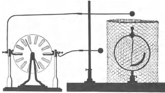
Abb. 76. Abschirmung eines elektrischen Feldes durch einen Käfig.
