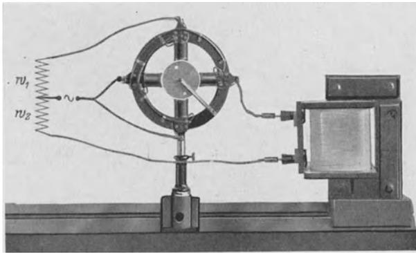
Abb. 211 c. Nachweis einer Phasenverschiebung durch Erzeugung eines Drehfeldes (Stromstärken einige  $10^{-1}$  Ampere).  $w_1, w_2$  Glühlampen als Vorschaltwiderstände.  $\infty$  = Wechselstrom,  $n = 50 \text{ sek}^{-1}$ .
