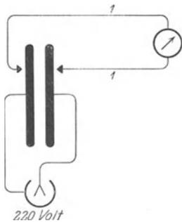
Abb. 48. Beim Feldzerfall durch einen Leitungsdraht  $I$  zeigt ein eingeschalteter Strommesser einen Stoßausschlag.
