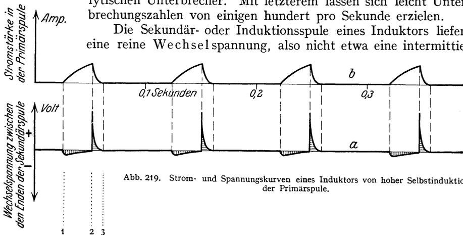
Abb. 219. Strom- und Spannungskurven eines Induktors von hoher Selbstinduktion der Primärspule.
