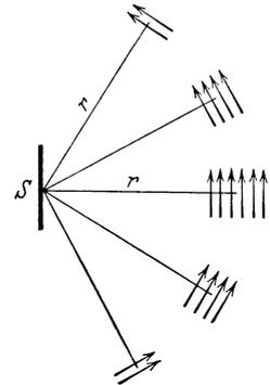
Abb. 381. Verteilung der Querkomponenten des Dipolfeldes in verschiedenen Richtungen.
