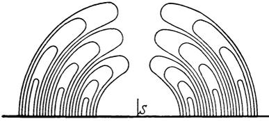
Abb. 389. Halbfreie elektrische Wellen auf einer leitenden Ebene.
