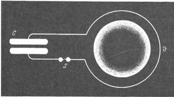
Abb. 235. Nachweis geschlossener elektrischer Feldlinien. („Elektrodenloser Ringstrom“.)
