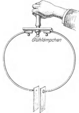
Abb. 360. Sehr einfacher geschlossener elektrischer Schwingungskreis zur Vorführung erzwungener elektrischer Schwingungen. Die Glühlampe dient als Indikator für den Wechselstrom im Drahtbügel.
