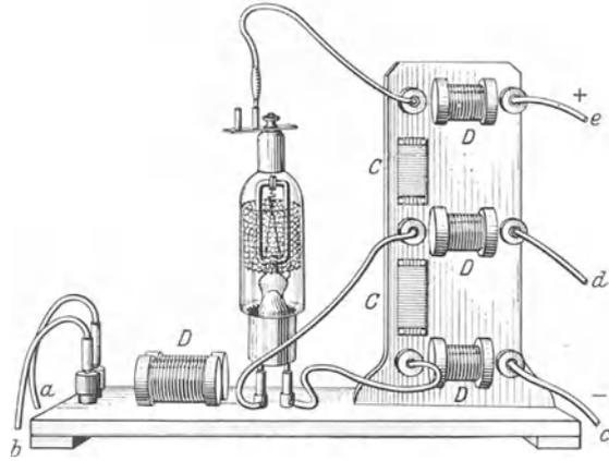
Abb. 356. Erzeugung ungedämpfter elektrischer Schwingungen einer Frequenz von etwa  $10^8 \text{ sek}^{-1}$ . Zwischen *c* und *e* ca. 400, zwischen *d* und *c* ca. 20 Volt. *a* und *b* Heizstromleitungen. *D* Drosselspulen. *C* Blockkondensatoren.
