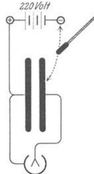
Abb. 47. Die positiven Elektrizitätsatome werden der linken Kondensatorplatte durch Leitung, die negativen der rechten Kondensatorplatte mittels eines „Elektrizitätsträgers“ zugeführt.
