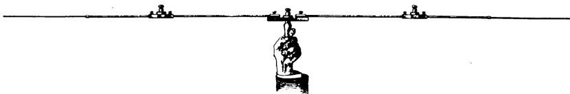
Abb. 366. Dipol mit drei Glühlampen zur Vorführung der Verteilung des Leitungsstromes in ihm.
