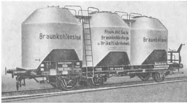
Abb. 99. Behälterwagen für blasfertigen Kohlenstaub.
