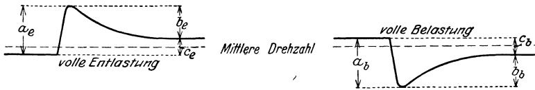
Abb. 347. Drehzahländerung für einen Entlastungs- und einen Belastungsvorgang mit Ungleichförmigkeit im Regler.
