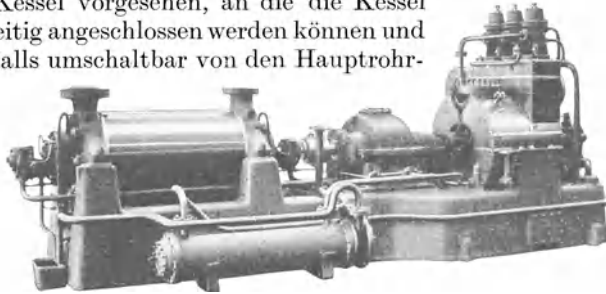
Abb. 212. Speisewasserpumpe mit Dampfturbinenantrieb und Getriebe.
