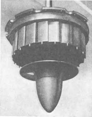
Abb. 336. Kaplanturbine, Leitapparat und Laufrad geschlossen.
