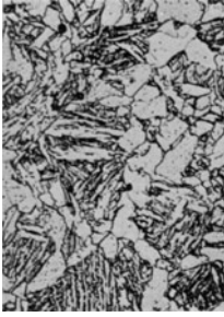
Ätzung: alkohol. Salpetersäure Bild 25 a. Stahl 10 V 0,5
