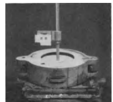
Abb. 199. Ausschablonierte Oberform und verwendete Schablone.
