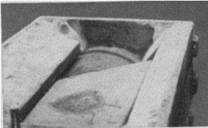
Abb. 34. Mittelkasten auf Unterkasten aufgesetzt; Wandstärke nachprüfen.
