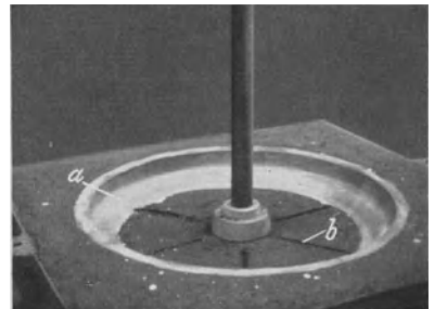
Abb. 117. Fertige Aufstampfform für den Oberkasten. a = mit Gips und Lack bedeckte Fläche; b = Anrißlinien.
