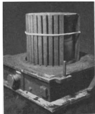
Abb. 24. Einbau der Kanalkerne mittels Gummiseil.
