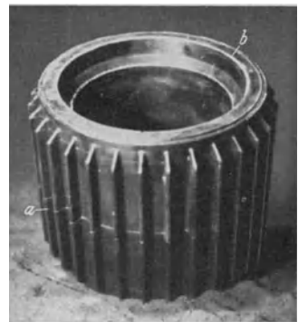
Abb. 19. Modell zum Motorgehäuse. a = Modellteilung; b = Kernmarke.
