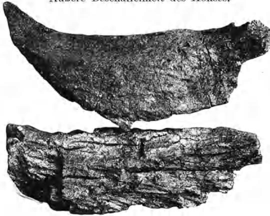
Abb. 27. Oben: Koks aus magerer Kohle; unten: Koks aus gasreicher Kohle.
