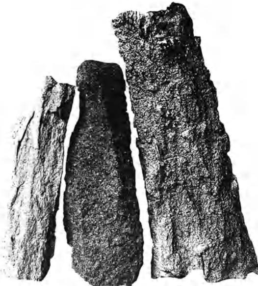
Abb. 29. Dichter, poröser und silberglänzender Bienenkorbofenkoks.
