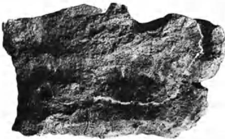
Abb. 25. Dichter Hochofenkoks, mit salzhaltigem Wasser gelöscht.
