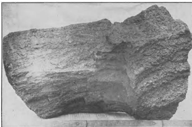
Abb. 43. Koks, bei ungleichmäßiger Wandtemperatur hergestellt.
