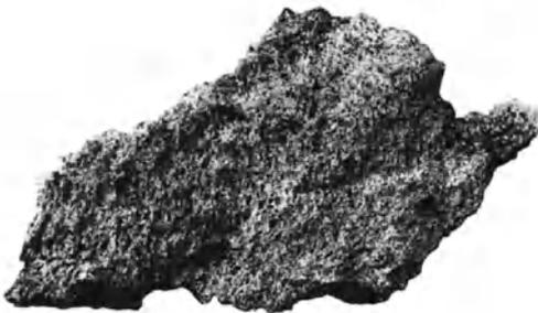
Abb. 26. Schaumiger Koks (nasse Kohle, heißer Ofengang).
