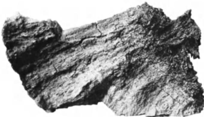
Abb. 32. Koks aus quellender Kohle mit poröser Spaltungsfläche in der Kokskuchenmitte.
