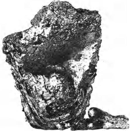
Abb. 2 Nierenförmiger Kohlenmelzfluß.
