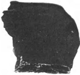
Abb. 22. Kohlenstoff aus zersetztem Äthylen.
