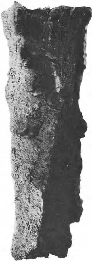
Abb. 23. Bienenkorbofenkoks mit Methan- und Äthylenkohlenstoff.
