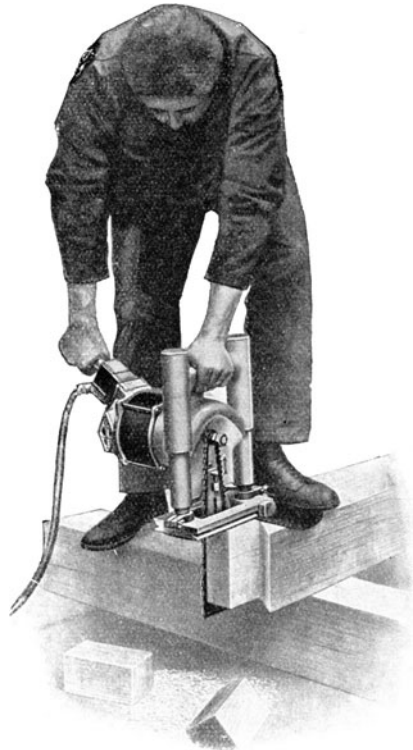
Abb. 53. Handmaschine wie Abb. 47; Fräskette mit unten horizontaler Führung (dreieckige Führungsleiste).
