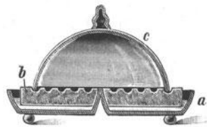
a = Glasteller. b = Keimplatte aus porösem Ton. c = Glasglocke.
