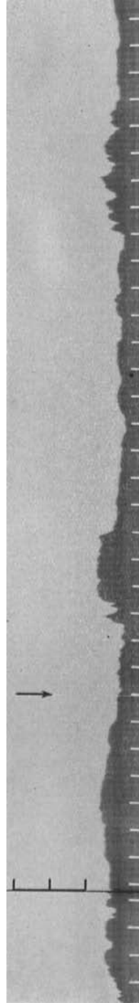
Abb. 49. 8. August 1927. 33° C. Mimosa pudica . Ableitung vom primären Blattstiel. Sonne bis zur schwarzen Marke, an der die Spannungseinheiten von 0,02 Volt angegeben sind. Pause von etwa 15 Minuten in tiefen Schatten; derselbe Schatten bis zum Pfeil, dann Sonne. Zeitmarken 10 sek. Aus UMRATH (5).]
