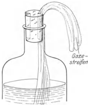
Abb. 71. Tropfflasche mit Gazestreifen. Der Kork hat 2 sich gegenüberliegende Einkerbungen.
