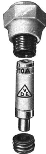
Abb. 291b. Stöpselkopf, Schmelzpatrone und Paßring der AEG.
