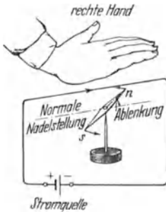
Abb. 4. Ablenkung der Magnetnadel.
