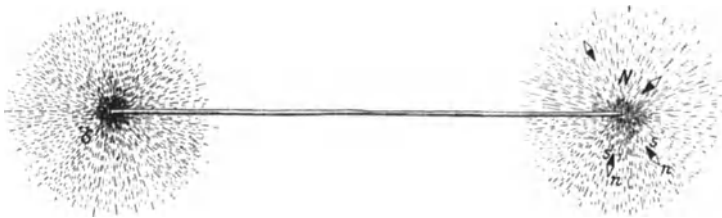
Abb. 20. Kraft- oder Feldlinien eines langen Stabmagneten.
