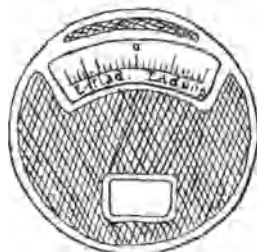
Abb. 369. Amperemeter für Akkumulatorenbetrieb. Nullpunkt in der Mitte.
