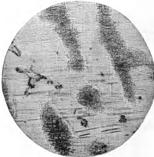
Abb. 96. Überhitzter, grobkörniger Rotguß. Geätzt mit Ammoniak getränktem Wattebausch. Lineare Vergr. 150.
