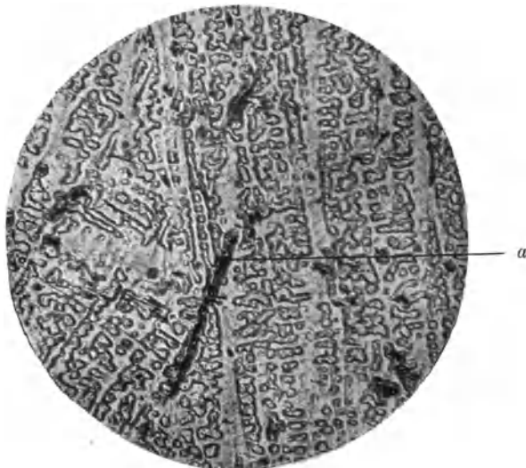
Abb. 7. Probestück, wie bei Abb. 6, aber geätzt. Ätzpoliert mit Ammoniakwattebausch. Lineare Vergr. = 50.
