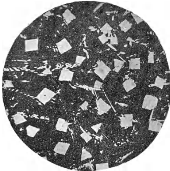
Abb. 13. Unter den üblichen Vorsichtsmaßregeln vergossenes, zinnsäure- freies Zinnweißmetall. Ätzung: heiße Schwefelsäure 1:1. Lineare Vergr. = 250.
