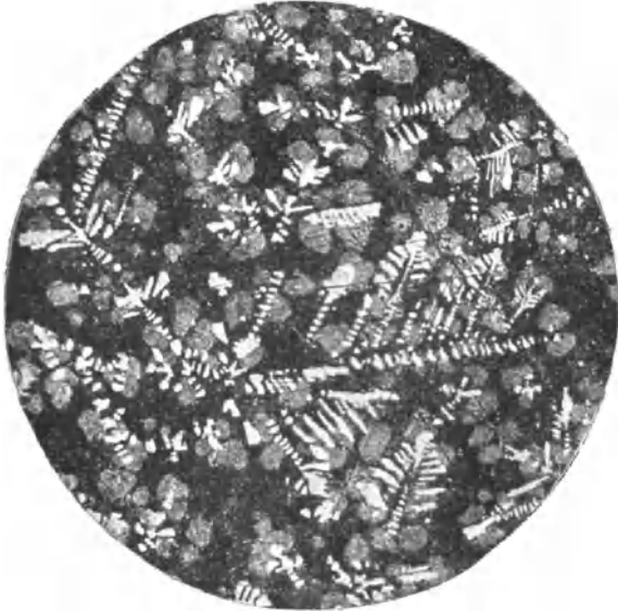
Abb. 17. Unter den üblichen Vorsichtsmaßregeln vergossenes Lurgilagermetall. Geätzt durch Anlaufenlassen an der Luft. Lineare Vergr. = 150.
