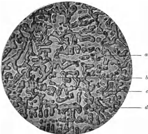
Abb. 86. Material wie in Abb. 85, aber stärker vergrößert. Ätzpoliert mit Ammoniak getränktem Wattebausch. Lineare Vergr. 75.
