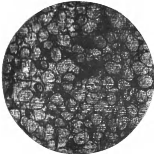
Abb. 18. Verbranntes Lurgilagermetall. Geätzt durch Anlaufenlassen an der Luft. Lineare Vergr. = 150.
