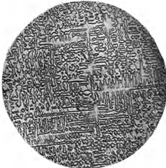
Abb. 9. Probestück, wie bei Abb. 8, aber geätzt. Ätzpoliert mit Ammoniakwattebausch. Lineare Vergr. = 50.
