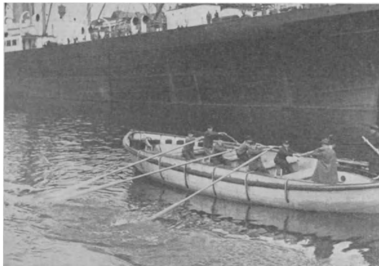
Abb. 10. Das mit einem Eisengewicht entsprechend 145 Personen belastete Boot wird durch 6 Mann gerudert.
