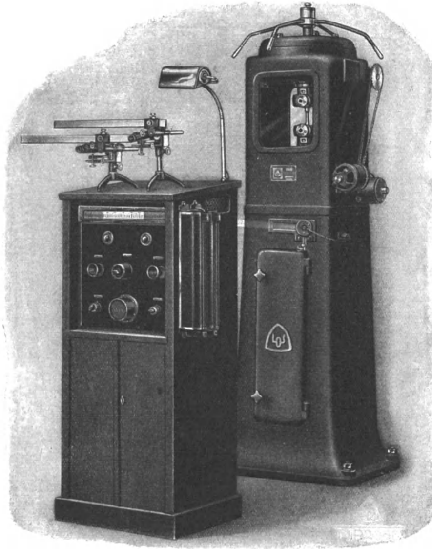
Abb. 1. Dauerprüfmaschine für kombinierte statische und dynamische Belastungen (Torsionswechselbelastung).
