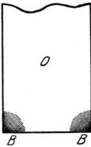
Abb. 14. Objektträger (O) mit bei B durch Anätzen aufgerauten Ecken.
