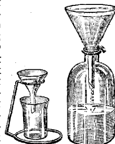
Рис. 6. Установки для фильтрования.
