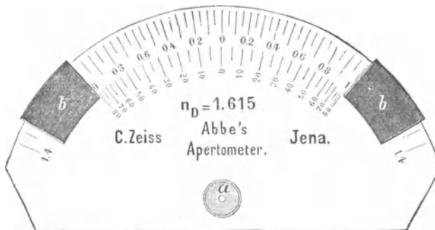
Abb. 53a. Apertometer nach ABBE. Ansicht von oben.
