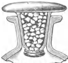
Abb. 183. Mit Ätzkalk gefüllter Glasstopfen für Pulverflaschen.
