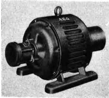
Abb. 71. Alnico-Bremswächter am Lager-schild eines Motors (AEG.).
