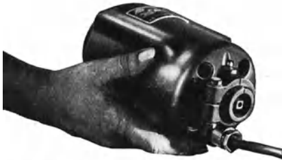
Abb. 78. Sondermotor für hohe Drehzahlen. 1 PS bei 21000 U/min (Sachsenwerk).
