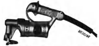
Abb. 98. Schnellfrequenz-Blechscherer schneidet Blech bis 1,5 mm Stärke (Bosch).
