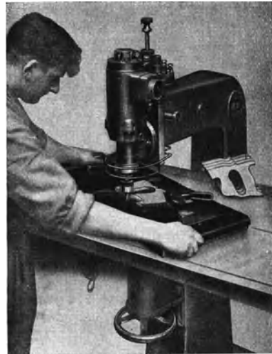
Abb. 85. Fuchsschwanzgriffschablone in Arbeitsstellung (Elze & Heß). Die Schablone hat auf der Unterseite eine Aussparung, in der die Kopierrolle läuft. Vorschub von Hand. Ungefähr 3...4 m/min.
