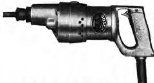
Abb. 99. Schnellfrequenz-Schrauber bis 8 mm Schrauben ohne Vorbohren in Holz (Bosch).
