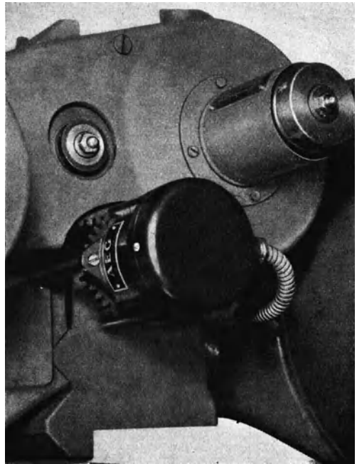
Abb. 72. Alnico-Bremswächter über ein Getriebe mit der Motorwelle verbunden (AEG.).
