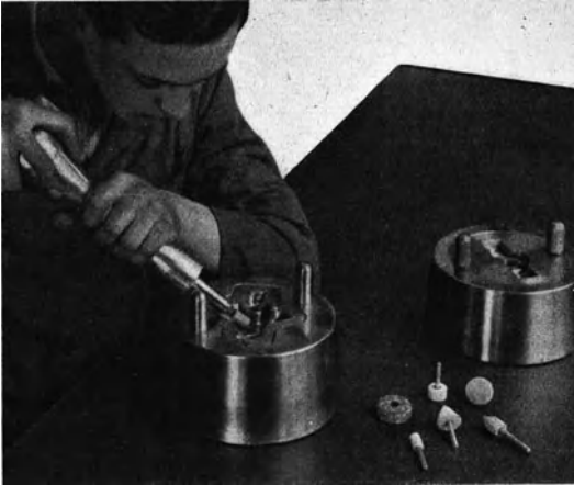
Abb. 4. Preßluftwerkzeug „Schleifhexe“. 60 000 U/min im Leerlauf. Für Schleifsteine bis 12 mm Durchm. (Rheinmetall-Borsig).
