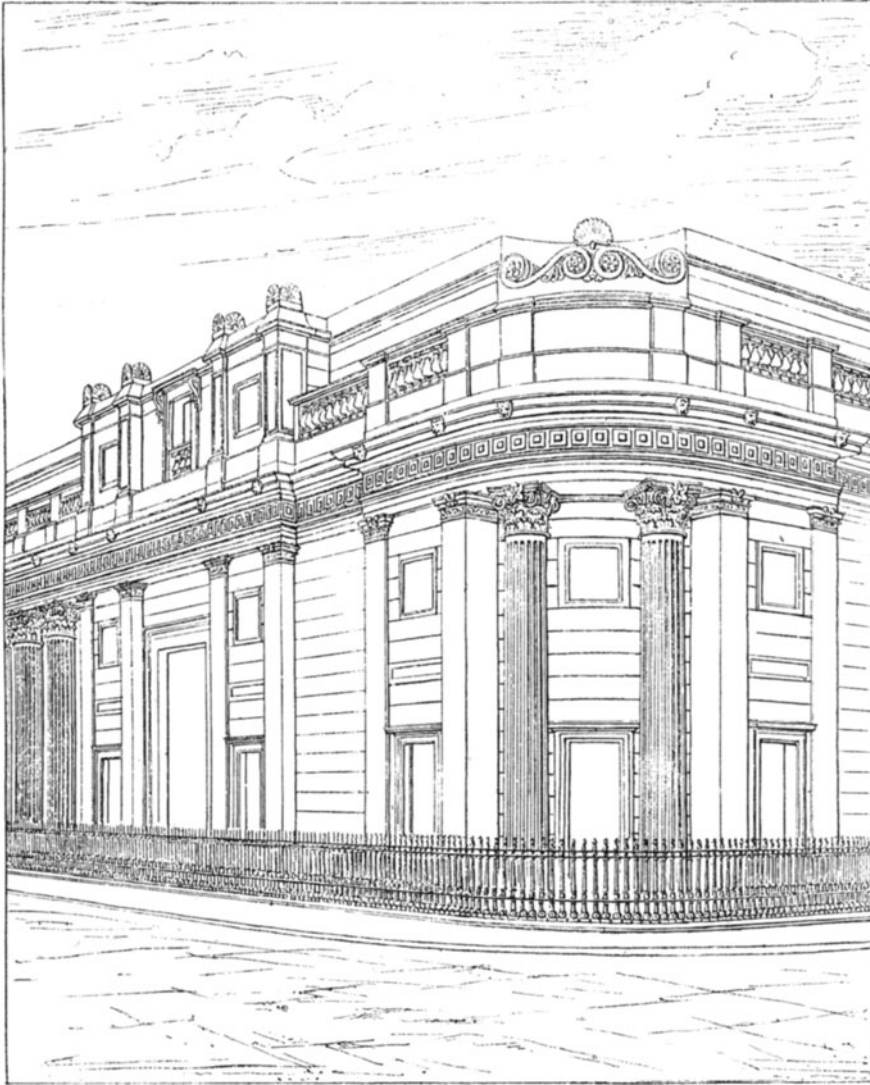
Fig. 330. Façadentheil der Bank von England.
