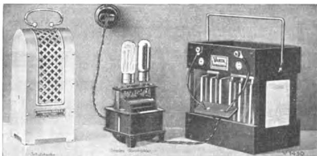
Abb. 61. Simplexgleichrichter mit abgenommener Schutzkappe beim Laden einer Heizbatterie.
