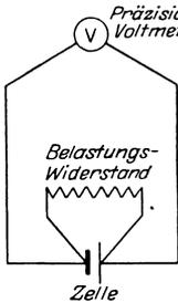
Abb. 25. Prüfbelastung einer Sammlerzelle.
