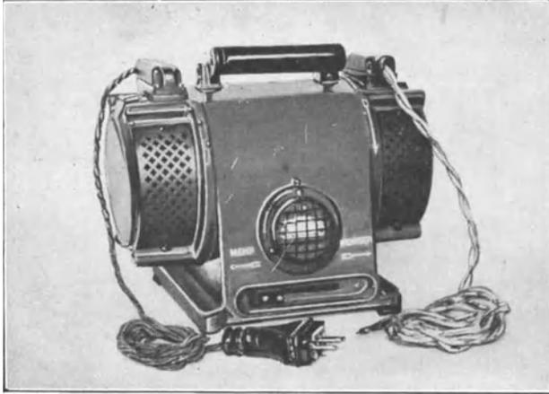
Abb. 119. Lorenz-Gleichstrom-Gleichstrom-Einankerumformer.
