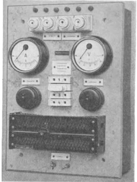
Abb. 167. Gleichrichterladeschalttafel bis 10 A.
