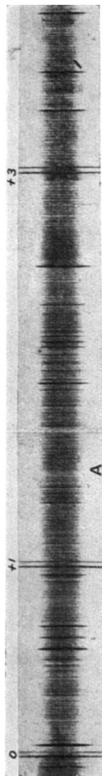
Abb. 14. 1.—3. Ordnung im Resonanzspektrum des Joddampfes bei Erregung mit der Linie 5462. Darunter das kannelierte Bandenspektrum.
