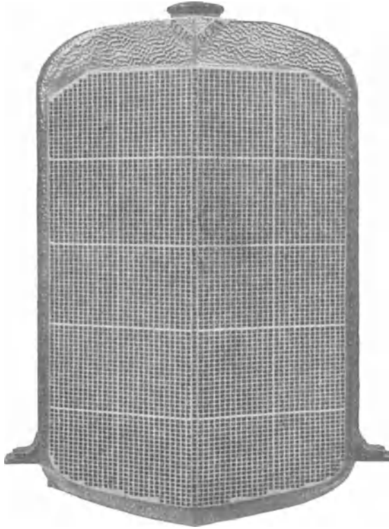
Abb. 95. Kühler (ausgeführt von der Windhoff A.-G. Berlin) mit geraden wag- und senkrechten Wasserkanälen, meist als sogenannter Bienenkorbkühler bezeichnet; oben die Einfüllöffnung, unten links und rechts die Pratzen zur Befestigung am Wagenrahmen
