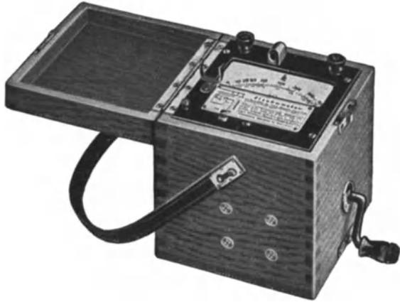
Abb. 285. Fixohmmeter (H. & B.).
