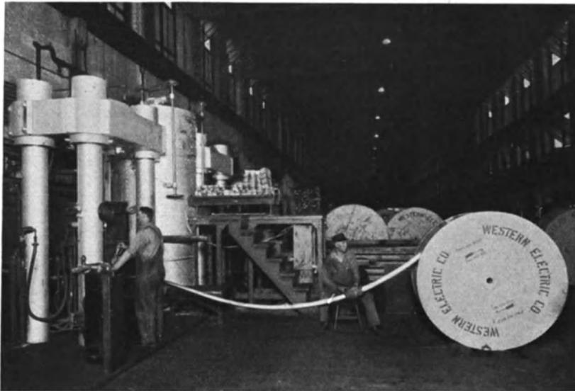
Abb. 212. Bleipressen des Kabelwerks Hawthorne (WEC).
