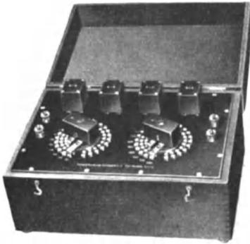
Abb. 317. Variable Eichleitung in H-Schaltung (F. & G.).
