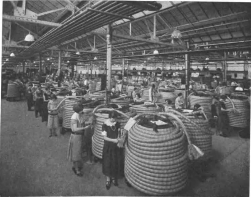
Abb. 250. Kontrolle der Telephonkabel vor dem Trocknen im Kabelwerk Hawthorne (WEC).
