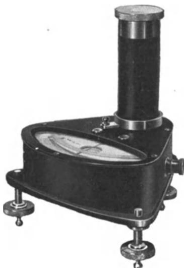
Abb. 280. Drehspulgalvanometer mit Fadenaufhängung und Zeigerablesung (L. & S.).
