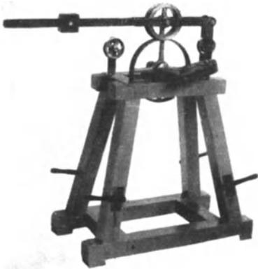
Abb. 174. Längenmeßuhr für dünne Kabel (Knefel).
