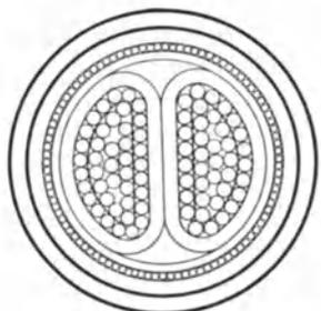
Abb. 24. Kombiniertes Dreileiterkabel (St. E. C.).
