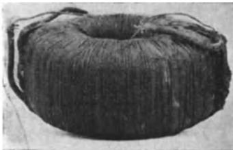
Abb. 103. Fertig bewickelte Pupin-Spule mit gepreßtem Eisenpulverkern (WEC).
