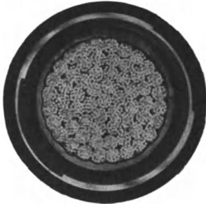
Abb. 111. Biegsames Kabel mit Kautschukmantel, Bandeisenermierung und doppelt verseilter Litze:  $1000 \text{ mm}^2 = 61 \times 19 \times 1,05 \text{ mm}$  (Pirelli).
