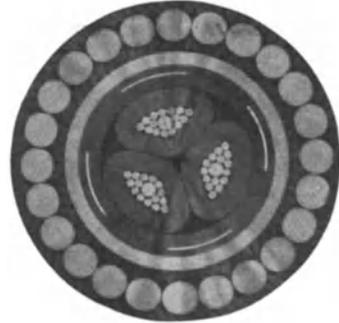
Abb. 416. Hochspannungs-Seekabel mit vier Kupferbändern in der Gürtelisolierung zur rechtzeitigen Ankündigung von Bleimantelfehlern (Sumitomo Draht- und Kabelwerke, Osaka).
