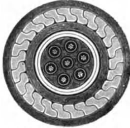
Abb. 33. 7-adriges Guttapercha-Telegraphenkabel mit Profildrahtarmierung im St. Gotthardt-Tunnel (F. & G.).
