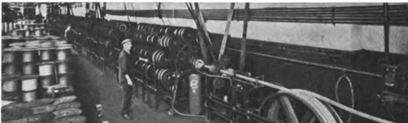
Abb. 241. Vielkörbige Telefonkabelverseilmachine ohne Rückdrehung (St. E. C.).
