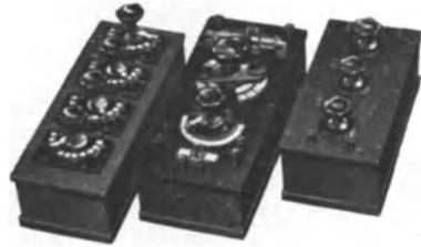
Abb. 333. Brückenkasten ( $W_5$ ,  $S$ ), Regulierwiderstand ( $W_3$ ) und Regulierkondensator ( $K_4$ ) für die Schering-Brücke nach Abb. 330 (H. & B.).
