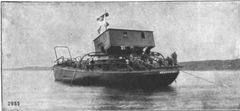
Abb. 444. Montage der  $3 \times 50$  kV-Seekabelmuffe von F. & G. Herausholen der fertig montierten Muffe aus dem aufgekippten Montagehaus.
