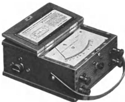
Abb. 282. Kreuzspulohmmeter (H. & B.).
