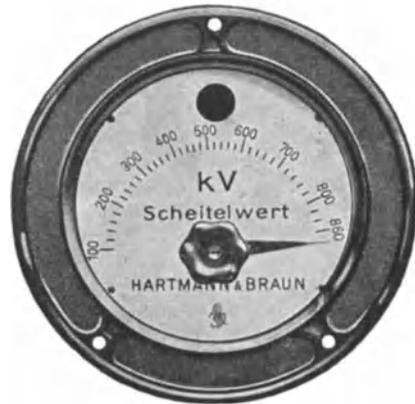
Abb. 355. Scheitelspannungsmesser (H. &amp; B.).
