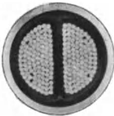
Abb. 14. Verseiltes Zweileiterkabel mit segmentförmigen Leitern (Pirelli).
