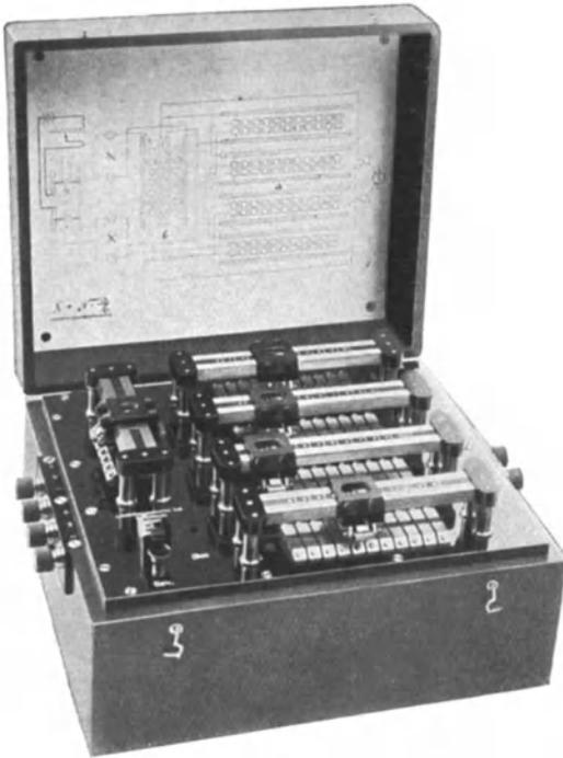
Abb. 279. Präzisions-Thomson-Brücke mit Schieberwiderständen (L. & S.).
