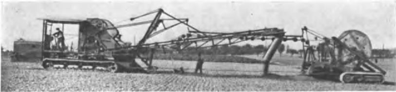
Abb. 393. Gesamtansicht der Schrammschen Kabelverlegungsmaschine (Eisenwerk Weserhütte).
