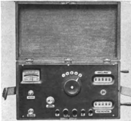
Abb. 290. Kabelmeßapparat von V. Planer (NKW).
