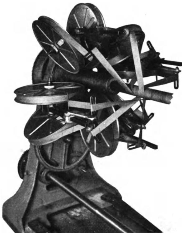
Abb. 179. Achtefacher Tangential-Papierbandspinner (Krupp-Grusonwerk).
