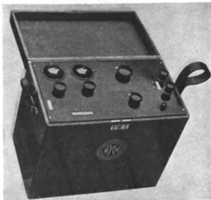
Abb. 327. Gerät für Fehlerortsbestimmung mit Wechselstrom nach Planer (NKW).
