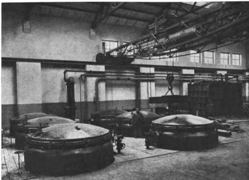
Abb. 192. Vakuumtrocknungsanlage in einer Kabelfabrik (Pintsch).
