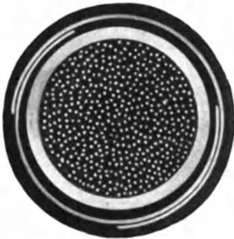
Abb. 31. 250-paariges Telephonkabel mit Bandeisenarmierung (Pirelli).
