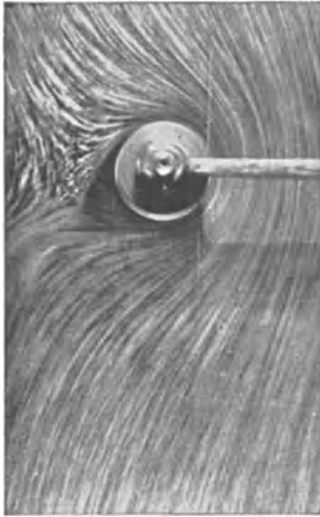
Abb. 161. Strömung um einen rotierenden Zylinder. (Nach PRANDTL.)
