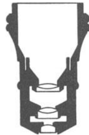
Abb. 495. Beispiel eines Mikroskop-Objektivs.
