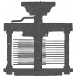
Abb. 270. Drehkondensator. (Aus POHL: Elektrizitätslehre.)
