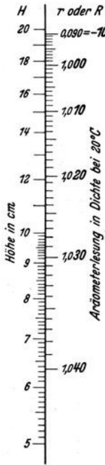
Abb. 10. Beispiel für den Entwurf der R-, r-Skala in Abb. 11.
