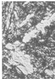
Abb. 85. V = 500 . Abb. 86. V = 300 . Abb. 87. V = 1 . Abb. 85. Austenit (hell) in Martensit. C-Werkzeugstahl mit 1,2% C (s. Abb. 15), von 950° in Wasser abgeschreckt. — Abb. 86. Austenit mit Zwillingsstreifen. Feine Karbidkörnerchen (dunkel) in den primären Korngrenzen. Ätzung: Pikrinsäure + HCl. Warmfester Stahl mit 14,5% Cr, 12,5% Ni, 2% W. Turbinenschaukel. — Abb. 87. Sorbitischer Kern (dunkel) in nicht durchhärtendem Stahl wie Abb. 15. Zonenbildung des Martensits (Querschliff).
