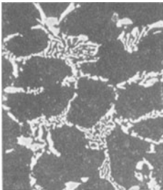
Abb. 48. Grenzgefüge mit ledeburitähnlichem Eutektikum (hell, gemustert). Schnellstahlblock. Gußgefüge. (Nach RAPATZ, Edelstähle.)
