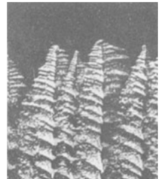
Abb. 57. V = 100 . Tannenbaum- (Wachstums-) Kristalle aus einem Stahlgußlunker. Hauptwachstumsrichtungen nach oben, nach vorn und zur Seite.
