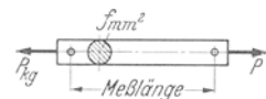
Abb. 7. Zugversuch. Zugspannung \sigma = P/f \text{ kg/mm}^2 , \sigma_P = Streckgrenze, \sigma_B = Zugfestigkeit, \delta = Bruchdehnung.
