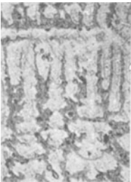
Abb. 176. V = 100 . Sn-Gußbronze (GBz 20 nach DIN 1705) mit 20% Sn. Ätzung: Amm.-Persulf. Gleitschiene. Bäumchengefüge. H = 150 \text{ kg/mm}^2 (vgl. Abb. 144).
