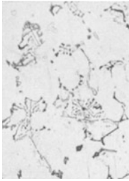
Abb. 166. V = 100 . Al-Mg-Sandguß. Bau- beschlagteil. Leg. (a) in Abb. 165. Eutektikum I dunkel. \sigma_B = 18 , \delta = 2,5 . H = 71 , \gamma = 2,630 . Ätzung: 10% NaOH, kalt.
