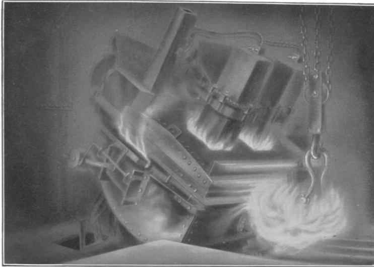
Héroult-Ofen. Ausgießen der fertigen Charge
