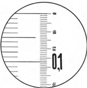
Abb. 416. Okular- und Objektmikrometer.
