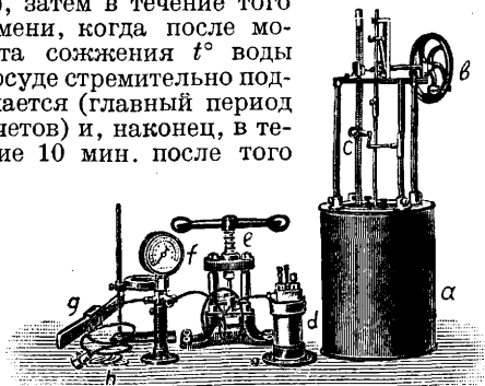
Фиг. 2. f —манометр для кислорода, e —пресс для таблетирования навески.
