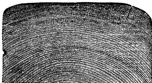
Фиг. 1. Поперечный разрез продольной сосновой балки, пропитанной базилитом и пролежавшей в шпране 11 лет.
