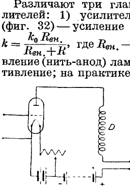
Фиг. 33. Схема усилителя с реактивной катушкой: D — реактивная катушка.
