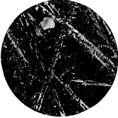
Фиг. 4. Микроструктура базальта, расплавленного и остеклованного при быстром охлаждении. Увел. 75.
