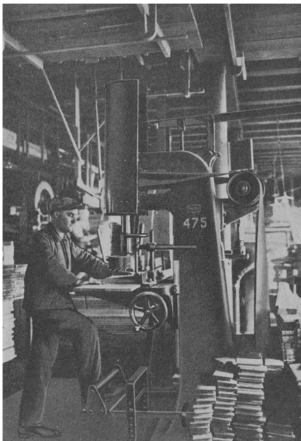
Abb. 471. Vertikalbohrmaschine mit Fußhebelbedienung. (Heckner & Co., Braunschweig, und Maschinenfabrik Kießling, Leipzig.)
