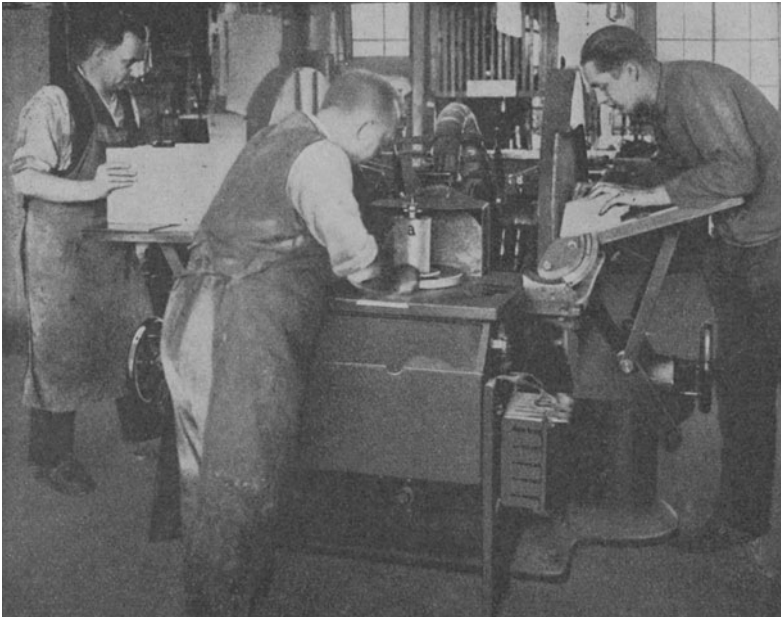
Abb. 441. Oliver-Sandpapierschleifmaschine mit zwei Schleifscheiben und einer senkrechten Schleifspindel. (Oliver Machinery Company, Grand Rapids, Michigan, U. S. A.)
