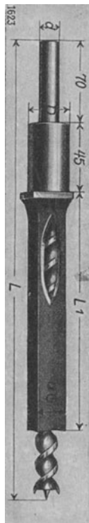
Abb. 460. Hohlmeißel mit Bohrer.
