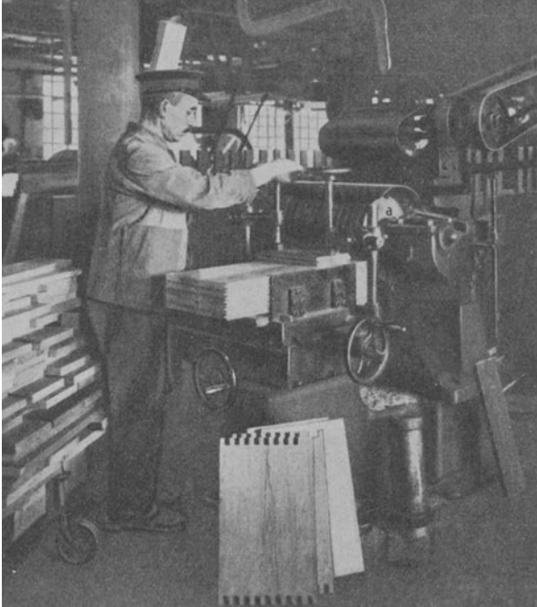
Abb. 412. Selbsttätig arbeitende Zinkenfräsmaschine mit wagerecht liegender Fräserwelle für gerade Zinken. (Maschinenfabrik Kiessling, Leipzig.)
