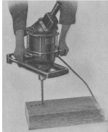
Abb. 469. Elektrischer Handkettenstempapparat als Handbohrmaschine verwendet.
