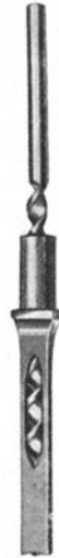
Abb. 488. Hohlmeißel mit Bohrer. (Oliver Machinery Company, Grand Rapids, Michigan, U. S. A.)
