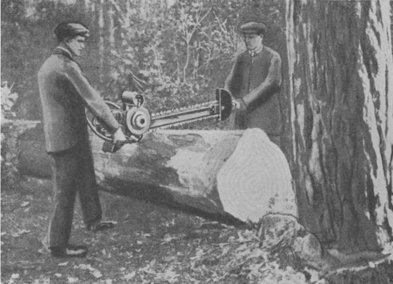
Abb. 6. „Rinco“ Baumfäll- und Ablängmaschine beim Ablängen. (E. Ring & Co., Berlin.)
