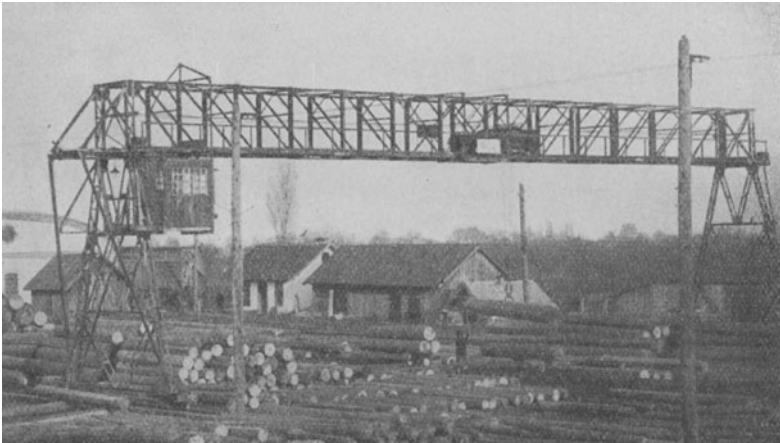
Abb. 86. Fahrbarer Bockkran mit elektrischem Antrieb und Rundholzgreifer, 30 m Stützweite, 5 t Tragkraft, ausgeführt von MAN-Werk Nürnberg für die Bosnische Forstindustrie Lazarak.
