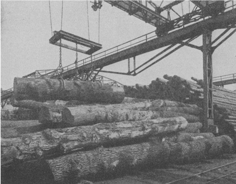
Abb. 87. Fahrbarer elektrischer Hebekran mit Greiferzangen, ausgeführt von MAN-Werk Nürnberg.
