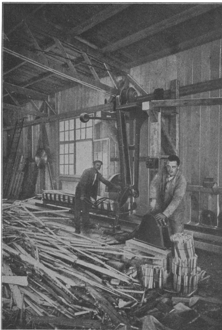
Abb. 120. Hängende Pendelsäge und Bündelpresse für Brennholz. (Gebr. Linck, Oberkirch in Baden.)
