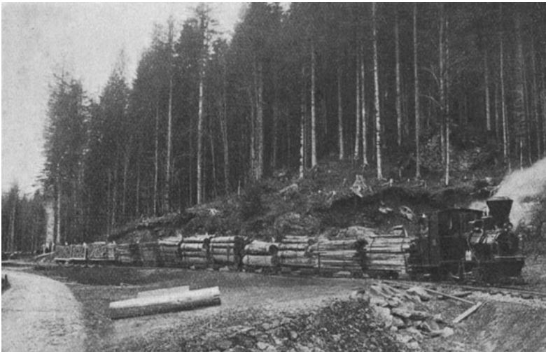
Abb. 54. Transport von Brettern, Stamm- und Scheitholz durch eine Waldbahn in den bayr. Staatsforsten. (Orenstein & Koppel A.-G., Berlin.)
