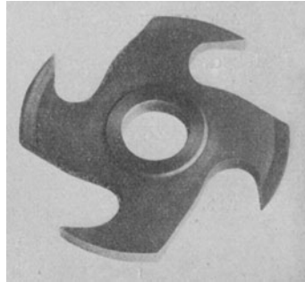
Abb. 414. Sehr sauber und leicht arbeitende Zinkenfräser zum Anschneiden von geraden Zinken. Durchmesser 125 mm, Stärke 10 mm, Bohrung 30 mm, Umdrehungen 3600 in der Minute.
