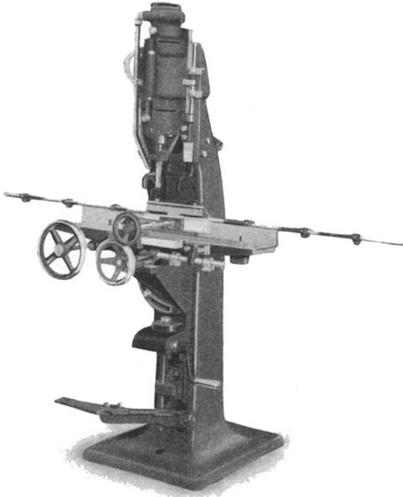
Abb. 487. Nr. 91 „Oliver“, Vertikal-Elektrohohlmeißelstemmaschine.
