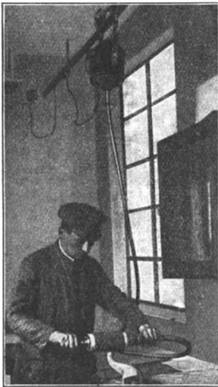
Abb. 521. Die „Biax“ als Rundschleifmaschine. Ein roh ausgesägte Barokfuß wird mit der Biax-Schleifmaschine fix und fertig bearbeitet.
