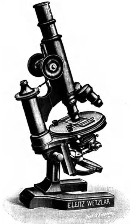
Abb. 10. Mikroskop von E. Leitz-Wetzlar. Stativ Ia mit Abbeschem Beleuchtungsapparat und Irisblende, 3fachem Revolver, Objekt 3, 6, 8, Okul. 1, 3; Vergröß. 60—550.
