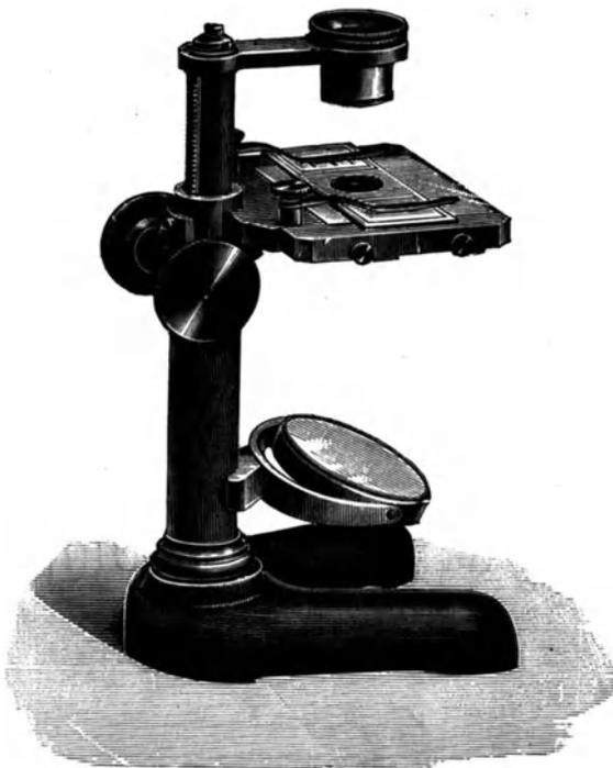
Abb. 5. Präpariermikroskop zum Bestimmen der Pflanzen, von E. Leitz, Wetzlar.
