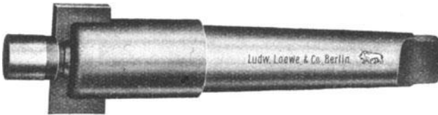
Fig. 115. Zapfensenker mit auswechselbaren Messern und Führungsbüchse.
