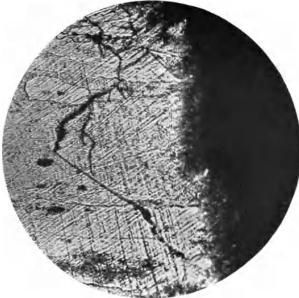
Abb. 53. Duralumin 20 nach Schwingungsbruch. Bruchstelle. Längsschnitt.  $\times 260$ .
