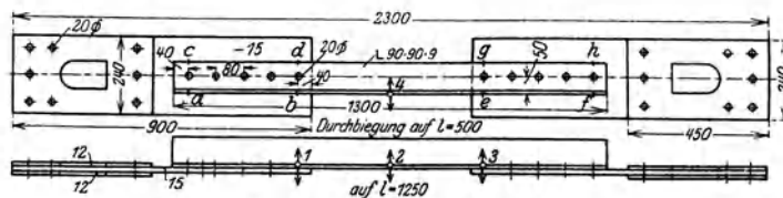
Fig. 17. Stab 54. F_{\text{netto}} = 15,5 - 2,0 \cdot 0,9 = 13,7 qcm. Q_{\text{niete}} = 5 \cdot 3,14 = 15,70 qcm.
