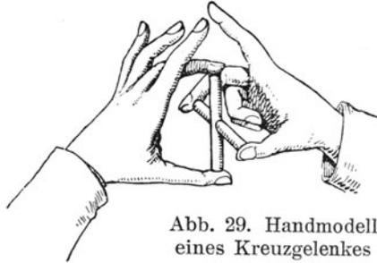
Abb. 29. Handmodell eines Kreuzgelenkes
