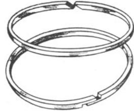
Abb. 41. Kolbenringe
