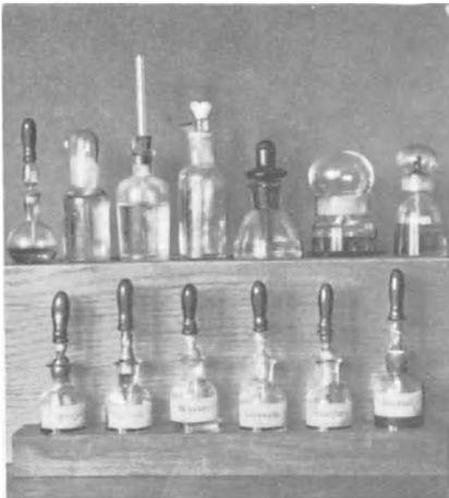
Abb. 271. Verschiedene Formen von Reagenzfläschchen für mikroskopische und mikrochemische Untersuchungen.
