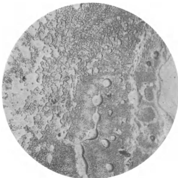
Abb. 173. Harzrückstand aus alkoholischer Lösung. Schiefes Licht. Vergr. 100.
