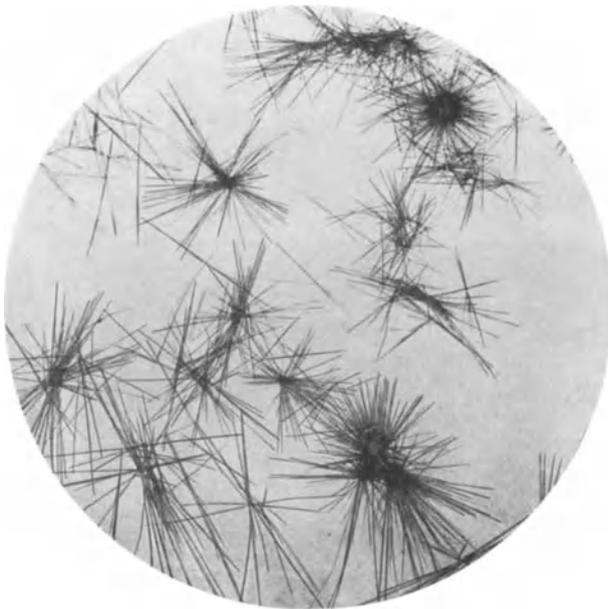
Abb. 235. Salpetersäurereaktion mit Nitron (Diphenylanilodihydrotriazol). Vergr. 100.
