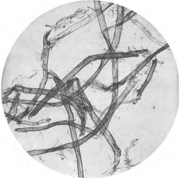
Abb. 2. Rösch gemahlene Baumwollfasern aus einem Filterpapier. Vergr. 100.
