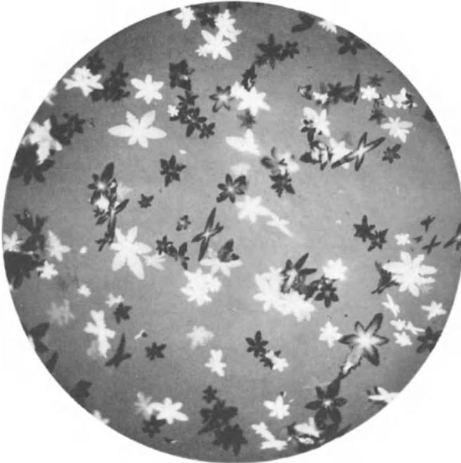
Abb. 30. Benzidinsulfat. Polarisiertes Licht: Nicols nicht vollständig gekreuzt. Vergr. 80.
