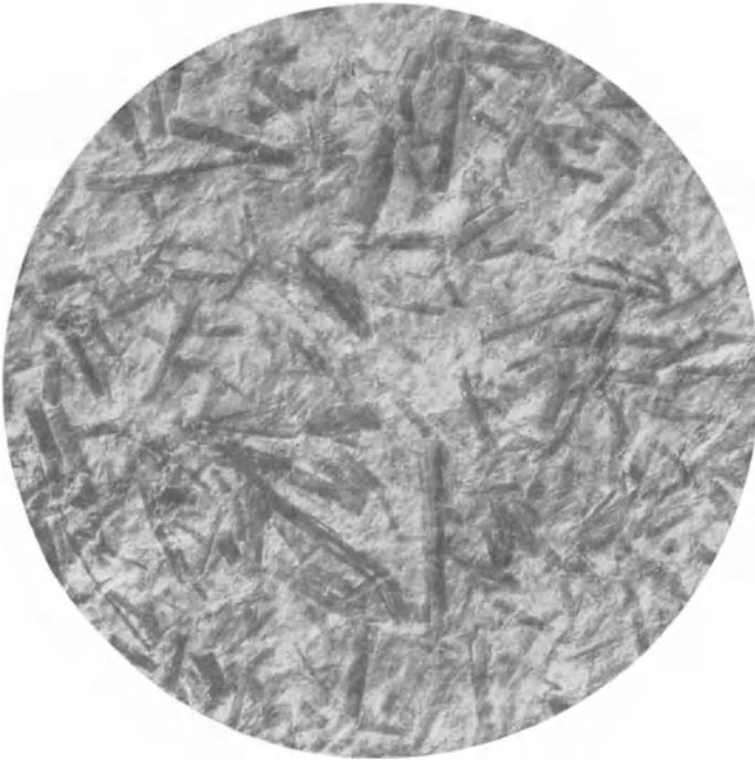
Abb. 256. Papier aus schlecht aufgeschlossenen Flachsscheben. Deutliches Hervortreten der Holzstücke. Auffallendes Licht. Vergr. 8.
