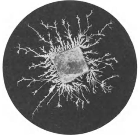
Abb. 207. Silber, aus einer verdünnten Silbernitratlösung mit metallischem Kupfer ausgefällt. Auffallendes Licht. Vergr. 8.
