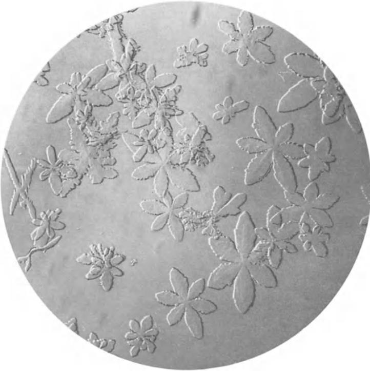
Abb. 28. Benzidinsulfat aus wässriger Lösung von Benzidin mit Schwefelsäure gefällt. Schiefe Beleuchtung, Vergr. 120.
