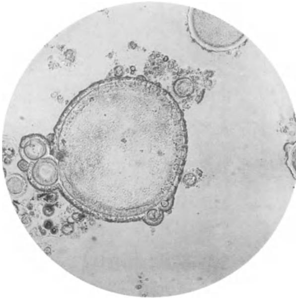
Abb. 182. Verseifungsprobe für Fette nach Molisch. Vergr. 76,6.
