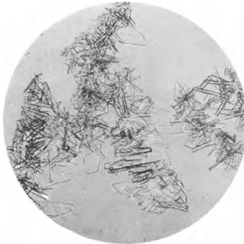
Abb. 32. Kalziumsulfat. Kruste nach dem Eindampfen. Vergr. 150.
