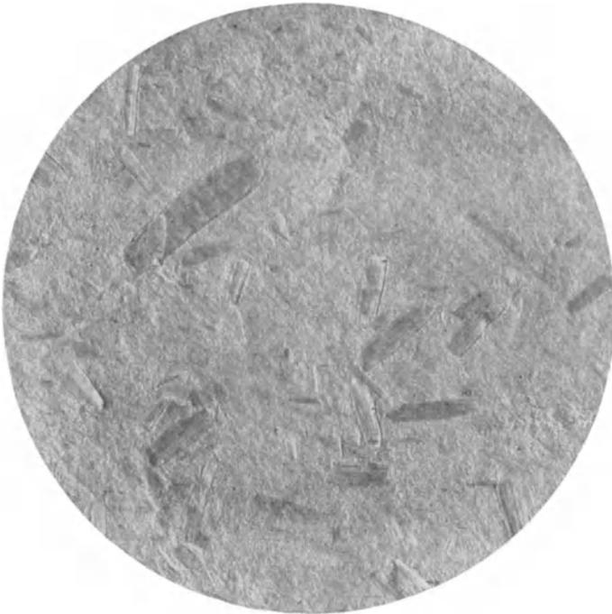
Abb. 257. Papier aus schlecht aufgeschlossenen Hanfscheben. Deutliches Hervortreten der Holzstücke. Auffallendes Licht. Vergr. 8.
