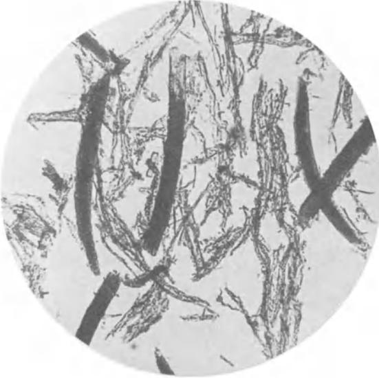
Abb. 8. Scheinkristalle von Kalziumkarbonat nach Kalziumoxalat in der Asche von Agavefasern.
