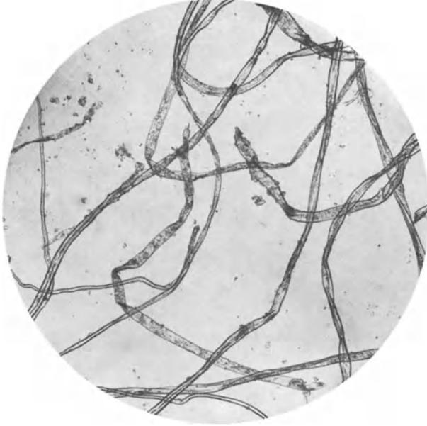
Abb. 1. Abfallbaumwolle aus der Vließauflage eines Claviez'schen Textilosegarnes mit aufgelagerten körnig-bröckligen Fremdstoffen. Vergr. 100.
