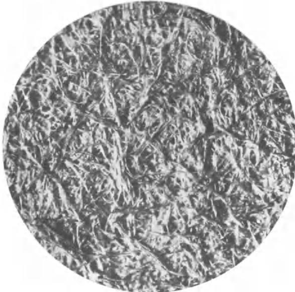
Abb. 3. Filterpapier in auffallendem Licht. Vergr. 100.
