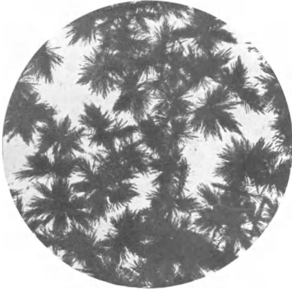
Abb. 37. Kalziumsulfat aus ziemlich konzentrierter Lösung gefällt. Vergr. 100.
