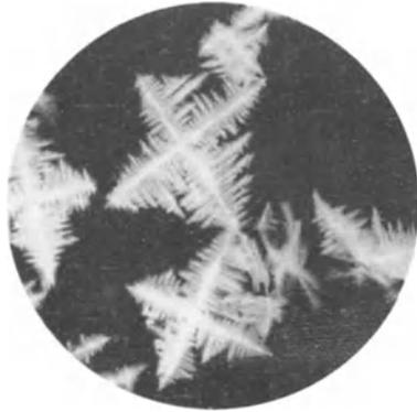
Abb. 102. Doppelverbindung von Zink- und Kuprimerkurithiozyanat. Dunkelfeldbeleuchtung. Ohne Deckglas. Vergr. 100.
