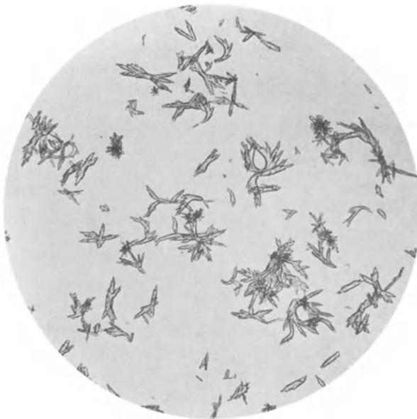
Abb. 97. Durch Ferrichlorid stark abgeänderte Kristallisation von Bariumoxalat. Vergr. 100.
