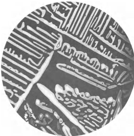
Abb. 242. Kaliumnitrat, skelettartig auskristallisiert, nach dem Anhauchen. Polarisiertes Licht:
