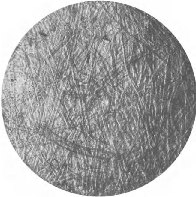
Abb. 261. Durch Wiederverarbeitung alten bedruckten Zellstoffpapiers vorhandene Reste von Drucker-
