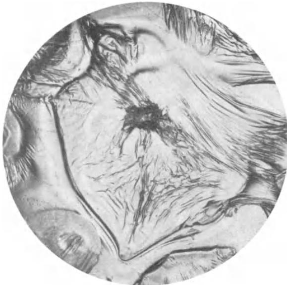
Abb. 206. Faltige Haut, durch Fällung einer wässrigen Lösung von arabischem Gummi mit Alkohol gebildet. Vergr. 100.
