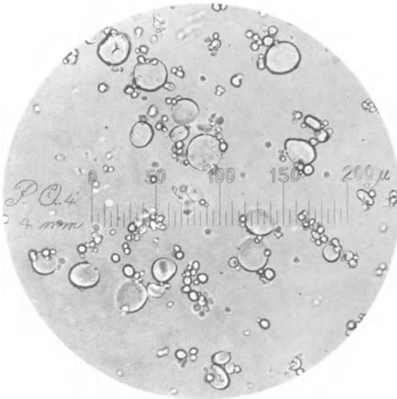
Abb. 126. Weizenstärke aus einem mit Mehl gefüllten alchinesischen Papier. Plaggesches Okularmikrometer. Vergr. 250.
