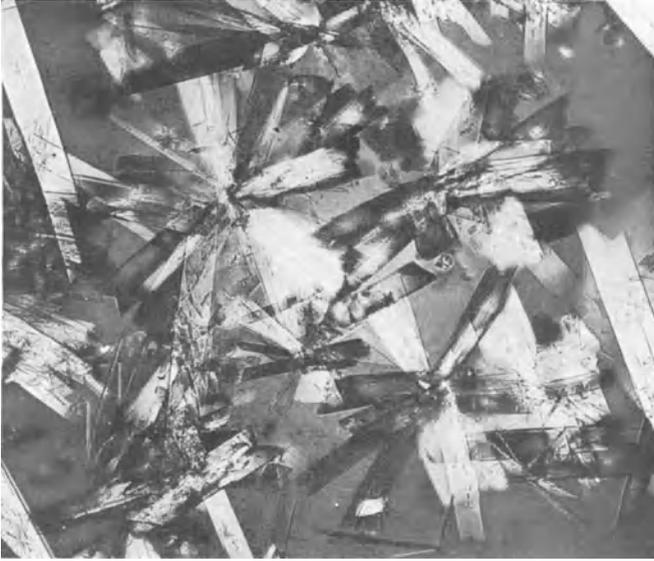
Abb. 57. Zinkvalerat. Polarisiertes Licht: Nicols gekreuzt, Gipsplatte Rot I. Vergr. 100.
