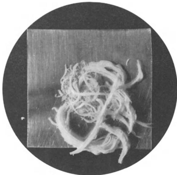
Abb. 217. Ausblühungen von „Fasertonerde“ auf einem mit wässriger Sublimatlösung betupften Aluminiumblech. Vergr. 3.
