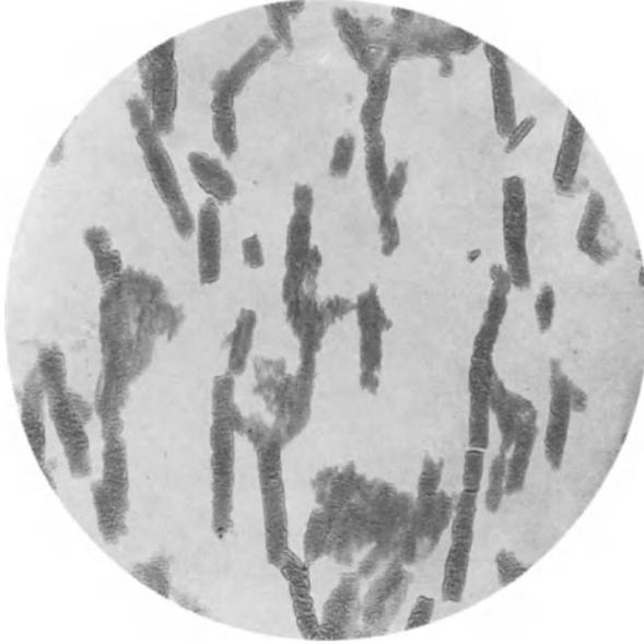
Abb. 181. Kalkseife. Flachzylindrische Stücke, in der Quere zerfallend. Vergr. 100.
