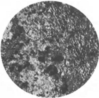
Abb. 210. Metallisches Silber. Nach dem Verbrennen von Filterpapier, auf welchem die Tüpfelprobe mit Hydroxylamin und Natronlauge zum Nachweis von Silber ausgeführt wurde, längere Zeit auf einer Glimmerplatte ge-
