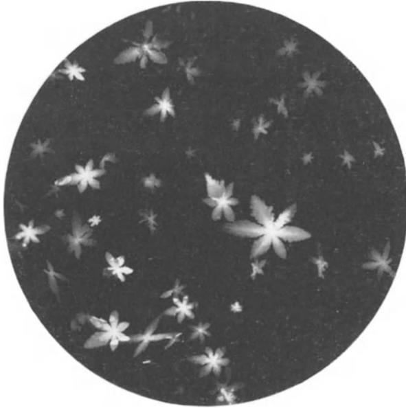
Abb. 29. Benzidinsulfat. Polarisiertes Licht: Nicols gekreuzt. Vergr. 120.
