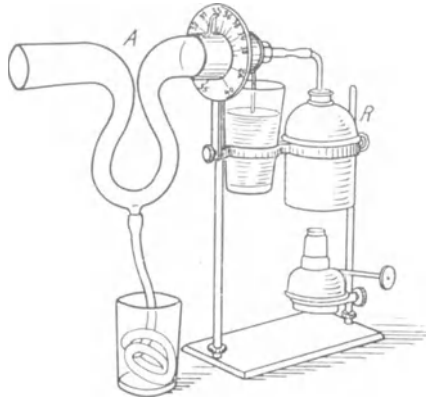
Abb. 16. HERYNG's Thermoregulator. (Das Lyrarohr A ist der Thermoakkumulator und dient zur Vergasung von Arzneidämpfen.)
