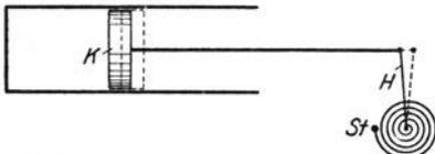
Abb. 2. Übertragung einer Arbeitseinheit von einem komprimierten Gas auf das Arbeitsfilter.
