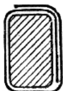
Фиг. 30. Изолировка с перекрытием на \frac{1}{2}
