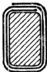
Фиг. 29. Изолировка с перекрытием на 2\frac{1}{4}
