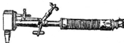
Фиг. 4. Паяльник, нагреваемый бензиновой горелкой.
